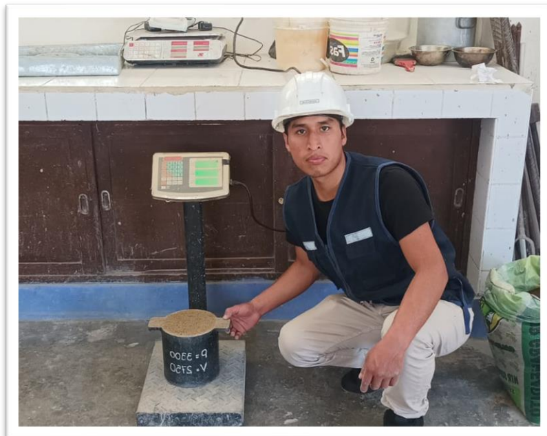
Ensayo de Peso Unitarios del Agregado Fino
