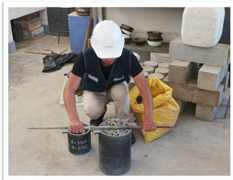
Ensayo de Peso Unitarios suelto del Agregado Grueso
