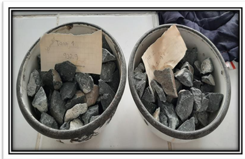
Ensayo de Contenido de Humedad del Agregado Fino y Agregado Grueso
