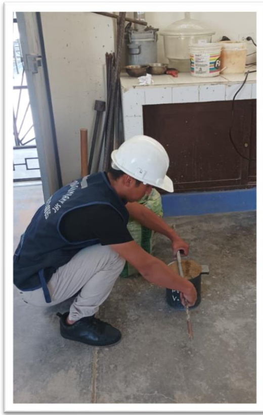
Ensayo de Peso Unitarios del Agregado Fino
