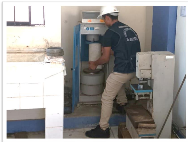
Ensayo de la compresión a los 7 días de la probeta patrón
