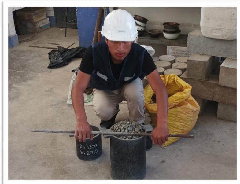
Ensayo de Peso Unitarios compactado del Agregado Grueso
