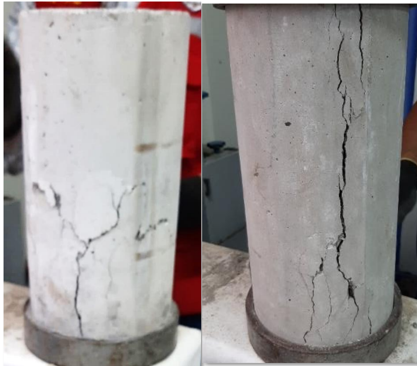
Figura 10: fracturación de los especímenes de concreto después de haber sido ensayados
