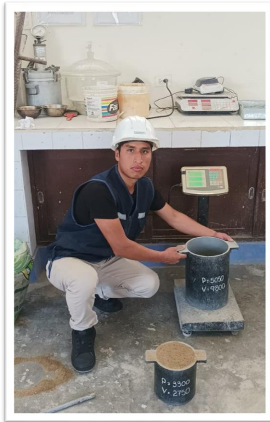
Ensayo de Peso Unitarios suelto del Agregado Grueso
