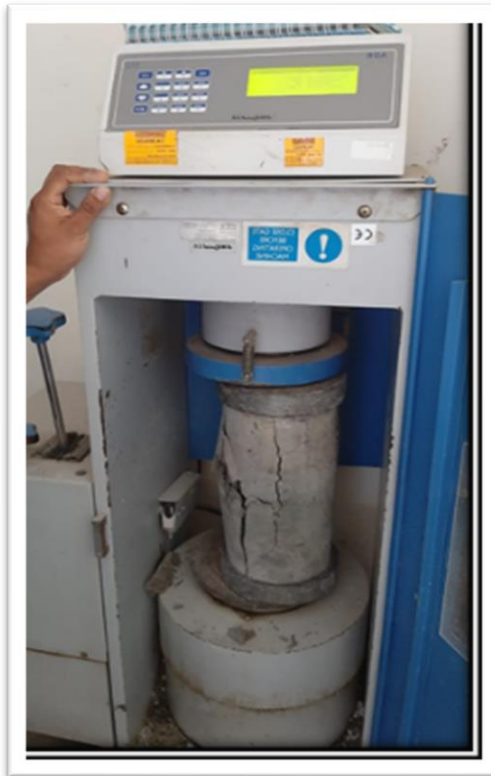
Ensayo de la compresión a los 7 días de la probeta patrón
