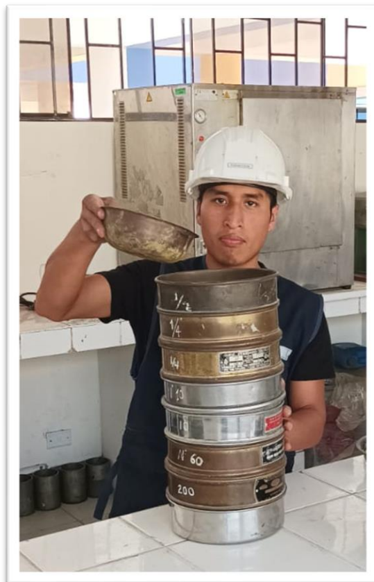
Ensayo de Granulométrico del Agregado Fino y Agregado Grueso
