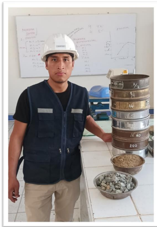
Ensayo de Granulométrico del Agregado Fino y Agregado Grueso
