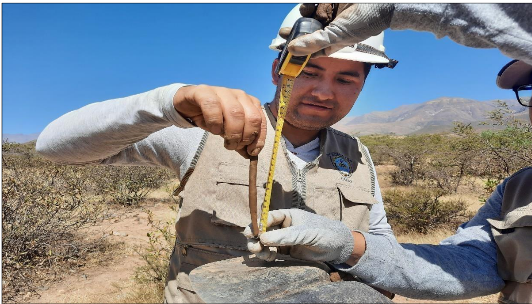
Fotografía N° 04.- Medida de la prueba de cinta de barro, midió entre 12 cm. A 16 cm.
