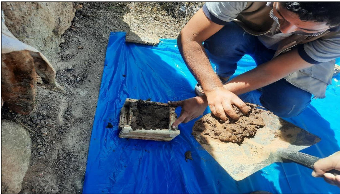
Fotografía N° 16.- Elaboración de adobes de 0.10 m. x 0.10 m. x 0.10 m.
