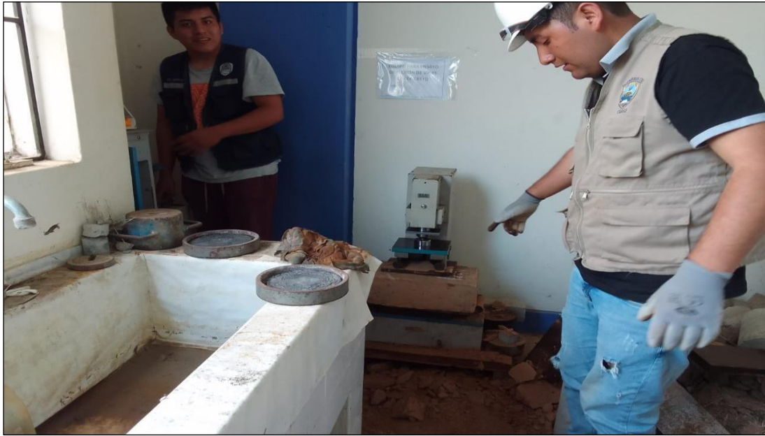
Fotografía N° 23.- En la imagen se aprecia la rotura de adobe en cuanto a la compresión.
