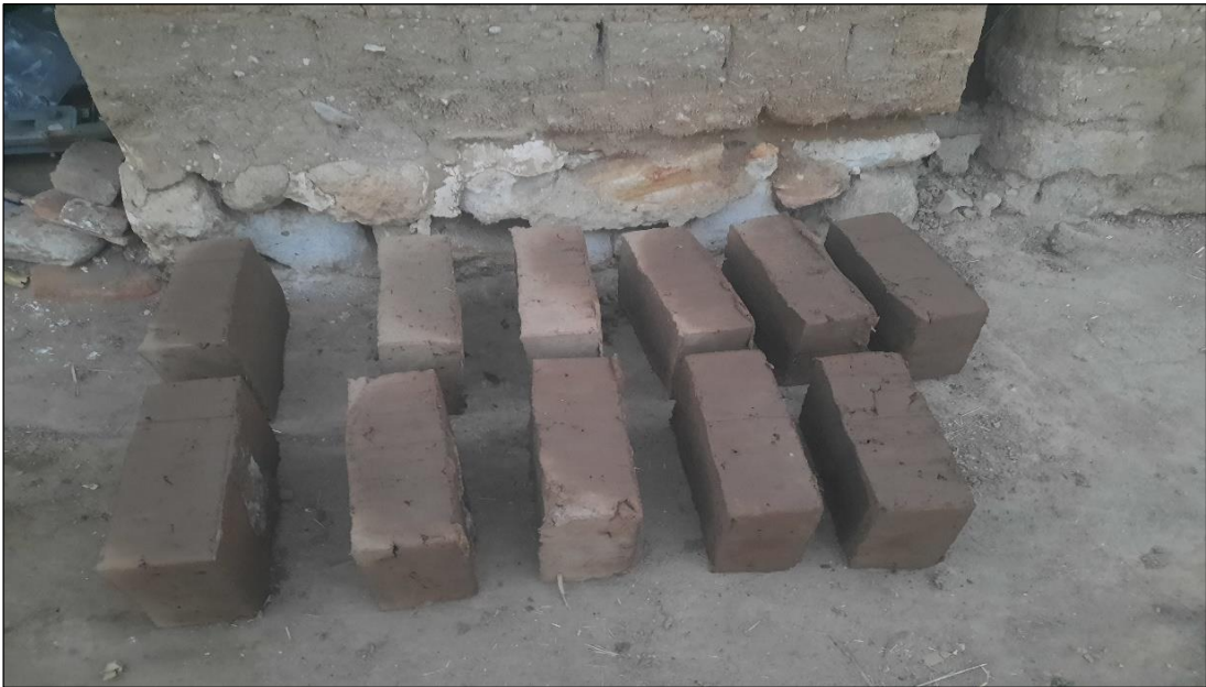
Fotografía N° 20.- Adobe puesto de canto luego de 6 días desde su elaboración.
