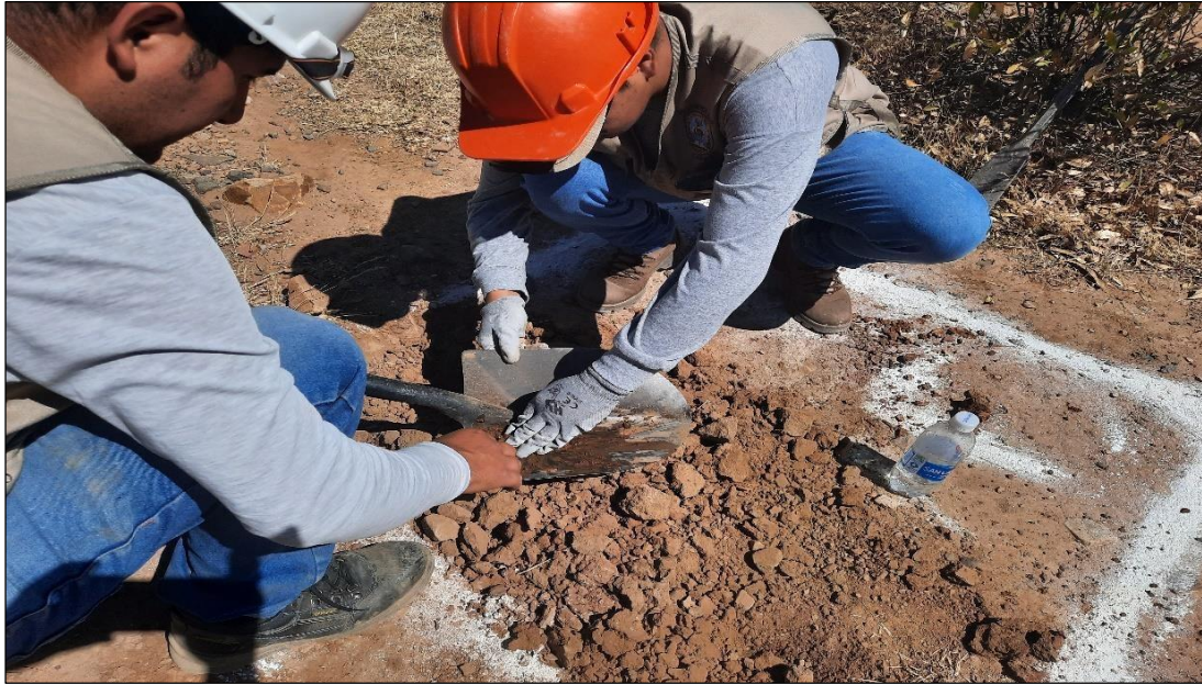
Fotografía N° 03.- En la imagen se observa en ensayo de la prueba de campo, para la resistencia seca y prueba a cinta
