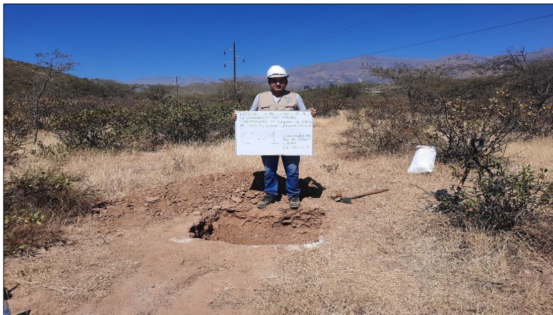
Fotografía N° 02.- Excavación de la calicata para su posterior traslado de muestra al laboratorio de mecánica de suelos USP- Chimbote.
