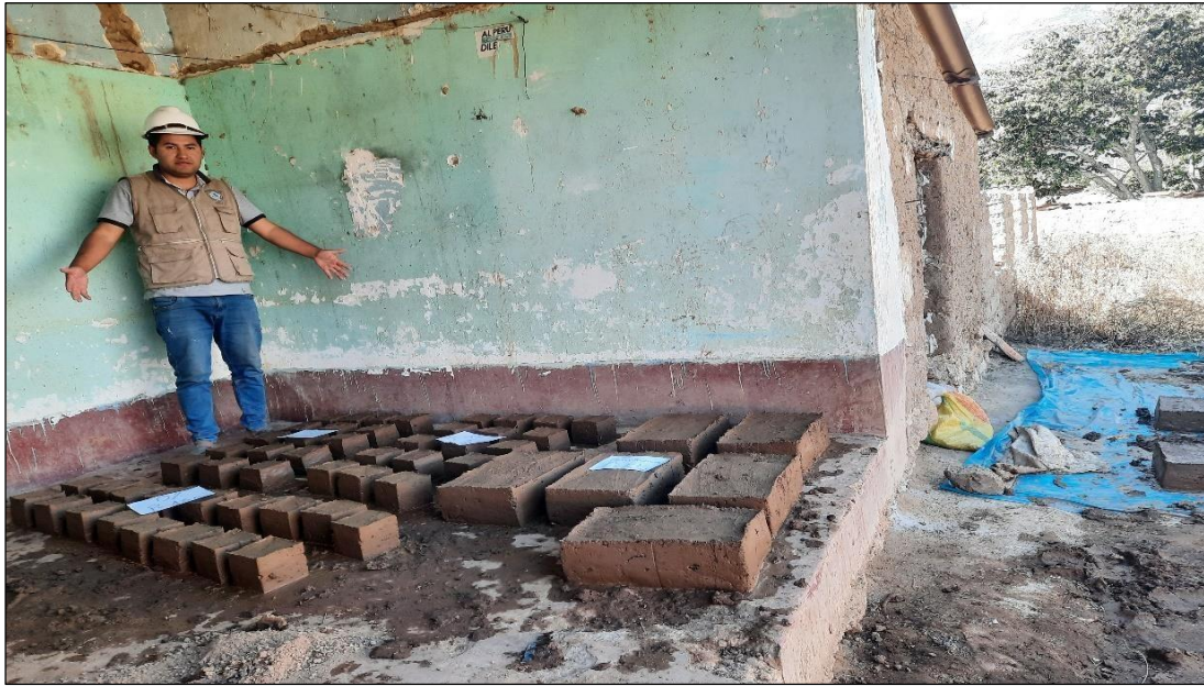
Fotografía N° 19.- Rotulación de adobes con respecto a su porcentaje de tratamiento.
