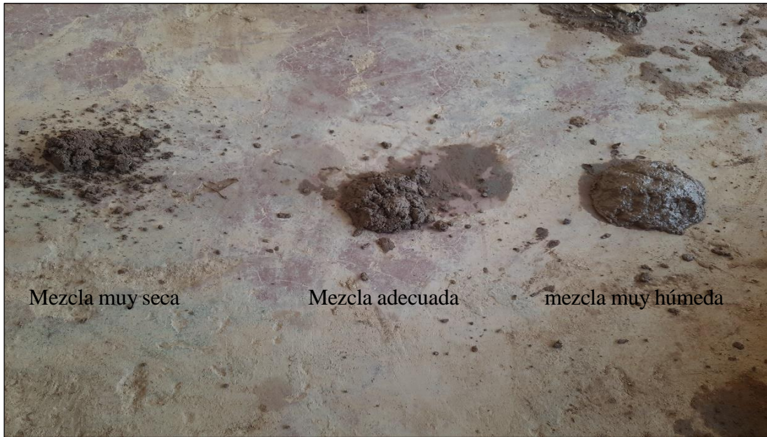
Fotografía N° 15.- Prueba de ensayo de puñado, para saber la humedad adecuada para elaboración de unidades de adobe.
