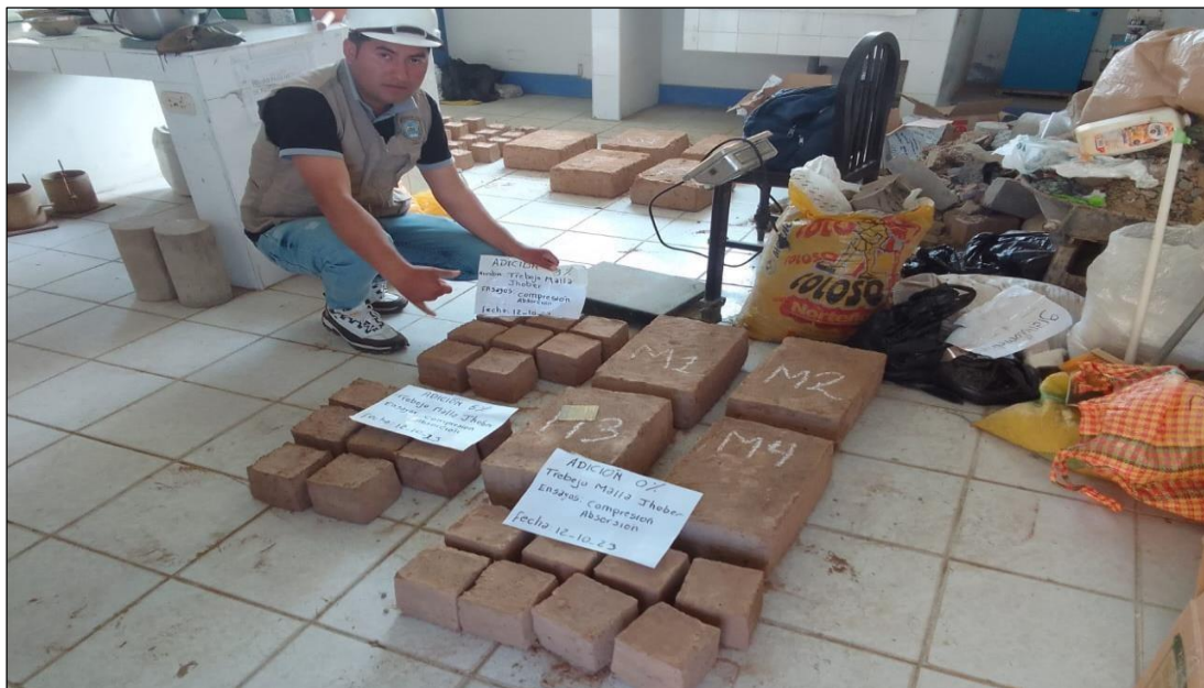
Fotografía N° 22.- En la imagen vemos las muestras de los adobes rotuladas, para su posterior ensayo del laboratorio.
