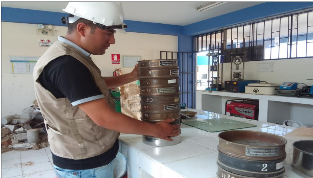
Fotografía N° 06.- Tamizado del suelo para analizar su distribución granular.
