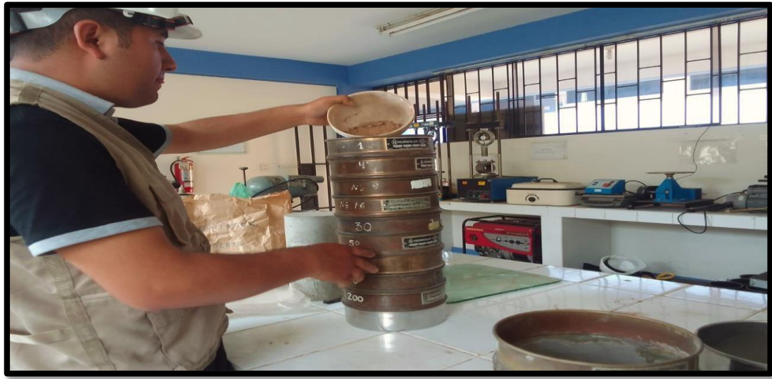
Figura 13. Ensayo granulométrico por tamizado.
