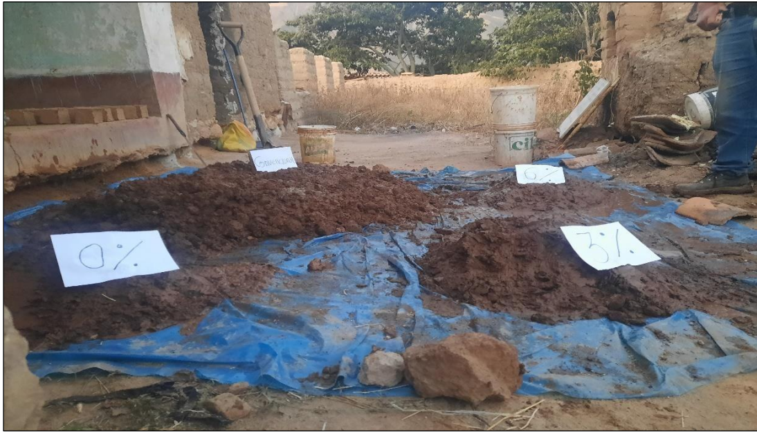
Fotografía N° 13.- Se aprecia el mezclado homogéneo de barro
