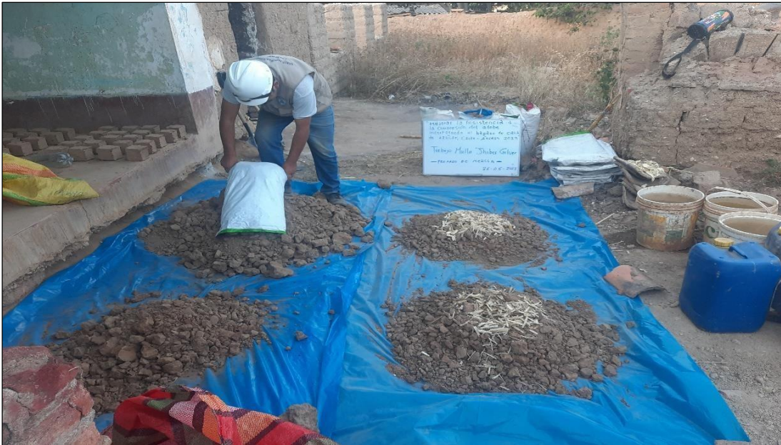
Fotografía N° 10.- En la imagen se aprecia adición del bagazo de caña de azúcar para los tres tratamientos de 0%, 3% y 6%.
