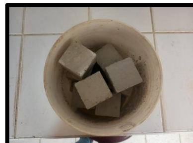
Figura 154 Curado de Morteros Experimentales a 7 días
