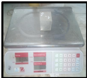
Figura 103 Pesado Mortero Patrón P1 - 7 = 305.00 \text{ gr}
