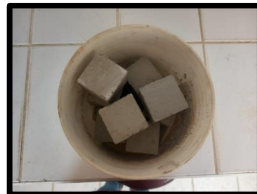
Figura 60 Curado de Morteros Experimentales a 3 días
