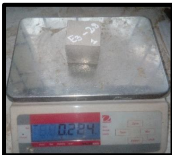
Figura 213 Pesado Mortero Experimental E3_{(1)} - 28 = 284.00 \text{ gr}
