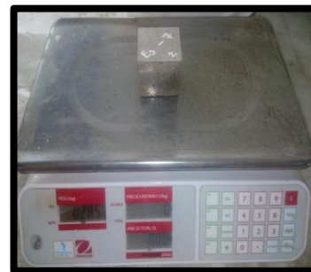
Figura 152 Pesado Mortero Experimental E3_{(2)} - 7 = 285.00 \text{ gr}
