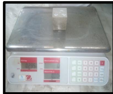
Figura 120 Pesado Mortero Experimental E1_{(2)} - 7 = 285.00 \text{ gr}
