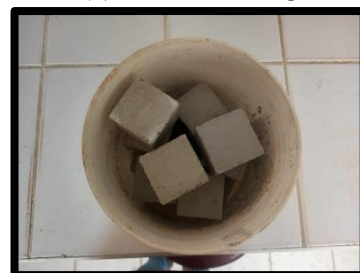
Figura 138 Curado de Morteros Experimentales a 7 días
