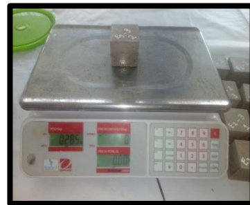
Figura 90 Pesado Mortero Experimental E3_{(2)} - 3 = 285.00 \text{ gr}
