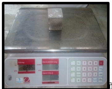
Figura 153 Pesado Mortero Experimental E3_{(1)} - 7 = 285.00 \text{ gr}
