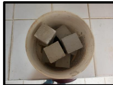
Figura 92 Curado de Morteros Experimentales a 3 días
