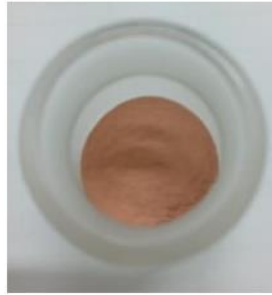
FIGURA N°1. Muestra de Arcilla a 550 °C por 30 minutos.
