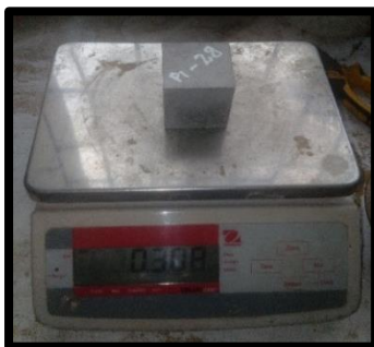
Figura 165 Pesado Mortero Patrón P1 - 28 = 308.00 \text{ gr}
