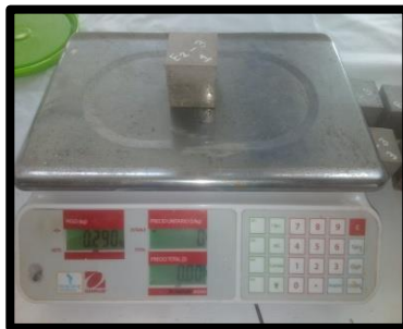
Figura 73 Pesado Mortero Experimental E2_{(1)} - 3 = 290.00 \text{ gr}
