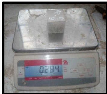
Figura 183 Pesado Mortero Experimental E1_{(1)} - 28 = 284.00 \text{ gr}
