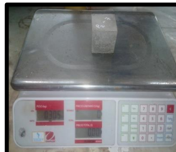
Figura 104 Pesado Mortero Patrón P2 - 7 = 305.00 \text{ gr}
