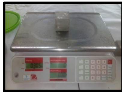
Figura 42 Pesado Mortero Patrón P2 - 3 = 305.00 \text{ gr}
