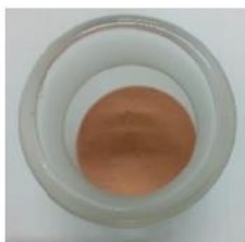
FIGURA N°1. Muestra de Arcilla a 550 °C por 90 minutos.
