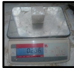
Figura 198 Pesado Mortero Experimental E2_{(2)} - 28 = 286.00 \text{ gr}
