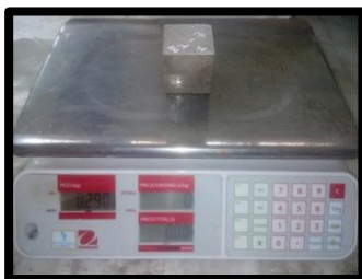
Figura 135 Pesado Mortero Experimental E2_{(1)} - 7 = 290.00 \text{ gr}
