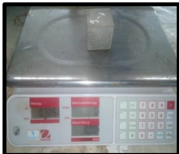
Figura 105 Pesado Mortero Patrón P3 - 7 = 305.00 \text{ gr}
