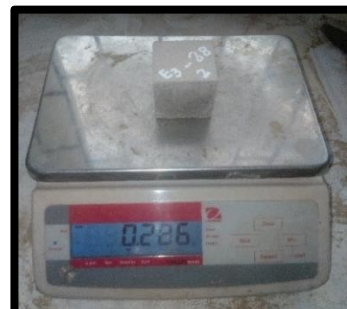
Figura 214 Pesado Mortero Experimental E3_{(2)} - 28 = 286.00 \text{ gr}
