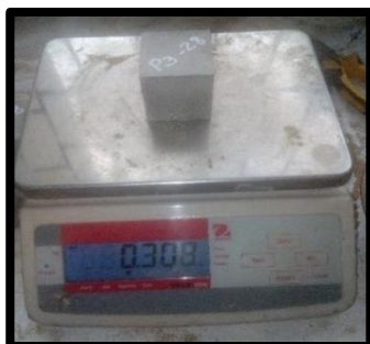
Figura 167 Pesado Mortero Patrón P3 - 28 = 308.00 \text{ gr}
