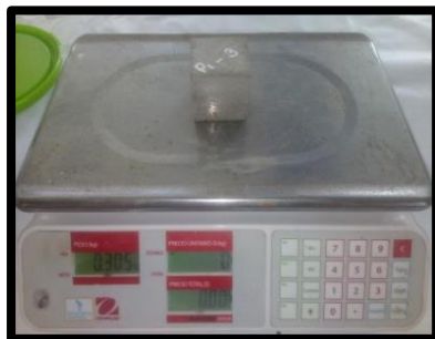
Figura 41 Pesado Mortero Patrón P1 - 3 = 305.00 \text{ gr}
