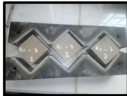
Figura 118 Enmarcado de los morteros
