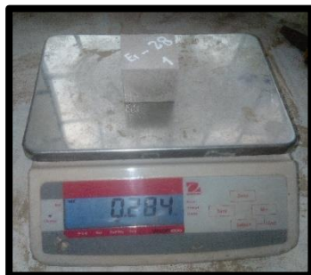
Figura 181 Pesado Mortero Experimental E1_{(1)} - 28 = 284.00 \text{ gr}
