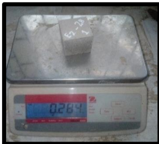
Figura 197 Pesado Mortero Experimental E2_{(1)} - 28 = 284.00 \text{ gr}
