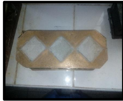
Figura 162 Mortero encofrado después de 1 día
