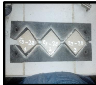
Figura 212 Enmarcado de los morteros
