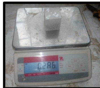
Figura 182 Pesado Mortero Experimental E1_{(2)} - 28 = 286.00 \text{ gr}
