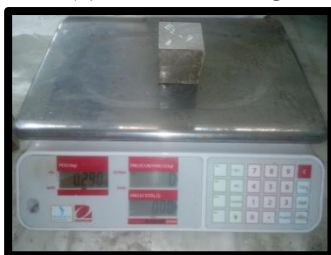
Figura 137 Pesado Mortero Experimental E2_{(1)} - 7 = 290.00 \text{ gr}
