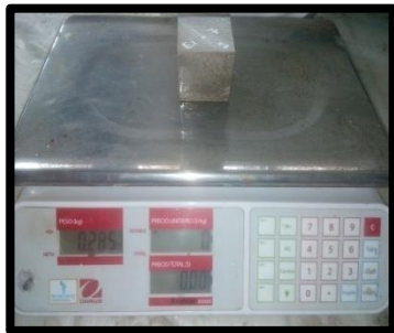
Figura 119 Pesado Mortero Experimental E1_{(1)} - 7 = 285.00 \text{ gr}
