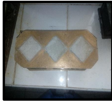
Figura 100 Mortero encofrado después de 1 día
