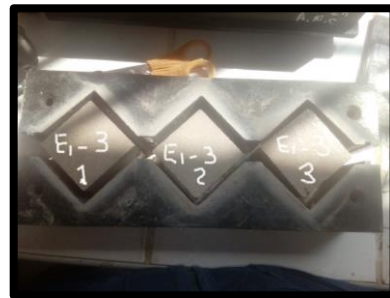
Figura 56 Enmarcado de los morteros
