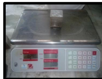
Figura 136 Pesado Mortero Experimental E2_{(2)} - 7 = 290.00 \text{ gr}
