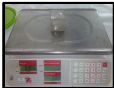
Figura 43 Pesado Mortero Patrón P3 - 3 = 305.00 \text{ gr}
