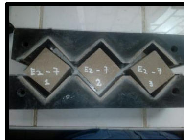
Figura 134 Enmarcado de los morteros
