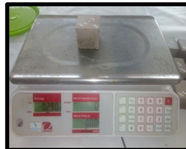
Figura 74 Pesado Mortero Experimental E2_{(2)} - 3 = 290.00 \text{ gr}
