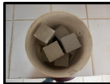
Figura 200 Curado de Morteros Experimentales a 28 días
