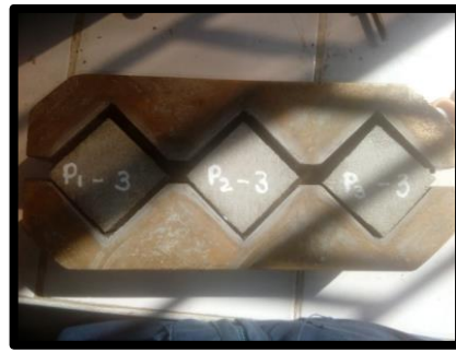
Figura 40 Enmarcado de los morteros
