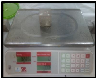
Figura 59 Pesado Mortero Experimental E1_{(1)} - 3 = 285.00 \text{ gr}
