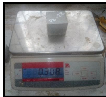
Figura 166 Pesado Mortero Patrón P2 - 28 = 308.00 \text{ gr}
