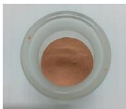
FIGURA N°1. Muestra de Arcilla a 550 °C por 60 minutos.
