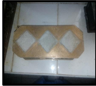
Figura 38 Mortero encofrado después de 1 día
