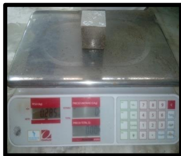
Figura 151 Pesado Mortero Experimental E3_{(1)} - 7 = 285.00 \text{ gr}
