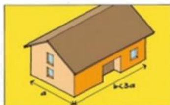
Figura 9: Vulnerabilidad Baja - Irregularidad en
