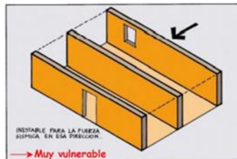
Figura 14: Cantidad de muros en las dos direcciones. Chavarría y Gómez (2001)
