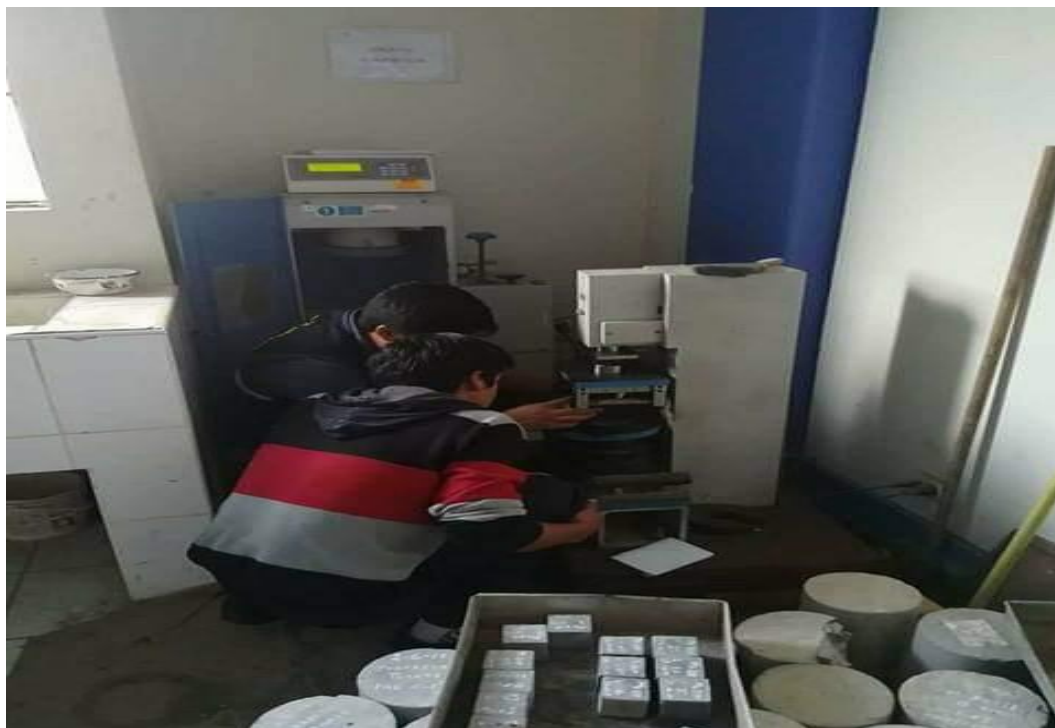
Figura 17: ensayo a la compresión a los 7 días
