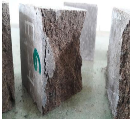
Fotografía N° 16. Rotura a la resistencia a la compresión de morteros
