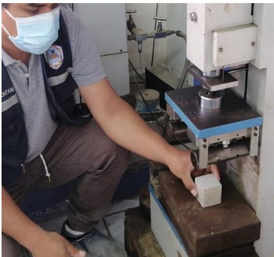
Fotografía N° 16. Rotura a la resistencia a la compresión de morteros
