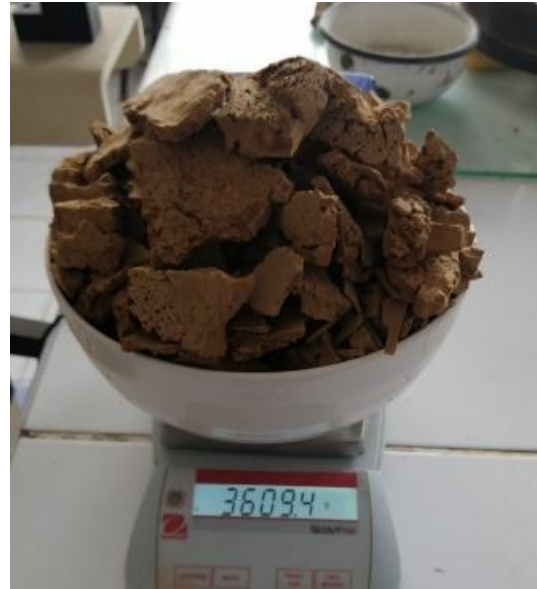
Fotografía N° 05. Calcinación de arcilla
