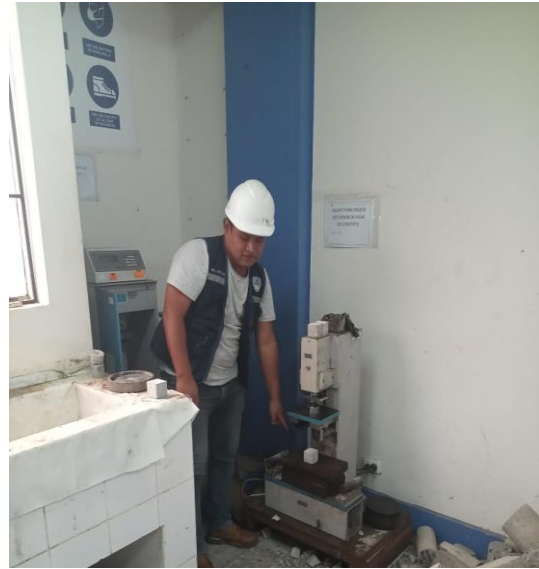
Fotografía N° 15. Rotura a la resistencia a la compresión de morteros
