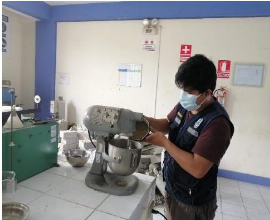
Fotografía N° 13. Elaboración de espécimen de mortero.
