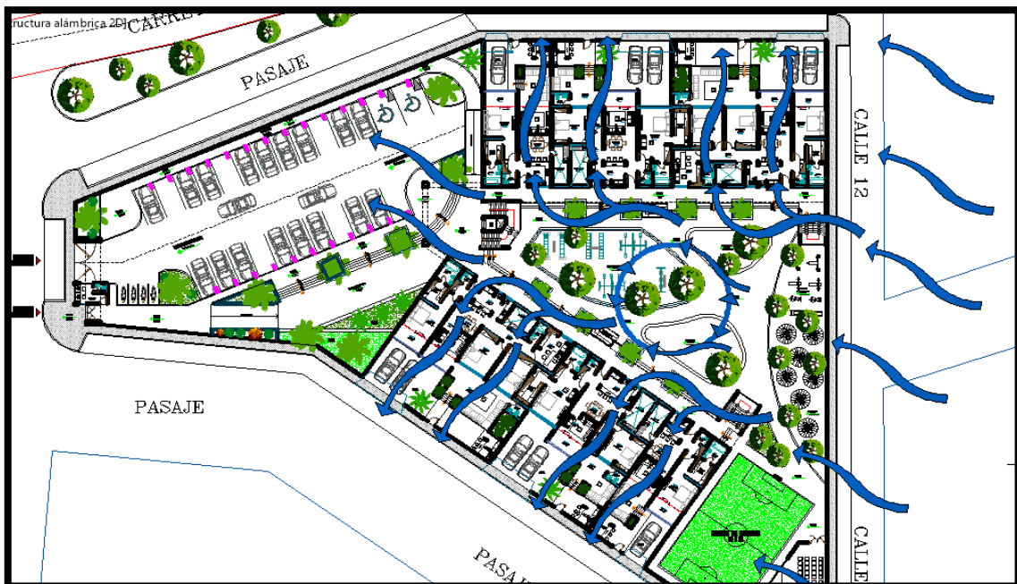
Figura N°47: evacuación del viento sobre las viviendas del módulo residencial. Fuente: Elaboración propia.
