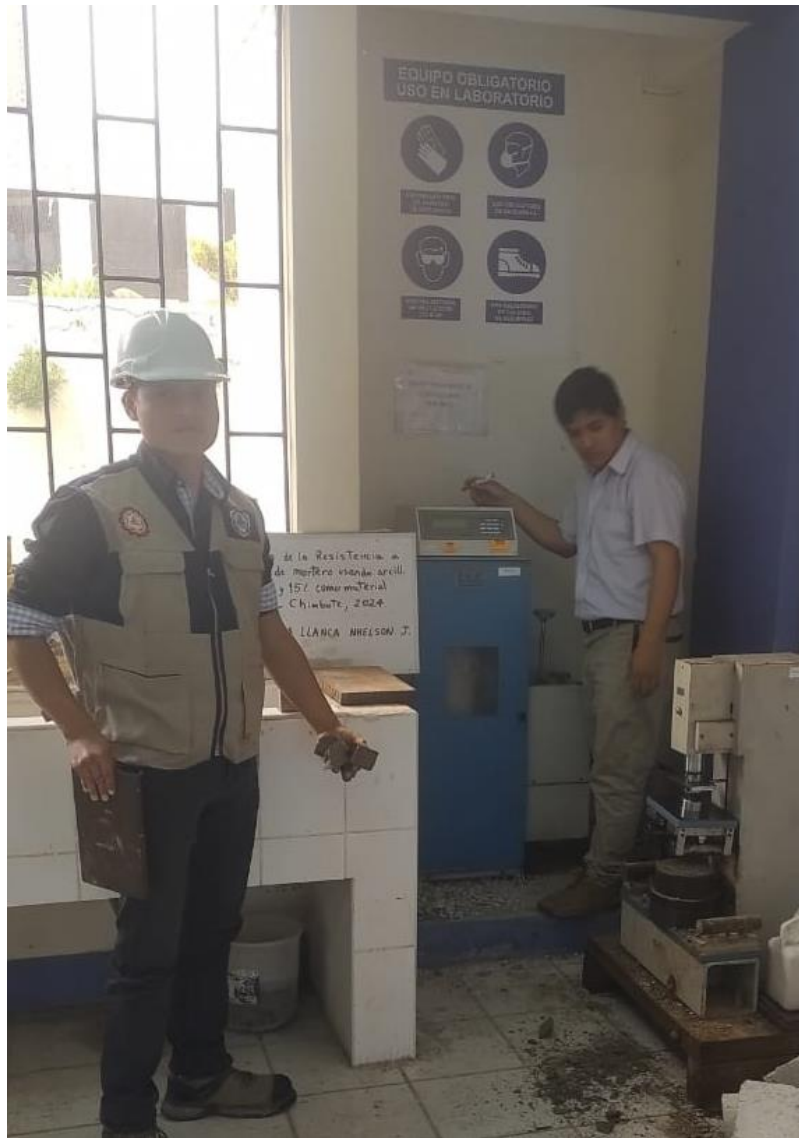
Ensayo de compresión de cubos de mortero en prensa hidráulica
