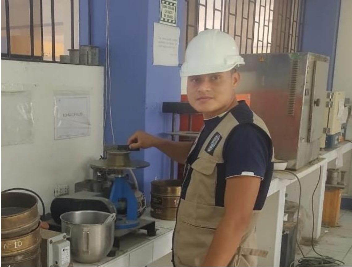
Enrasado de mortero en molde cónico de bronce, antes de los 25 golpes
