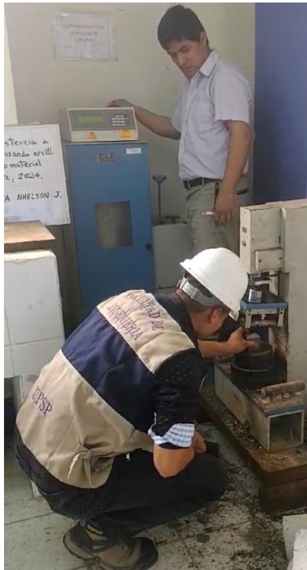
Ensayo de compresión de cubos de mortero
