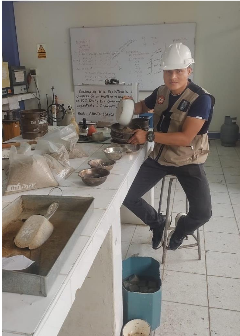
Gradación de la arena gruesa
