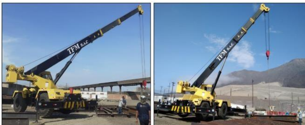
Grúa marca P&H-CENTURY 150 con capacidad de 50 toneladas
