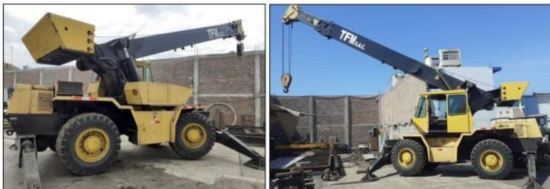
Grúa marca PH AJAX de capacidad 20 Toneladas
