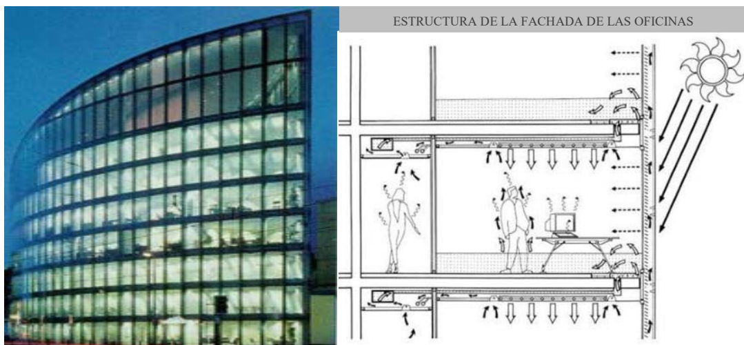
Figura 57: Sistemas estructurales para fachadas dobles. Fuente: Archdaily.com
