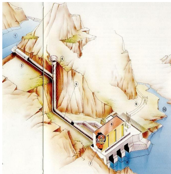
Figura 6. Central hidroeléctrica de bombeo Fuente: Elaboración propia
