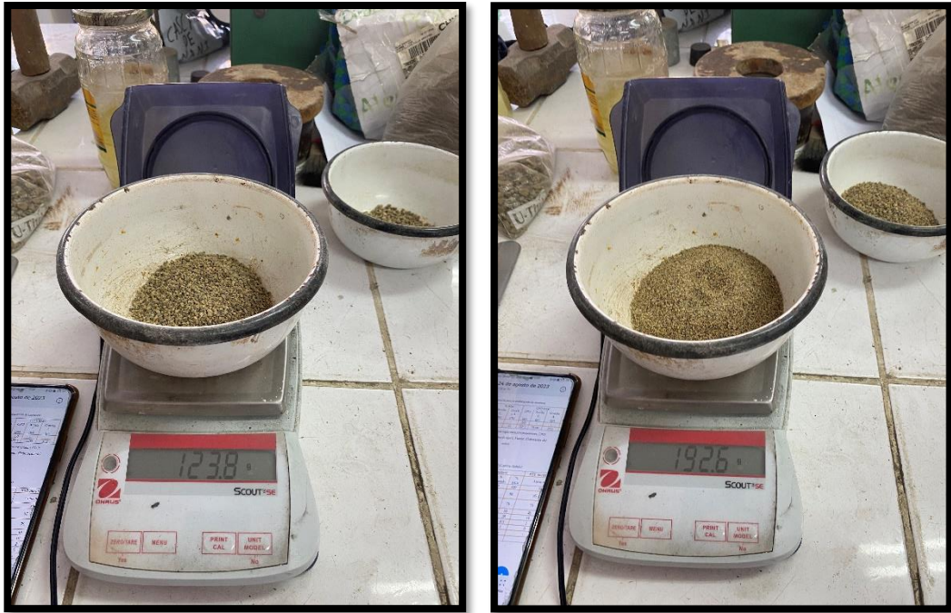
Figura 14. Pesos del agregado fino retenido en el tamiz 30 y 50.
