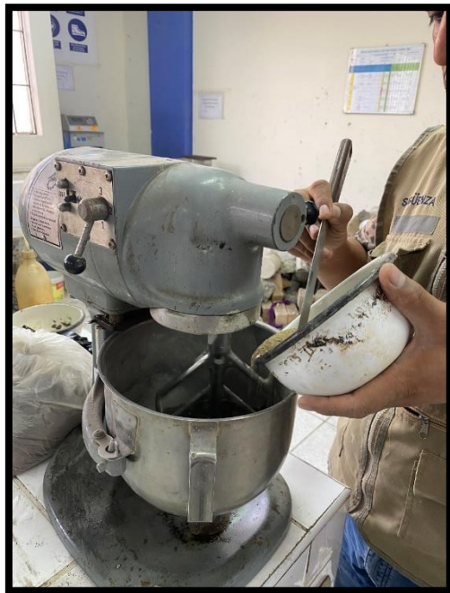
Figura 17 Elaboración de mortero patrón en batidora laboratorio USP
