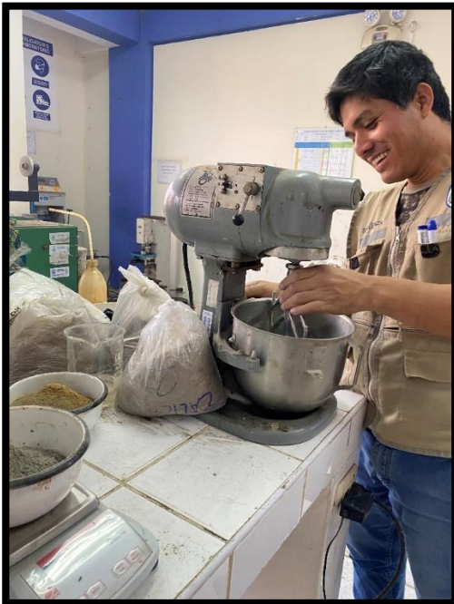
Figura 17 Elaboración de mortero patrón en batidora laboratorio USP
