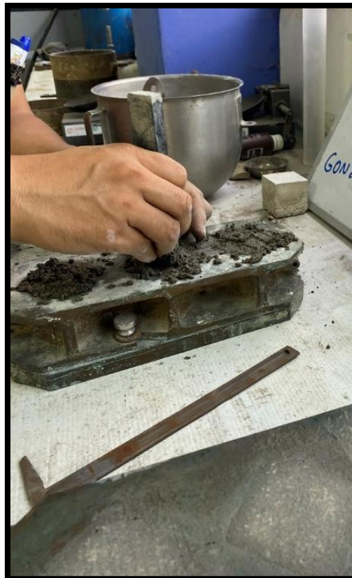
Figura 19. Molde para probetas de mortero de 5 x 5 cm.
