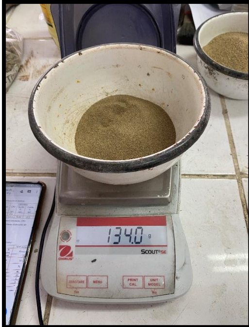
Figura 15. Pesos del agregado fino retenido en el tamiz 100 y 200.
