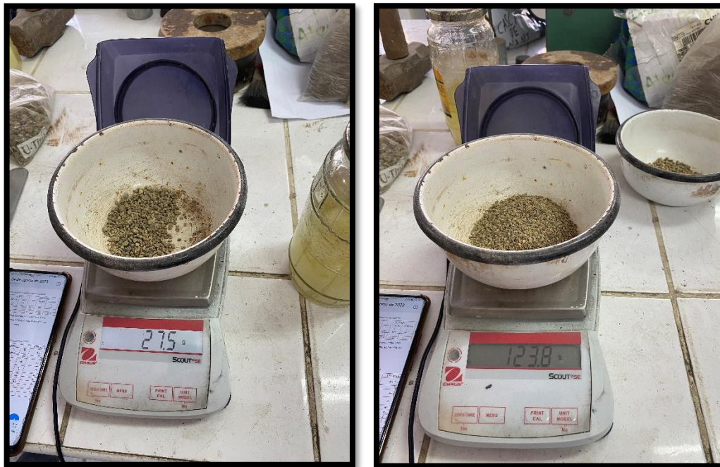
Figura 12. Gradación de la arena y listo para sus pesos.
