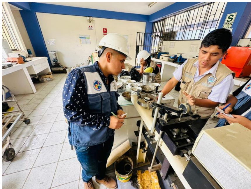
FOTO N°8: ANOTANDO VALORES EN EL ENSAYO DE CORTE DIRECTO
