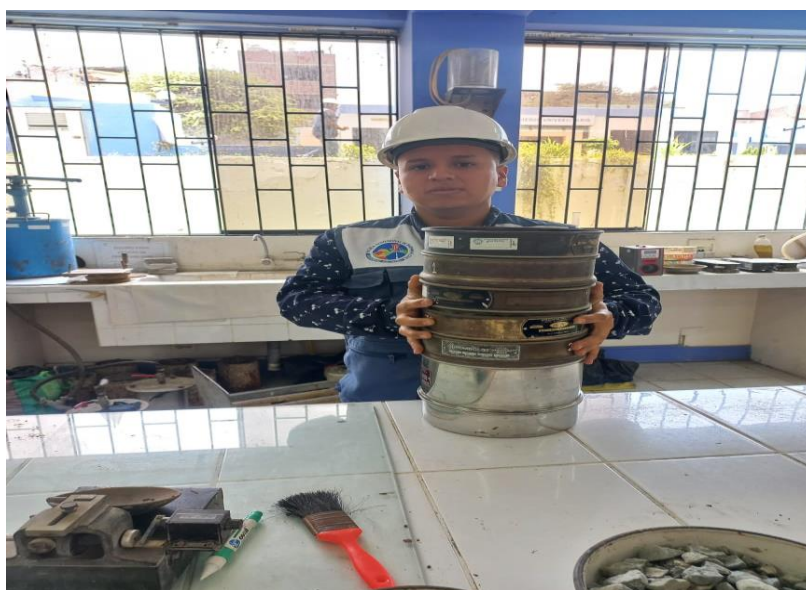
FOTO N°6: REALIZANDO ANALISIS GRANULOMETRICO POR TAMIZADO UNIVERSIDAD SAN PEDRO.
