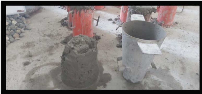
Fotografía 16 Slump del Concreto Patrón y Experimental
