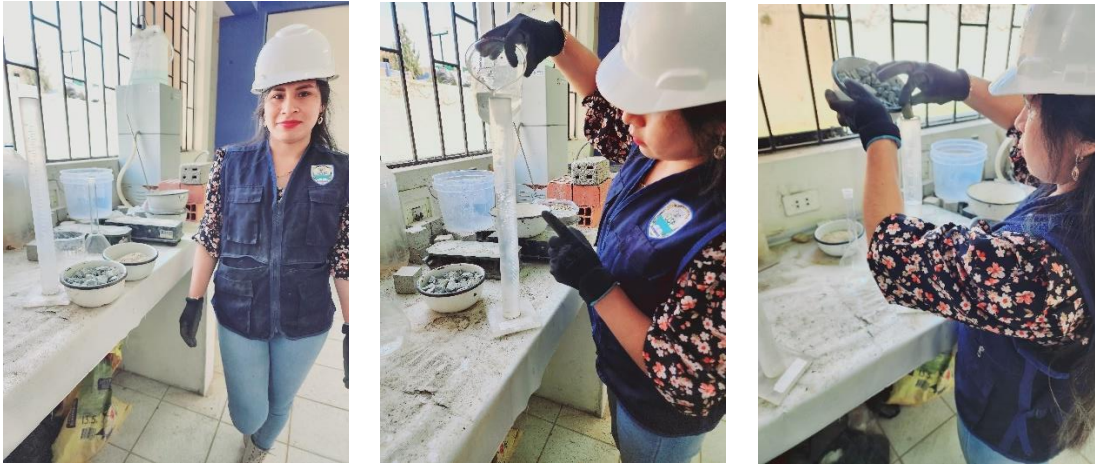
Imagen 17. Ensayo de peso específico y absorción del agregado grueso.
