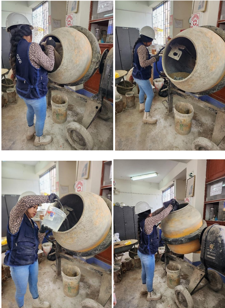
Imagen 24. El llenado de materiales para la mezcla de concreto.
