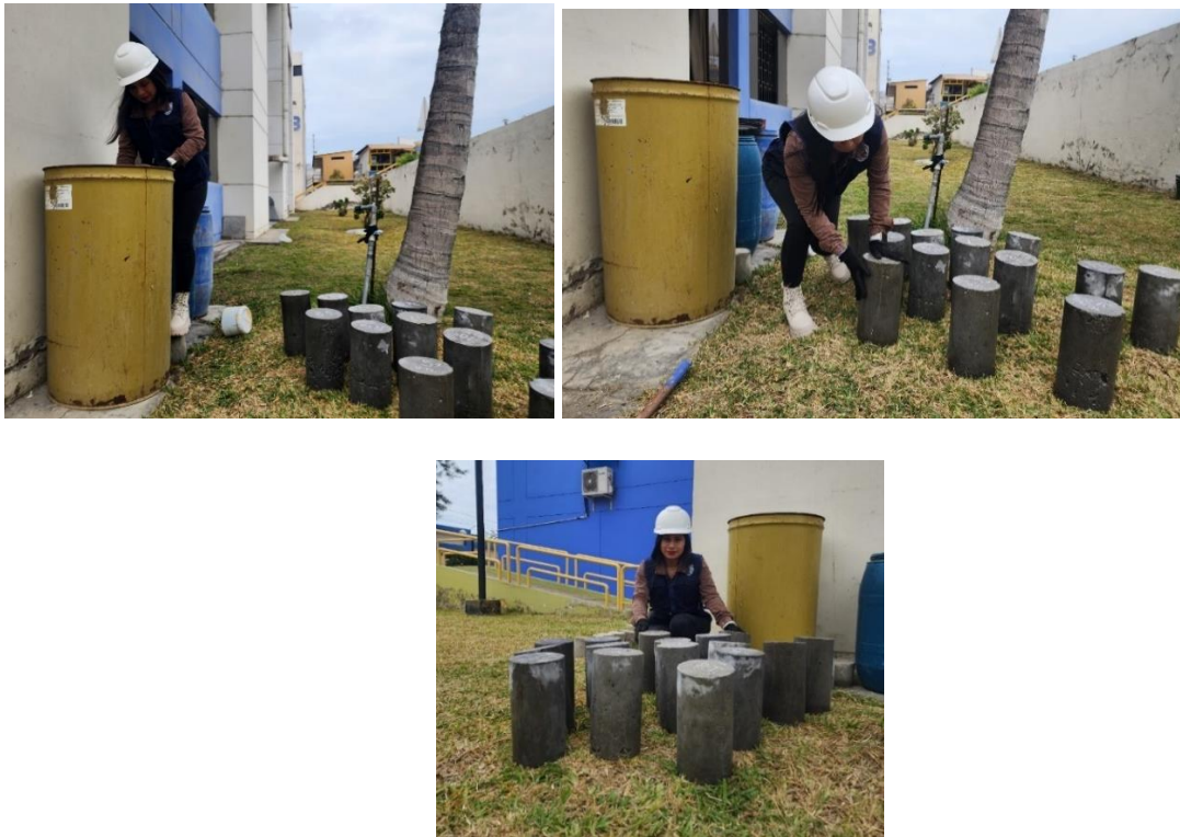
Imagen 33. Probetas expuestas al sol luego del curado para la resistencia a la compresión.
