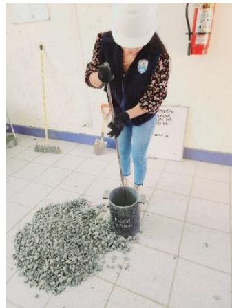
Imagen 15. Ensayo de peso unitario compactado del agregado grueso.
