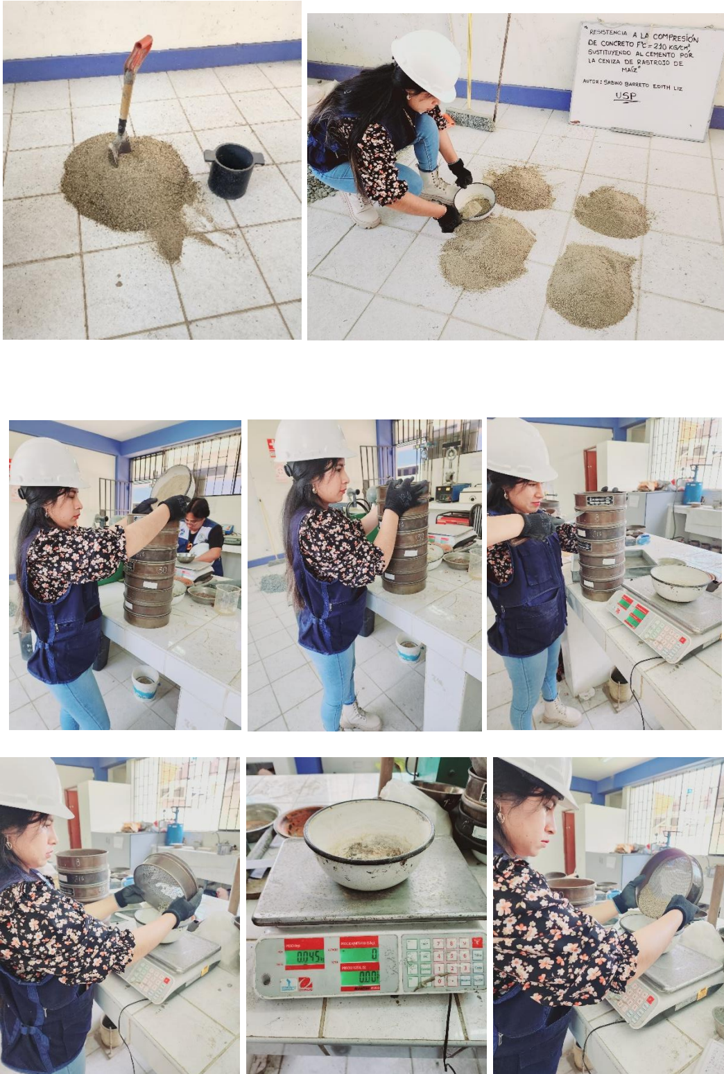
Imagen 09. Ensayo de Granulometría del agregado fino.
