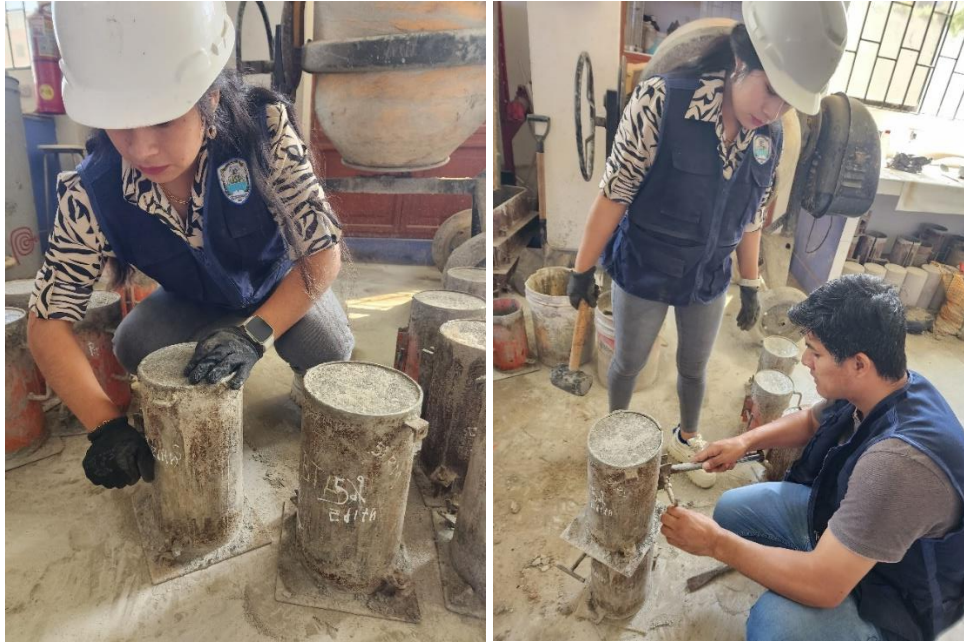
Imagen 30. El desencofrado de probetas experimentales a la sustitución del 5% de ceniza de rastrojo de maíz.
