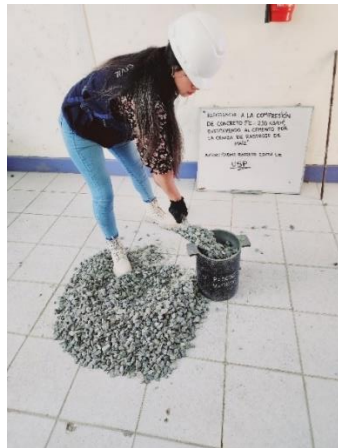
Imagen 15. Ensayo de peso unitario compactado del agregado grueso.
