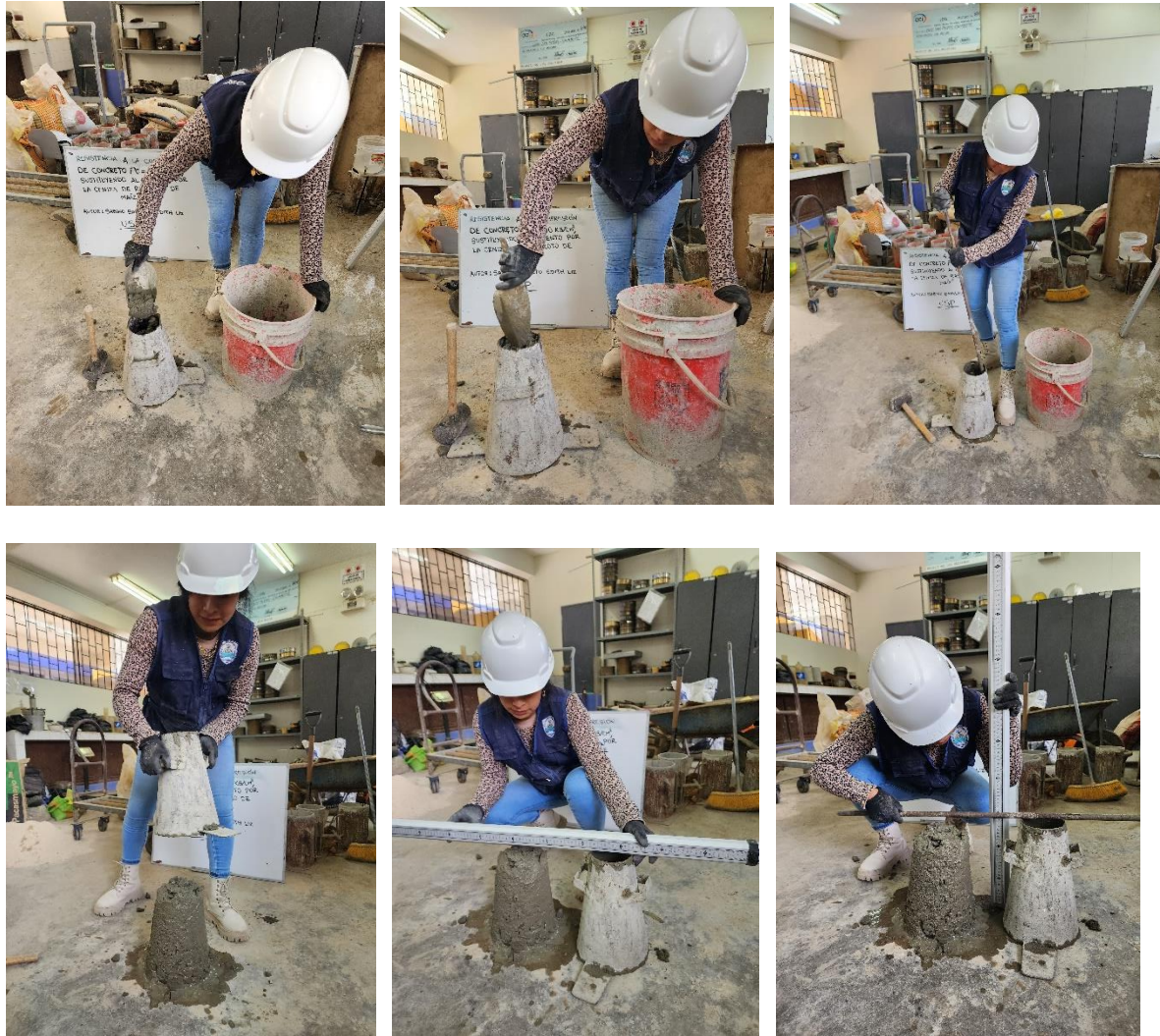
Imagen 22. Ensayo de asentamiento – Slump.
