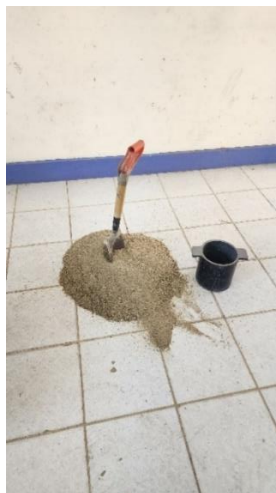
Imagen 14. Ensayo de peso unitario compactado del agregado fino.
