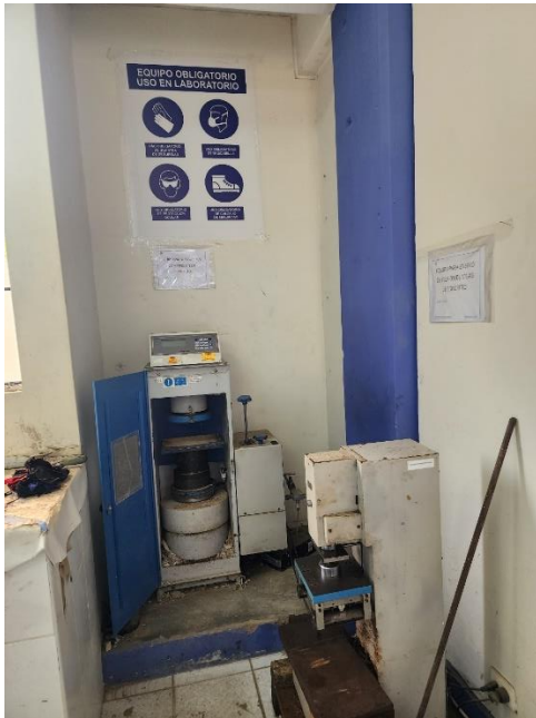
Imagen 35. Equipo para Ensayo de Compresión de Concreto.
