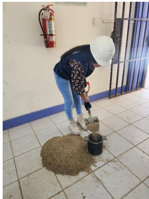
Imagen 12. Ensayo de peso unitario suelto del agregado fino.
