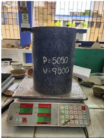
Imagen 13. Ensayo de peso unitario suelto del agregado grueso.
