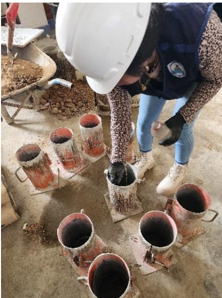
Imagen 23. Limpieza de las probetas con gasolina
