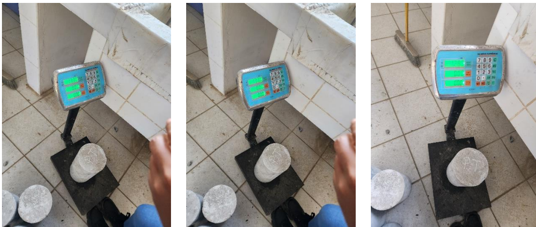
Imagen 34. El peso de las probetas de patrón y experimentales.
