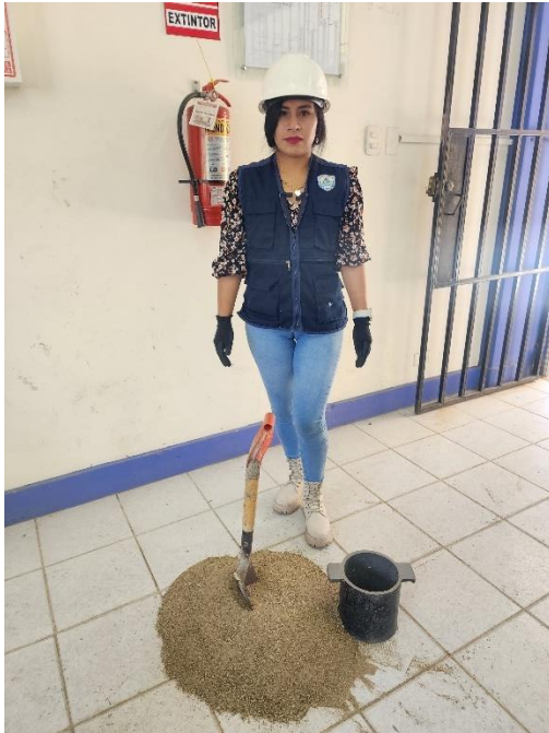
Imagen 12. Ensayo de peso unitario suelto del agregado fino.
