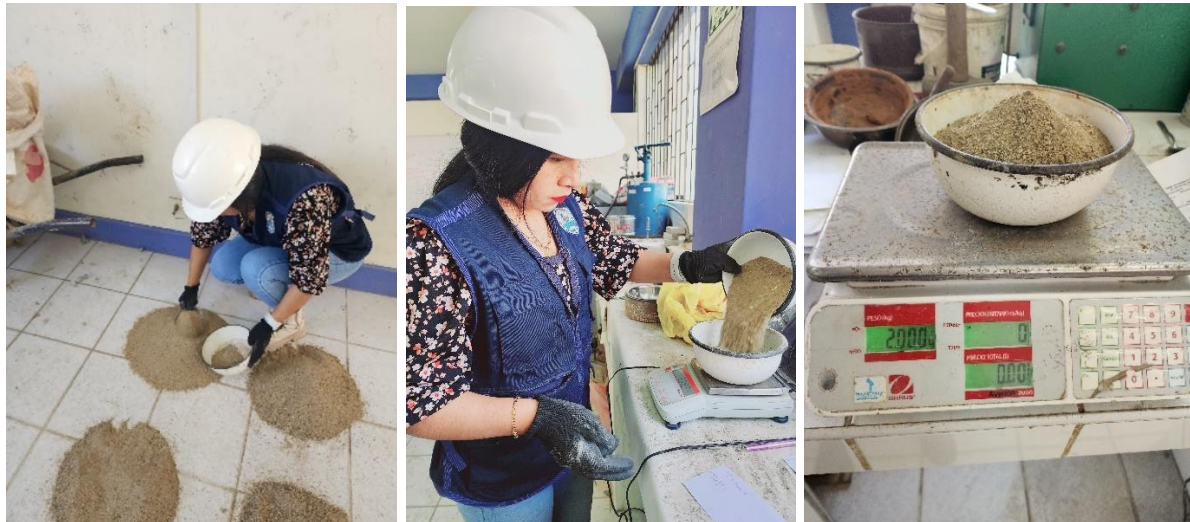
Imagen 11. Ensayo de contenido de humedad del agregado fino y grueso.
