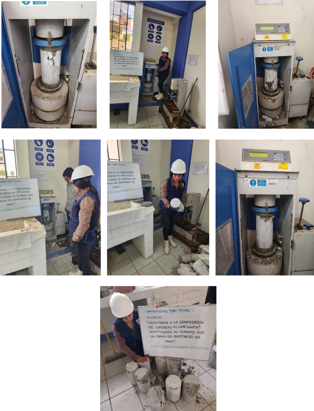
Imagen 36. Resistencia a la compresión a los 7 días de curado en patrón y experimentales.
