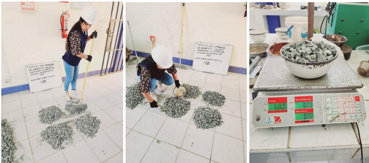
Imagen 10. Ensayo de Granulometría del agregado grueso.
