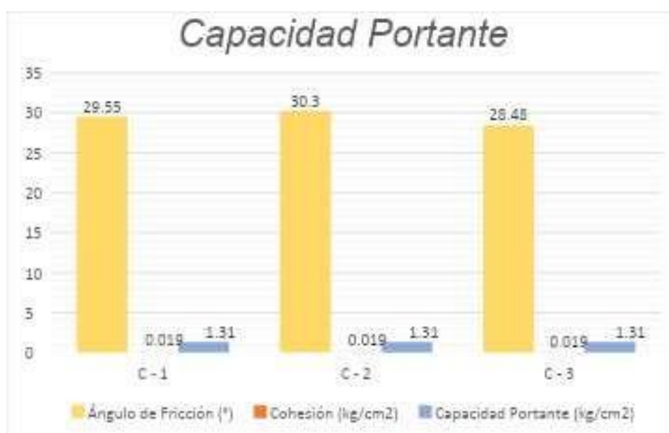
Figura 4. Análisis capacidad portante del suelo en el AA.HH. Los Cedros
