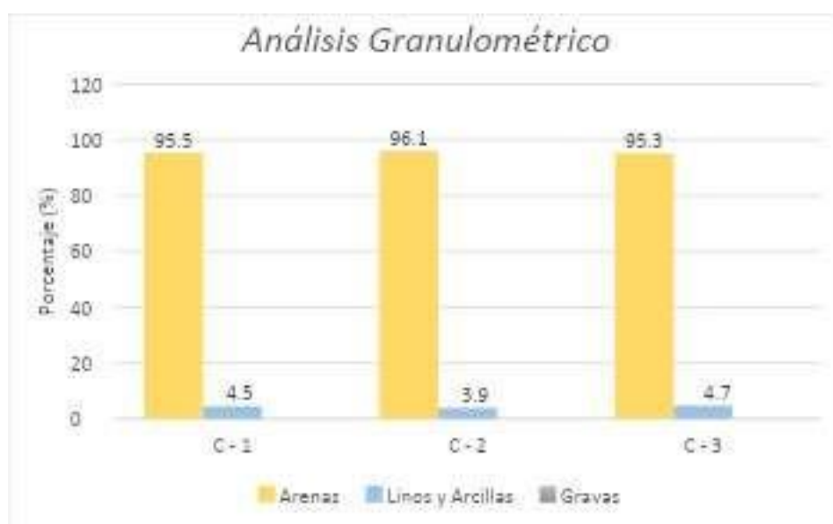
Figura 2. Análisis granulométrico del suelo en el AA.HH. Los Cedros
