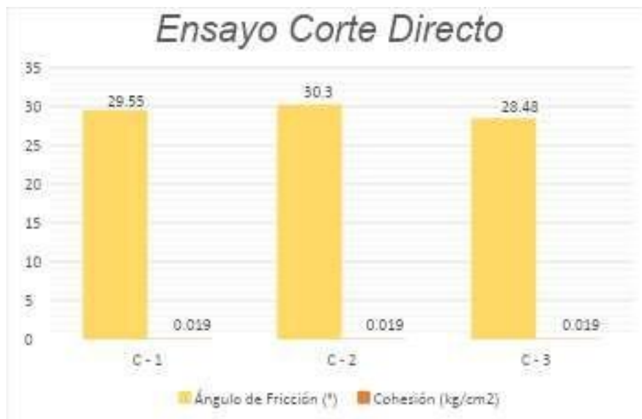
Figura 3. Análisis del ensayo de corte directo del AA.HH. Los Cedros
