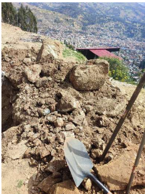
Fotografía N°03: Excavación y evaluación visual-manual de la Calicata C-01.
