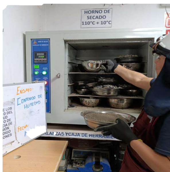
Fotografía N°26: Ensayo Contenido de Humedad de la Calicata C-02.
