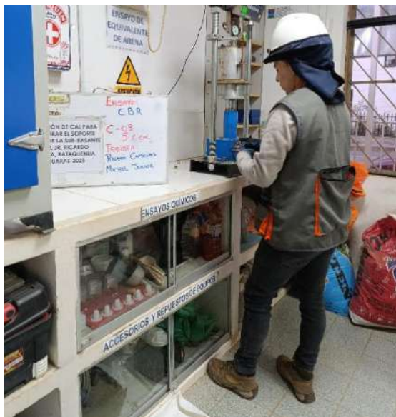
Fotografía N°51: Ensayo CBR 5% de CAL C-02.
