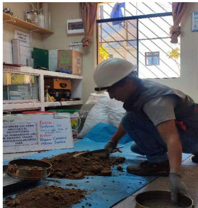
Fotografía N°16: Determinación del tamaño máximo nominal C-02.
