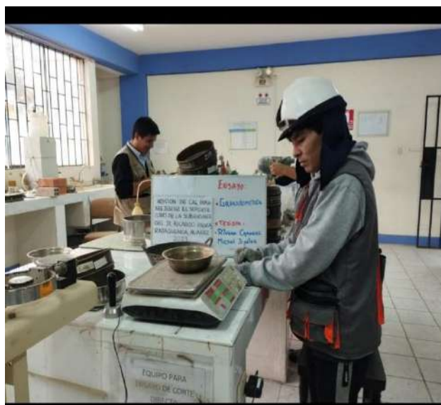
Fotografía N°18: Ensayo Análisis Granulométrico de la Calicata C-01.
