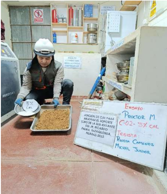
Fotografía N°39: Ensayo Proctor Modificado con el 5% de cal C-02.
