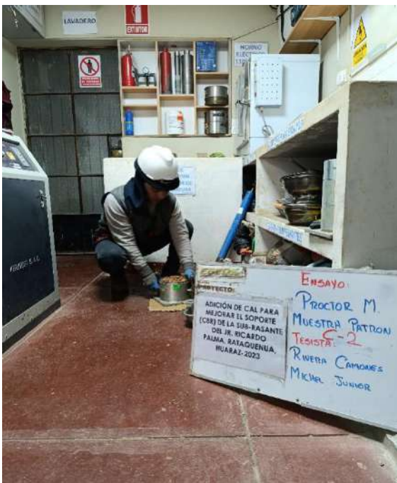
Fotografía N°33: Ensayo Proctor Modificado muestra patron Calicata C-02.
