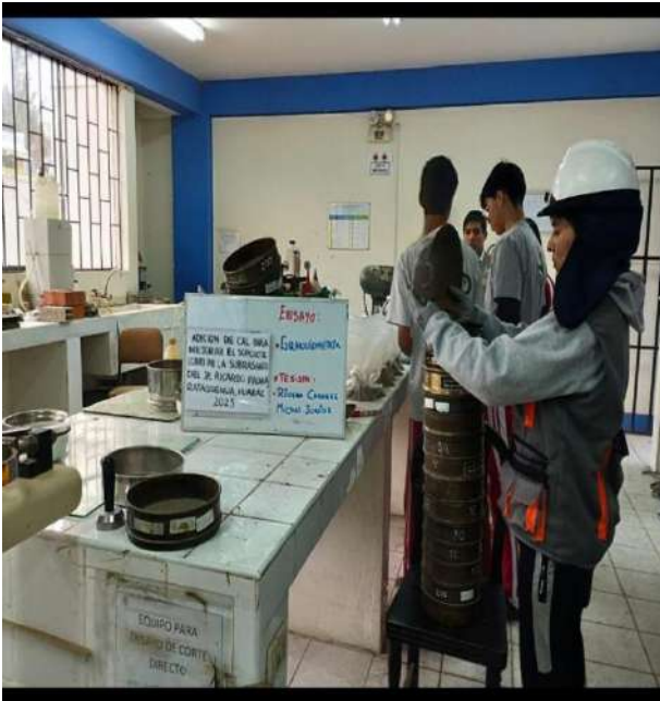
Fotografía N°19: Ensayo Análisis Granulométrico de la Calicata C-01.
