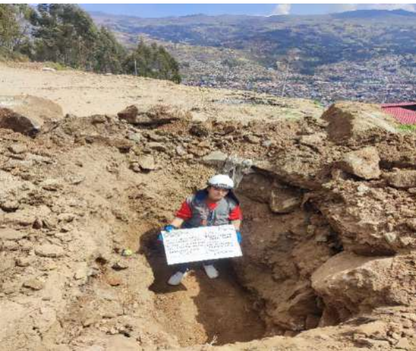
Fotografía N°09: Excavación y evaluación visual-manual de la Calicata C-02.
