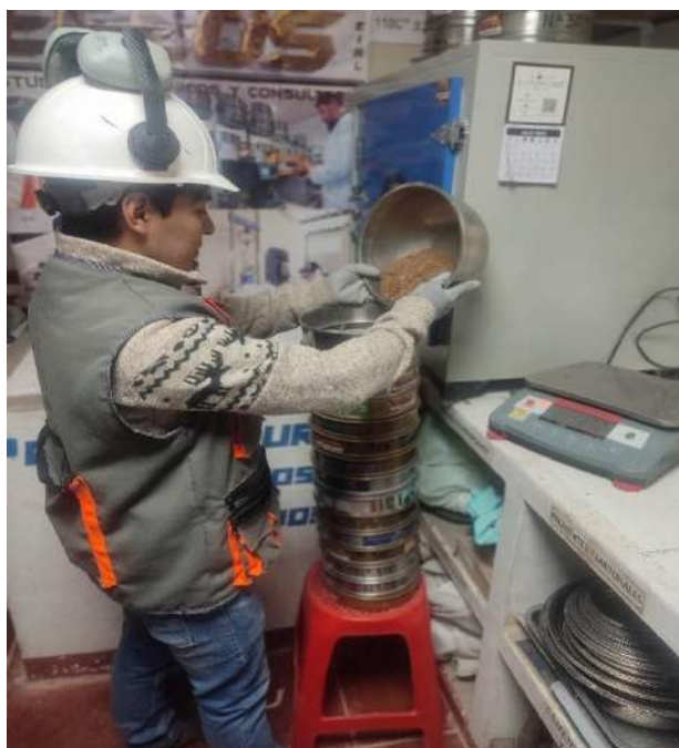
Fotografía N°24: Ensayo Análisis Granulométrico de la Calicata C-02.
