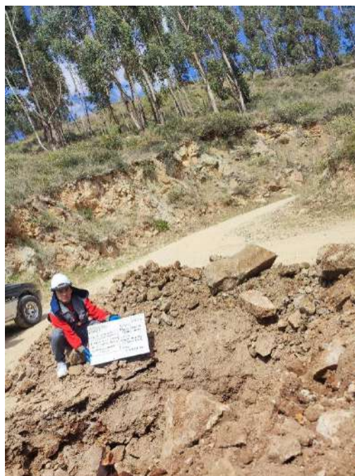
Fotografía N°04: Excavación y evaluación visual-manual de la Calicata C-01.
