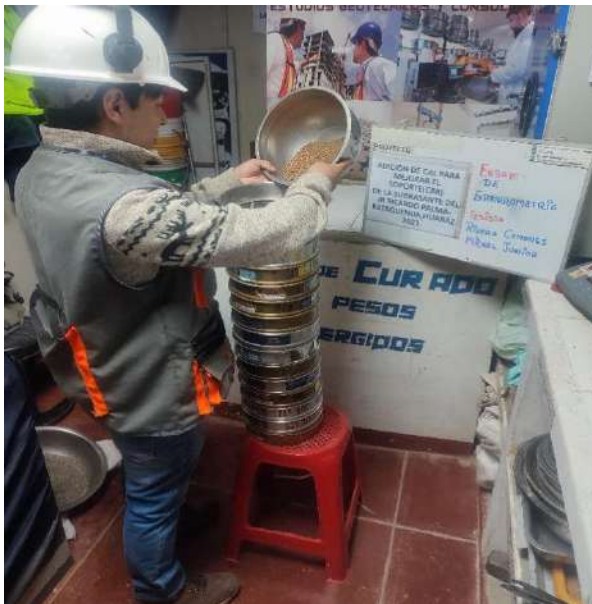
Fotografía N°21: Ensayo Análisis Granulométrico de la Calicata C-02.
