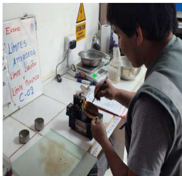
Fotografía N°30: Ensayo de Límite Líquido de la Calicata C-02.
