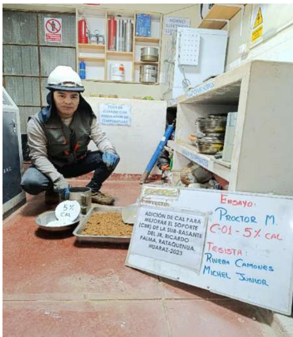
Fotografía N°35: Ensayo Proctor Modificado con el 5% de cal C-01.
