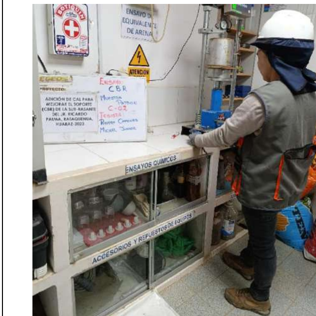
Fotografía N°49: Ensayo CBR Muestra Patron C-02.
