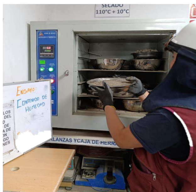
Fotografía N°25: Ensayo Contenido de Humedad de la Calicata C-01.
