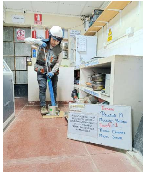
Fotografía N°32: Ensayo Proctor Modificado muestra patron Calicata C-01.
