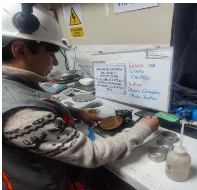
Fotografía N°28: Ensayo de Límite Líquido de la Calicata C-01.
