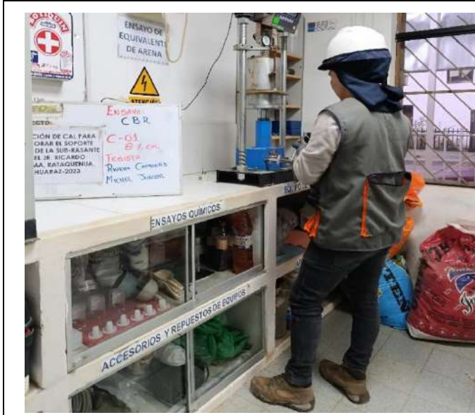
Fotografía N°47: Ensayo CBR 8% de CAL C-01.
