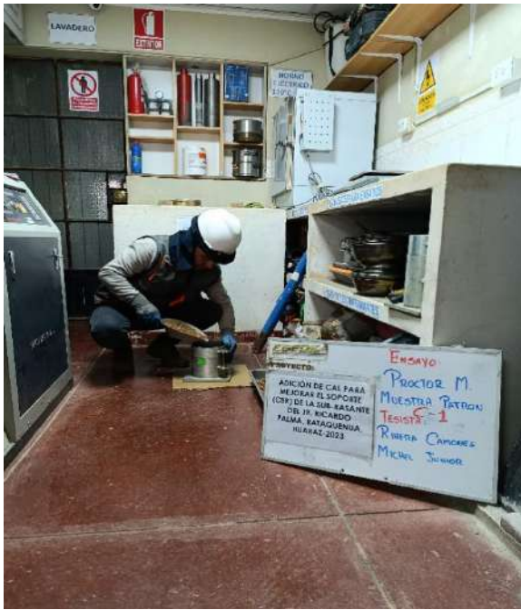
Fotografía N°31: Ensayo Proctor Modificado muestra patron Calicata C-01.
