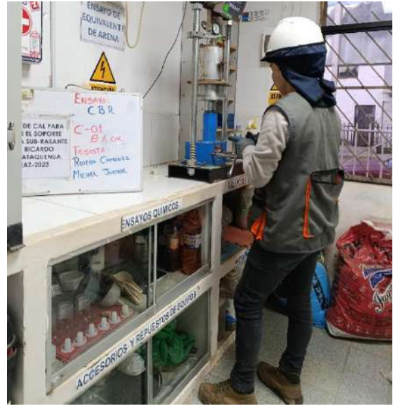
Fotografía N°48: Ensayo CBR 8% de CAL C-01.
