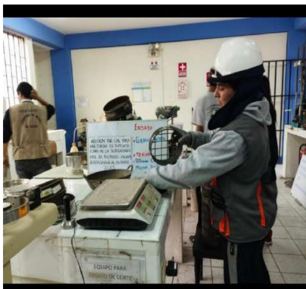
Fotografía N°17: Ensayo Análisis Granulométrico de la Calicata C-01.
