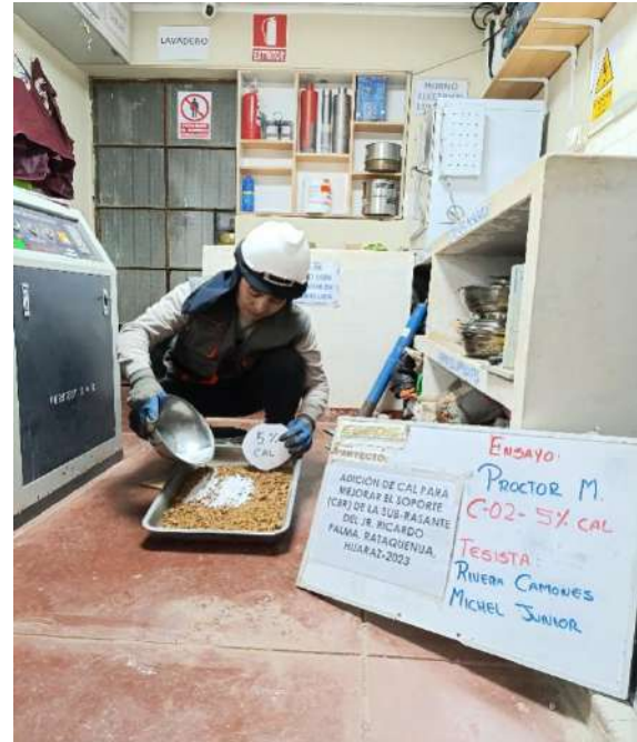
Fotografía N°40: Ensayo Proctor Modificado con el 5% de cal C-02.
