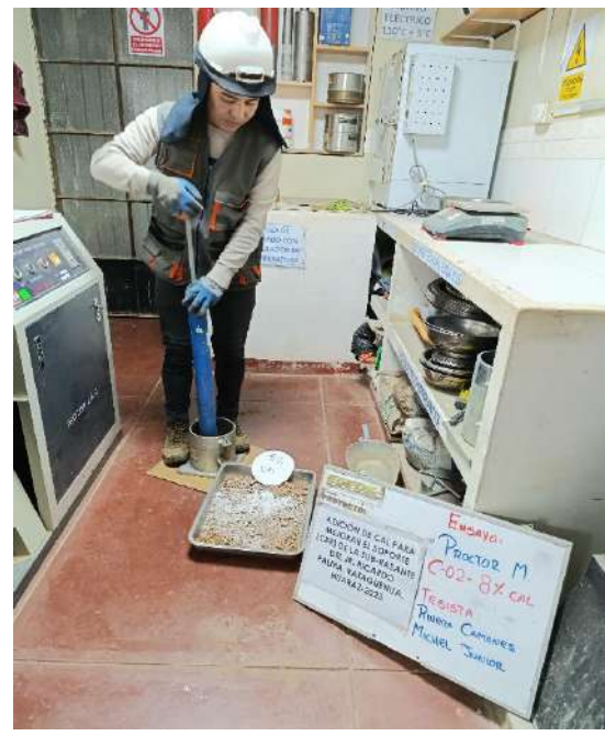
Fotografía N°40: Ensayo Proctor Modificado con el 5% de cal C-02.
