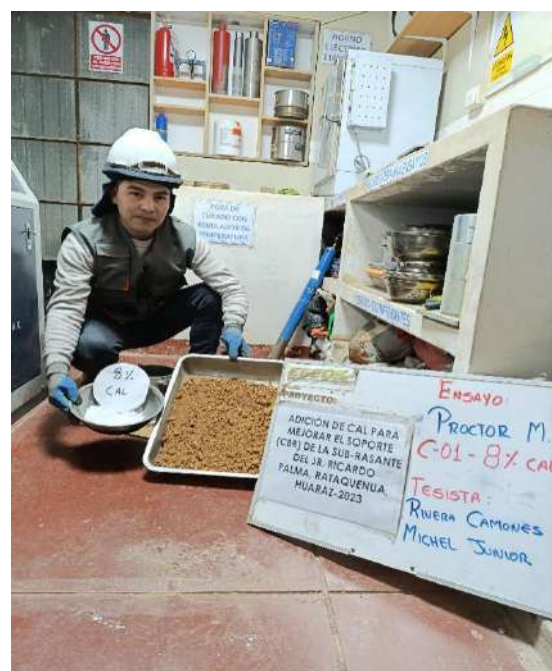
Fotografía N°38: Ensayo Proctor Modificado con el 8% de cal C-01.
