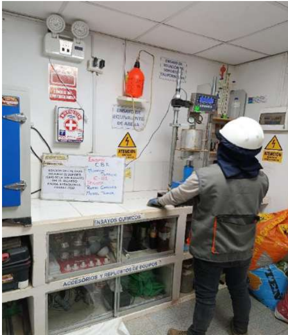
Fotografía N°43: Ensayo CBR Muestra Patron C-01.
