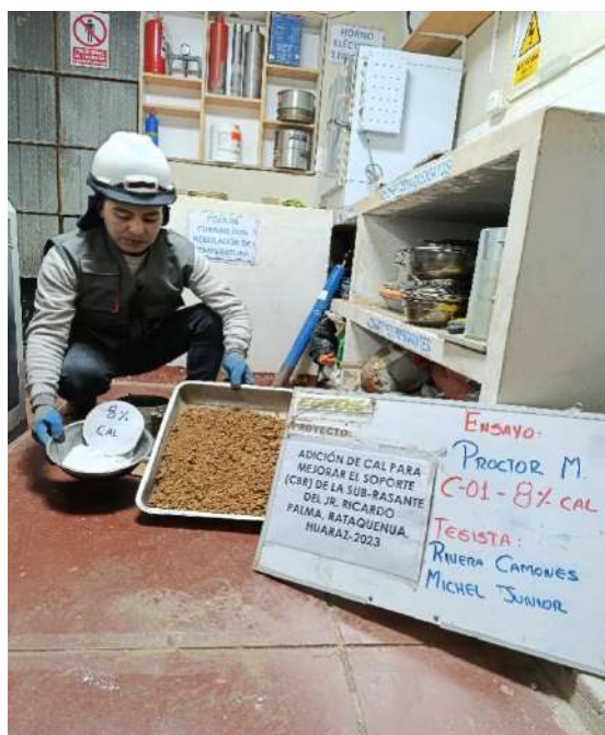
Fotografía N°37: Ensayo Proctor Modificado con el 8% de cal C-01.
