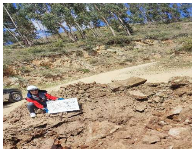
Fotografía N°10: Excavación y evaluación visual-manual de la Calicata C-02.
