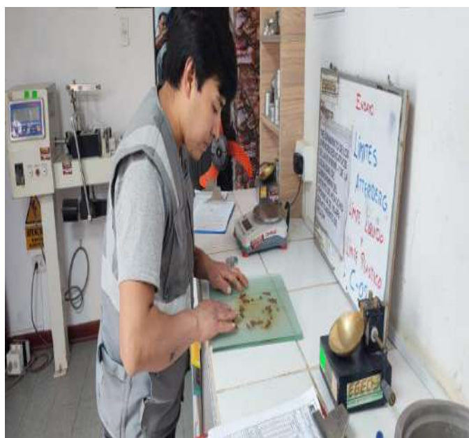
Fotografía N°29: Ensayo de Límite Plástico de la Calicata C-02.
