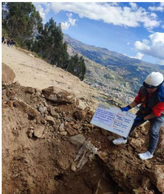
Fotografía N°11: Vista del perfil estratigráfico de la Calicata C-01.
