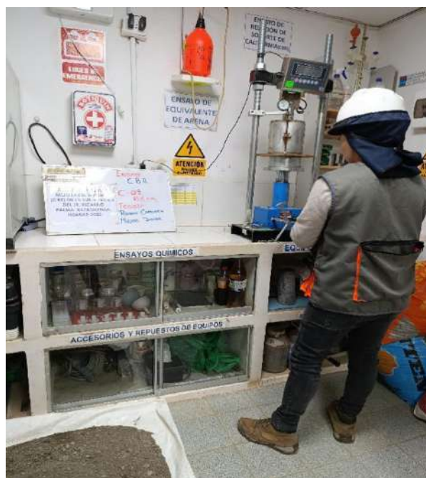
Fotografía N°54: Ensayo CBR 8% de CAL C-02.
