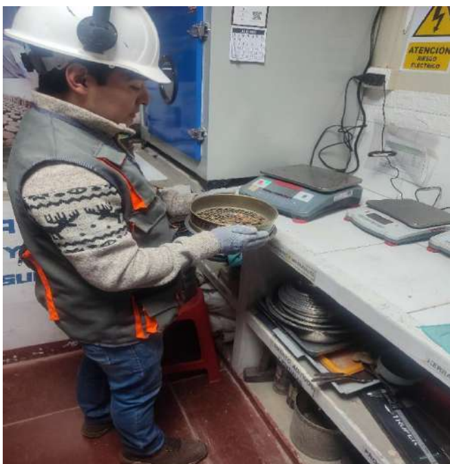
Fotografía N°23: Ensayo Análisis Granulométrico de la Calicata C-02.
