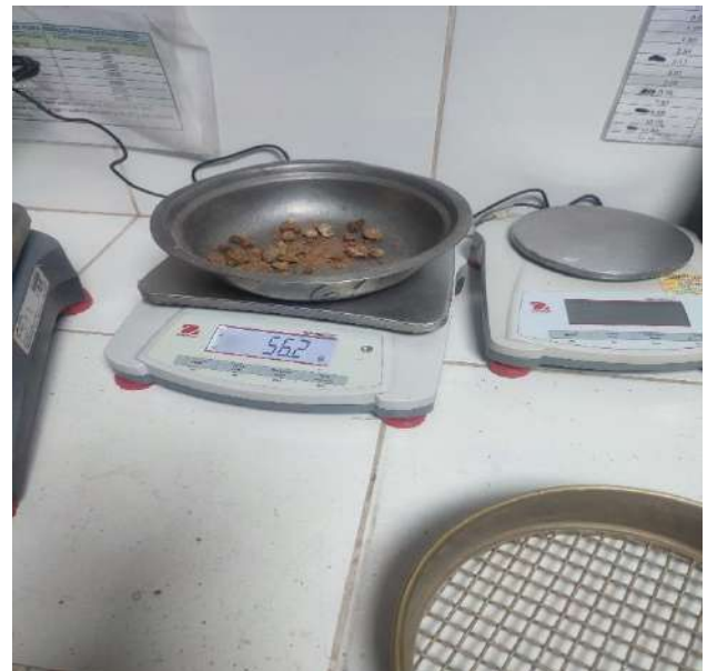
Fotografía N°22: Ensayo Análisis Granulométrico de la Calicata C-02.
