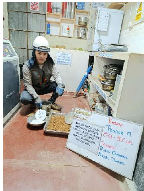
Fotografía N°36: Ensayo Proctor Modificado con el 5% de cal C-01.
