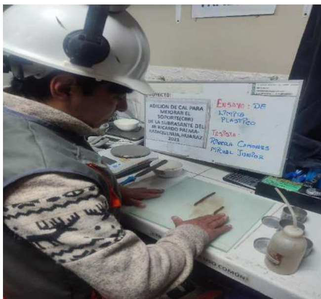
Fotografía N°27: Ensayo de Límite Plástico de la Calicata C-01.
