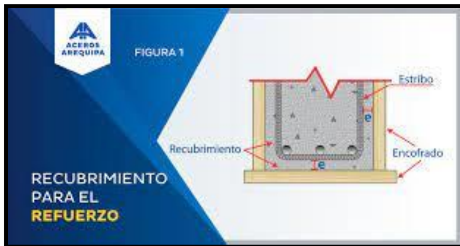
Figura # 7: Recubrimiento para el acero de refuerzo.
