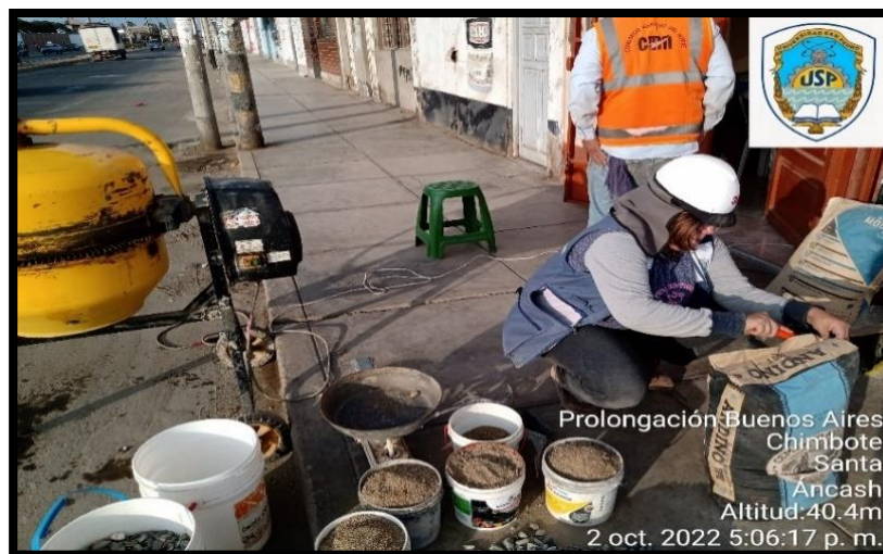
Figura # 29: Pesado de los materiales (cemento tipo V andino, agregado grueso y agregado fino).
