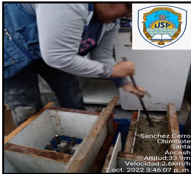
Figura # 31: do de mezcla para evitar vacíos.
