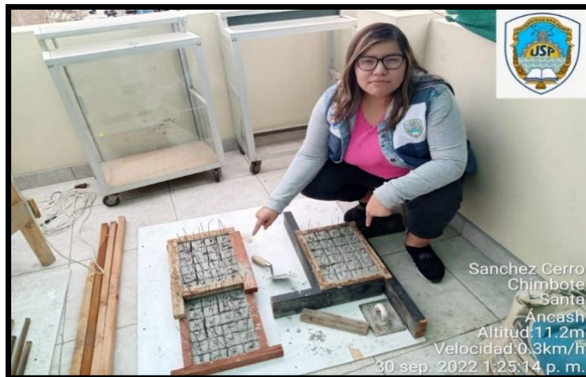
Figura # 26: Dados de concreto armado para recubrimiento
