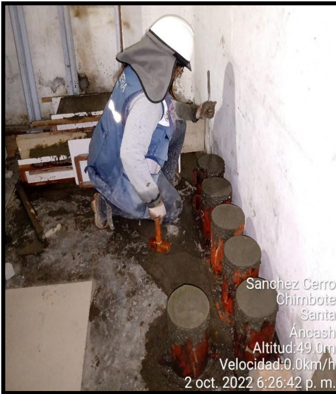
Chuseado, enrasado y golpe con martillo de goma para la mezcla
