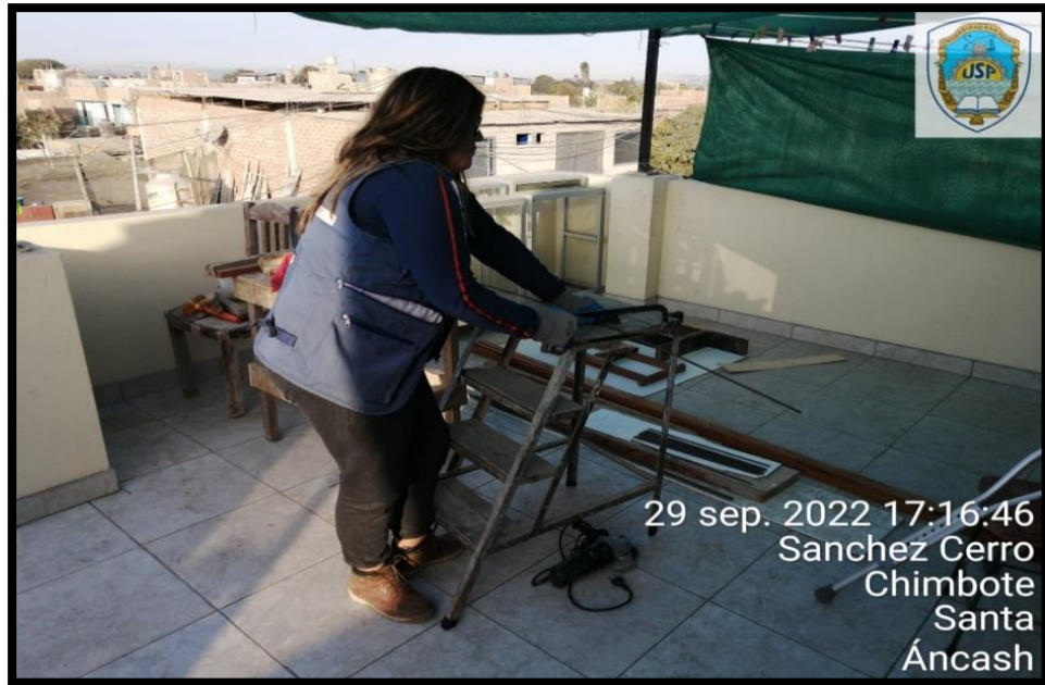
Figura # 16: Cortado de varilla de acero (10 cm de longitud)
