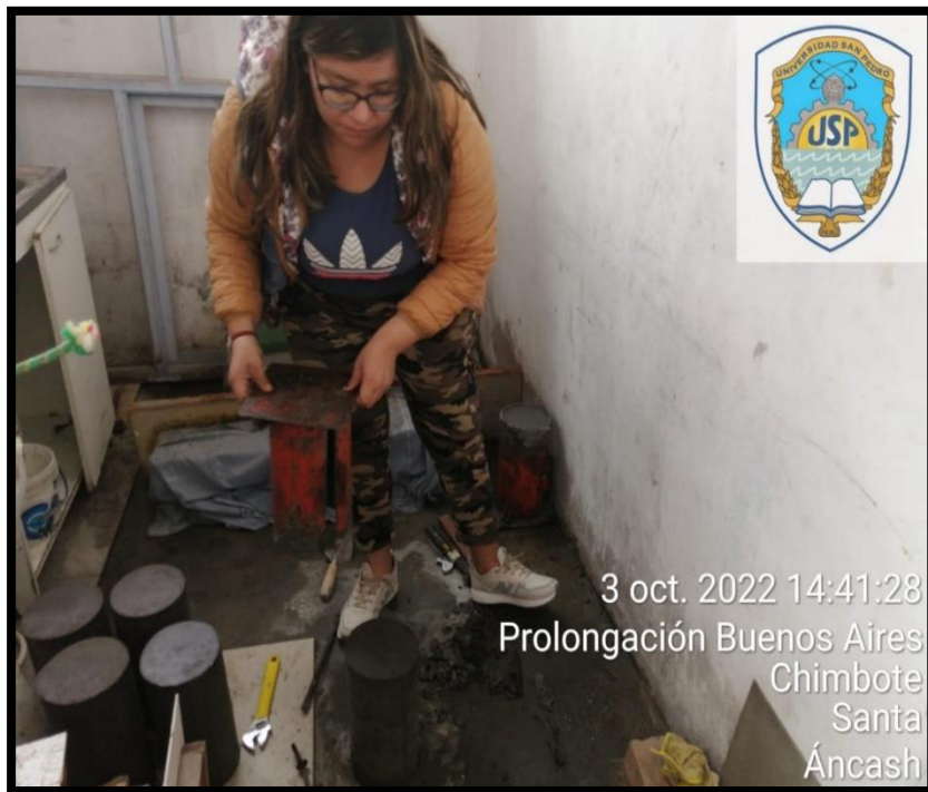
Figura # 33: Desencofrado de probetas
