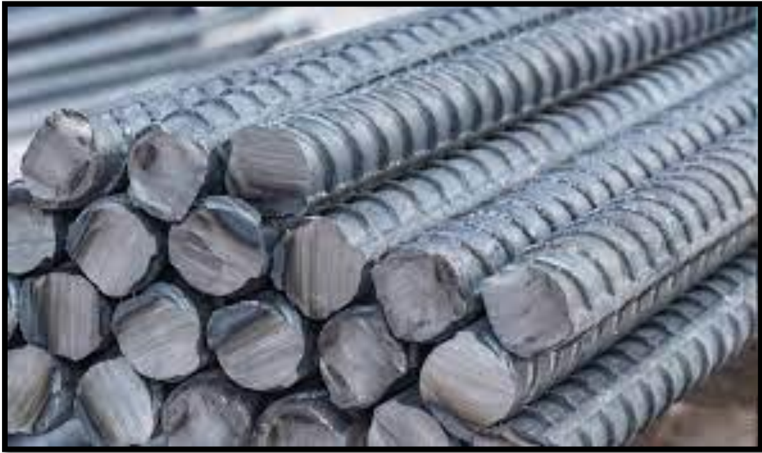
Figura #1: Acero de refuerzo
