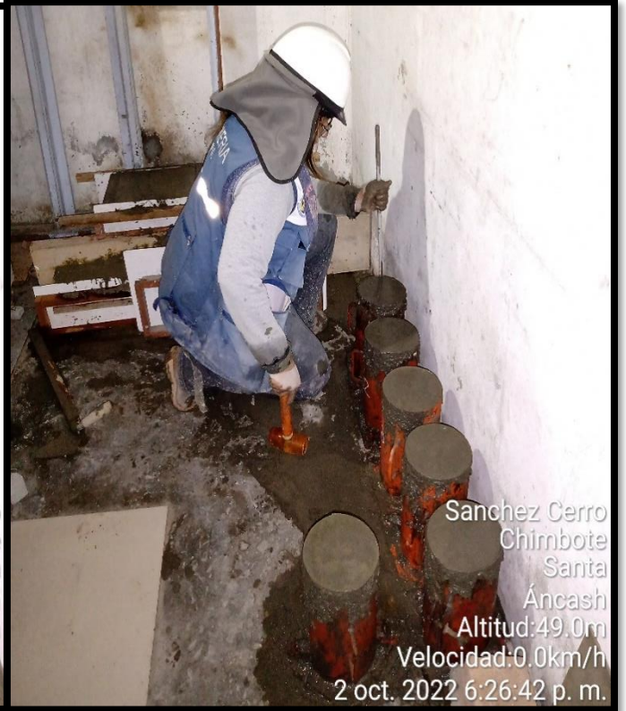
Chuseado, enrasado y golpe con martillo de goma para la mezcla
