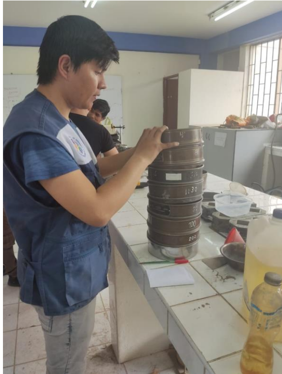
Foto 11: Tamizado del agregado fino
