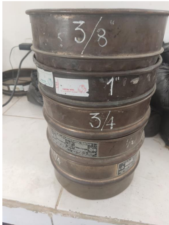
Foto 09: Tamizado del agregado gureso
