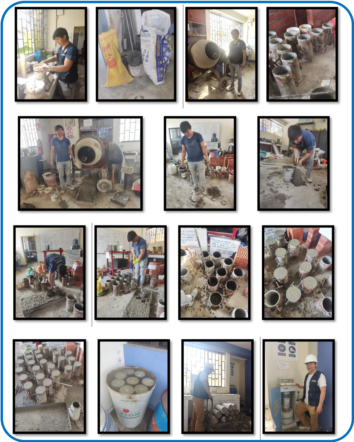
Figura 21. Pasos del proceso de elaboración de concreto f'c 210 kg/cm 2
