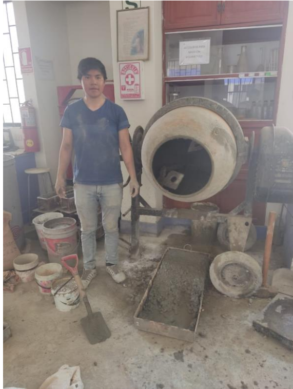
Foto 13: Preparacion del concreto patron
