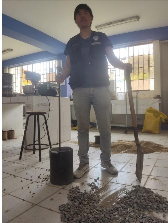
Foto 05: Peso unitario de agregado grueso
