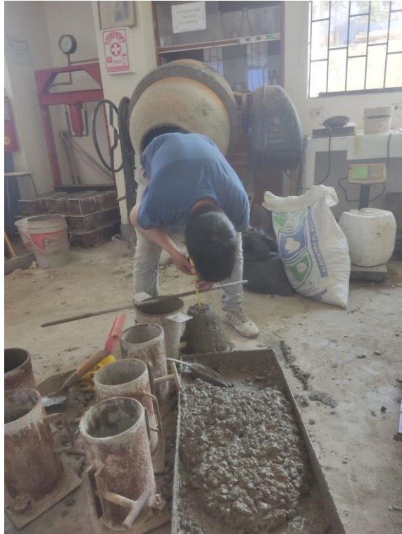
Foto 19: Medida del Slump del concreto con la combinacio II
