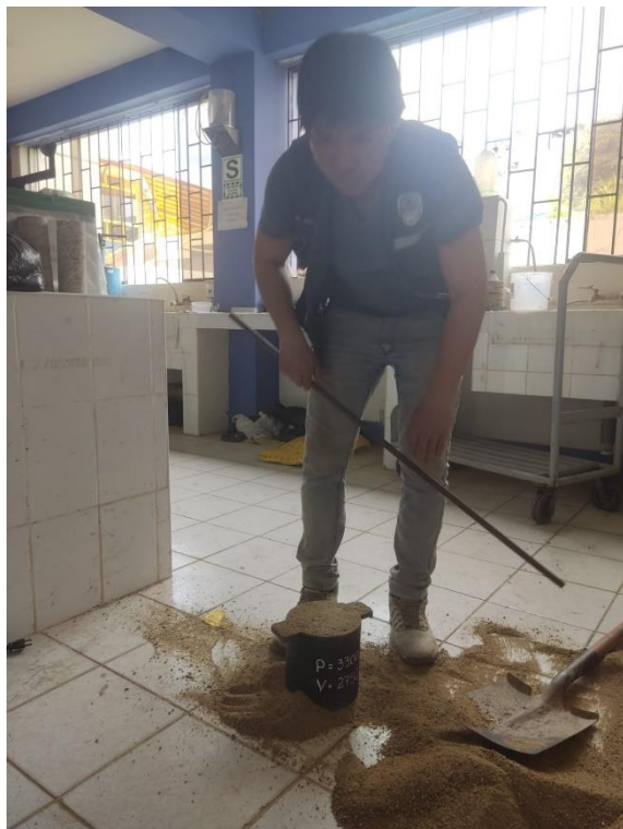
Foto 06: Peso unitario de agregado fino
