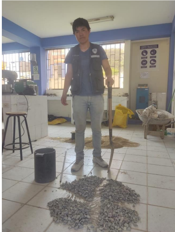
Foto 07: Cuarteado de la muestra de agregado grueso para granulometria
