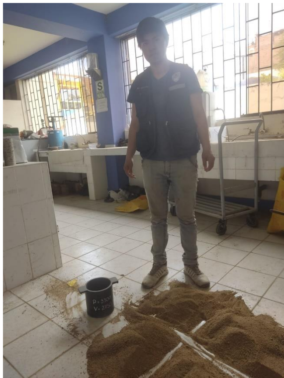
Foto 08: Cuarteado de la muestra de agregado fino para granulometria
