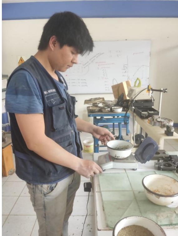
Foto 03: Peso de muestra de agregado fino para contenido de humedad
