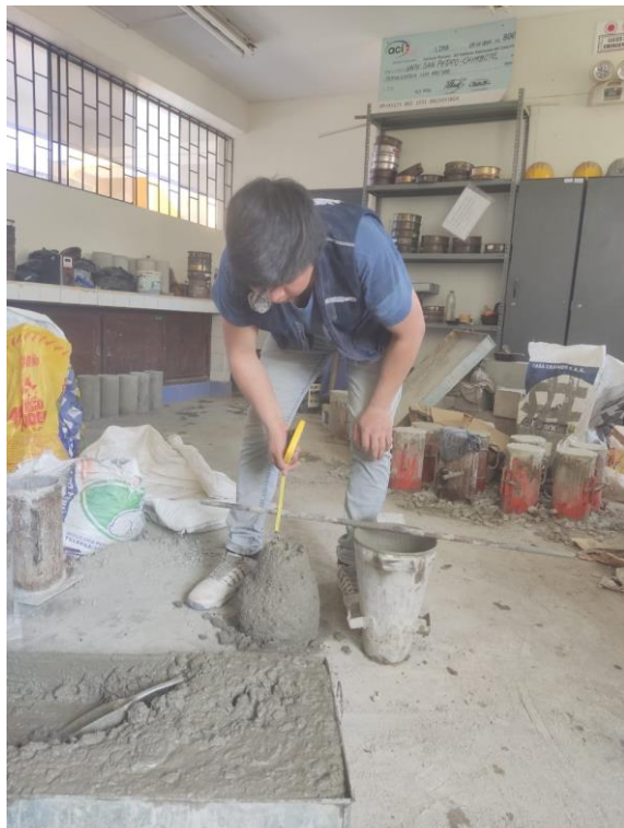
Foto 18: Medida del Slump del concreto con la combinacio I
