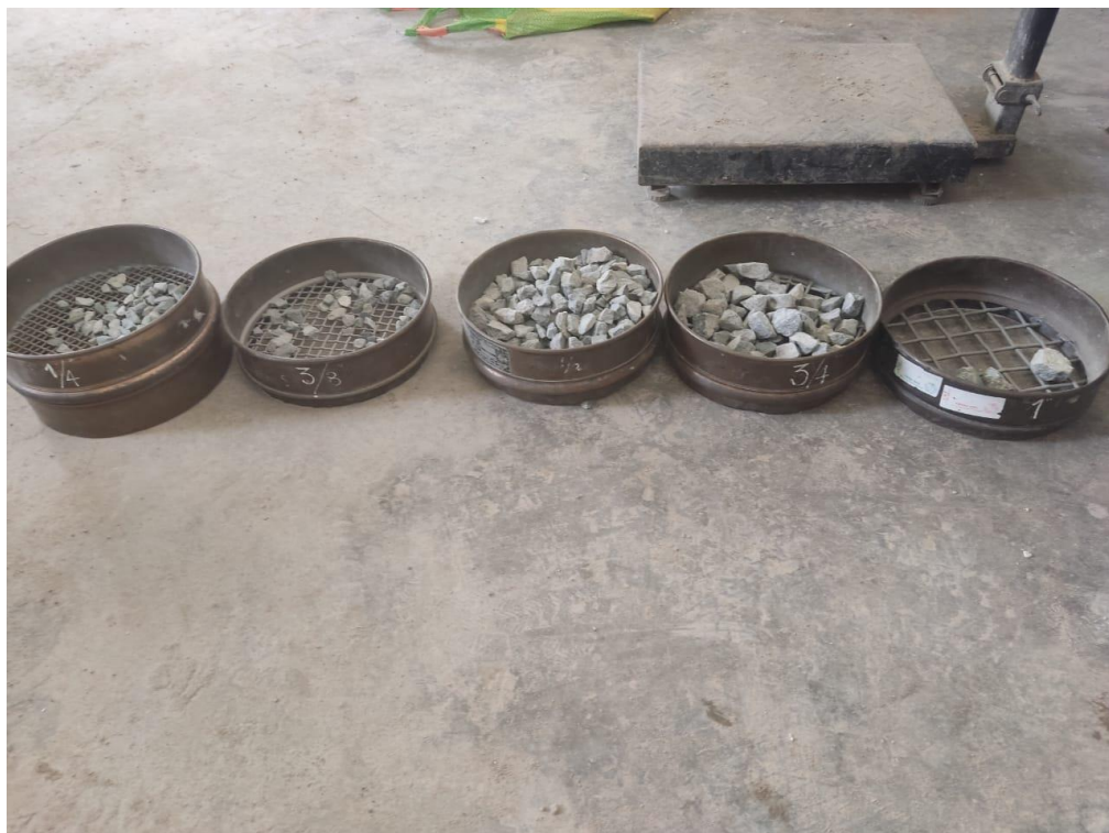
Foto 10: Resultado del tamizado del agregado gureso
