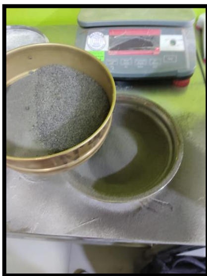
Figura 16. Pre tamizado de la ceniza de carbón
