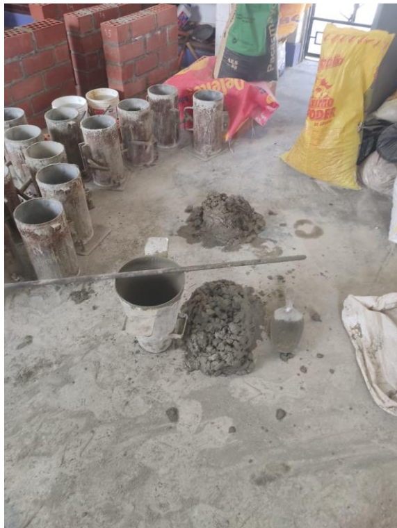
Foto 14: Medida del Slump en concreto patron
