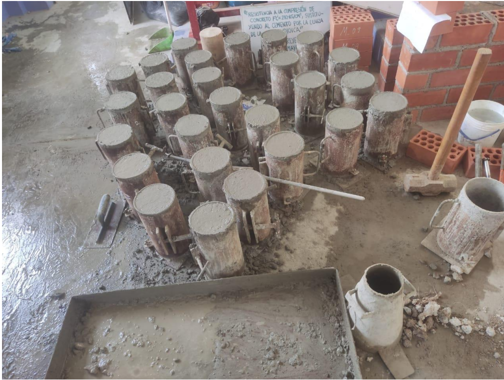
Foto 21: Probetas de los concretos de las combinaciones I, II y III
