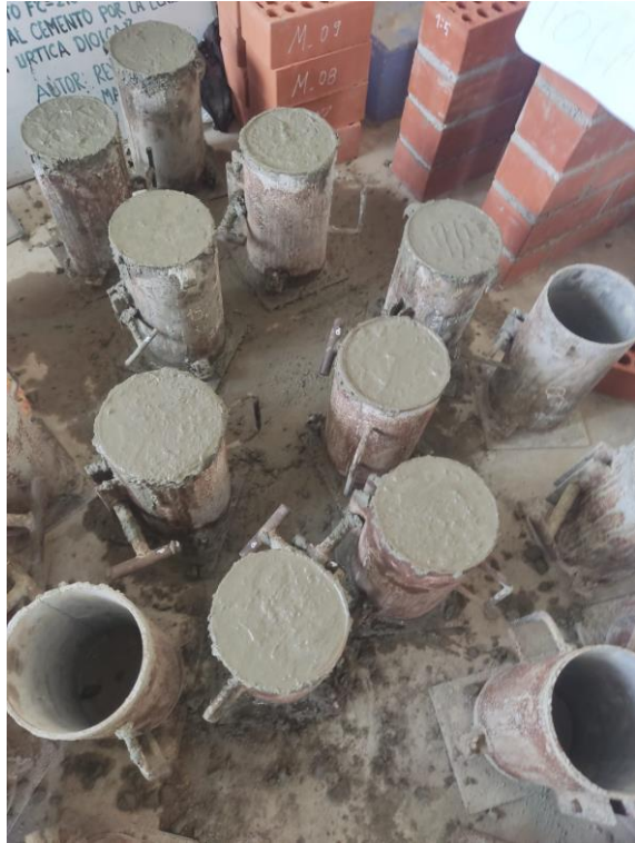
Foto 15: Probetas de concreto patron
