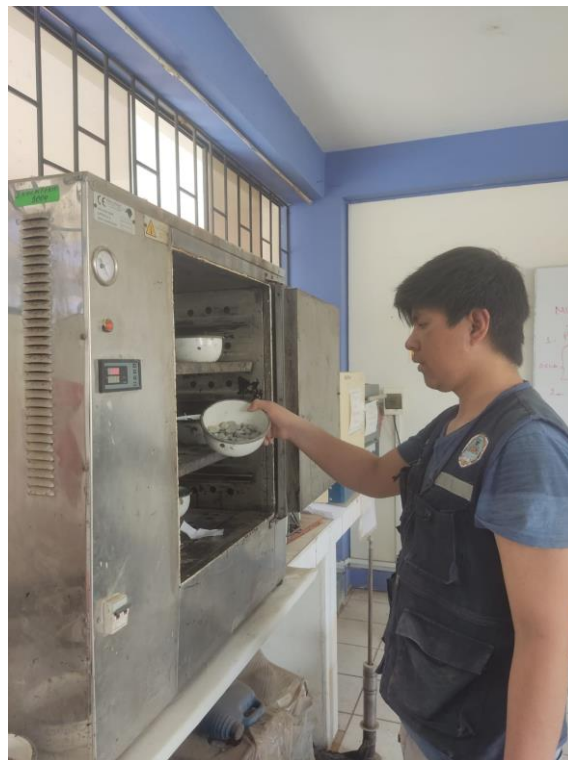
Foto 02: Secado de agregado grueso para contenido de humedad
