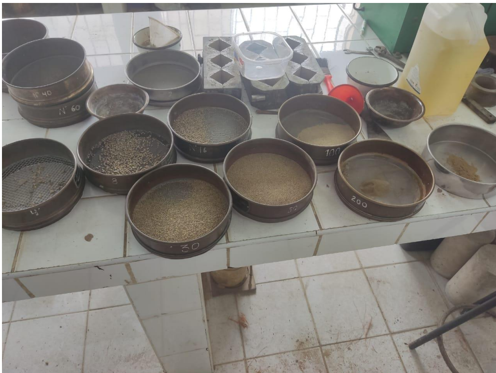
Foto 12: Resultado del tamizado del agregado fino
