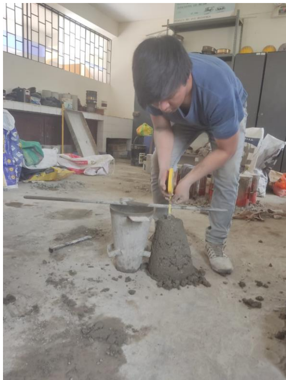
Foto 20: Medida del Slump del concreto con la combinacio III
