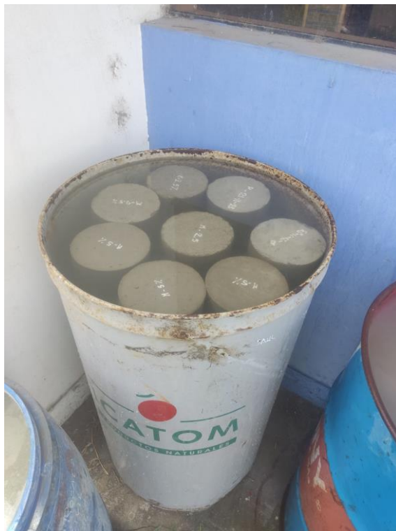
Foto 22: Curado las probetas del concreto patron y de los concretos de las combinaciones I, II y III
