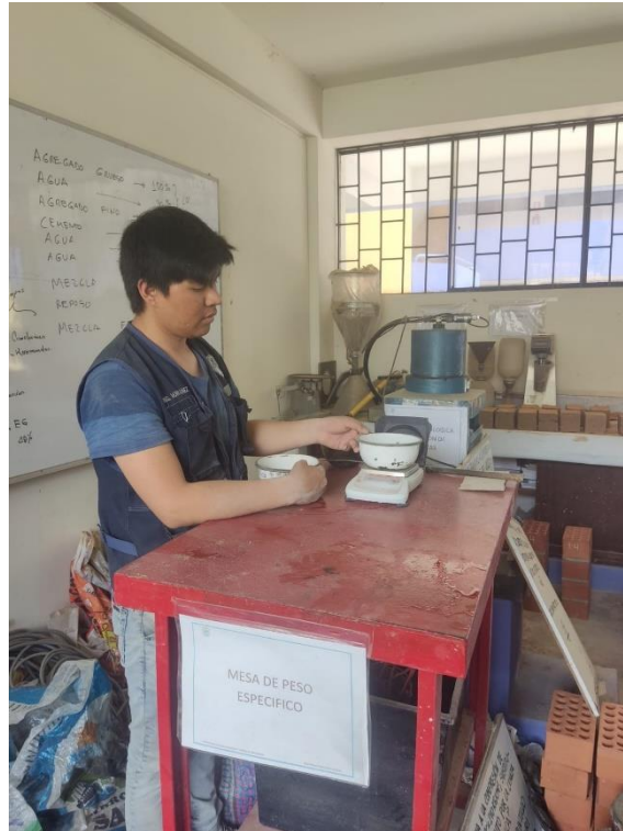
Foto 01: Peso de muestra de agregado grueso para contenido de humedad
