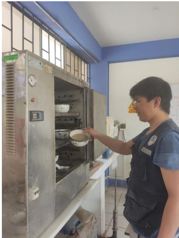
Foto 04: Secado de agregado fino para contenido de humedad
