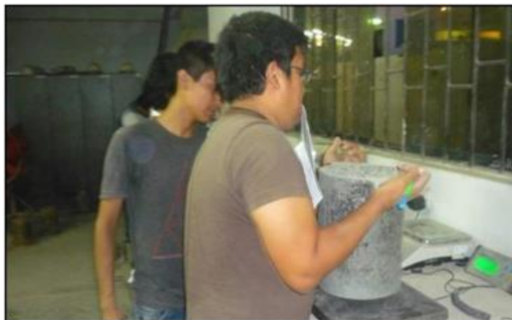
FOTO 10: PESO UNITARIO DEL AGREGADO FINO Y GRUESO COMPACTADO Y SUELTO
