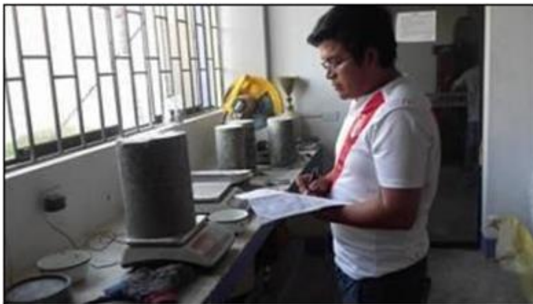
FOTO 11: PESO UNITARIO DEL PLACTICO RECICLADO COMPACTADO Y SUELTO
