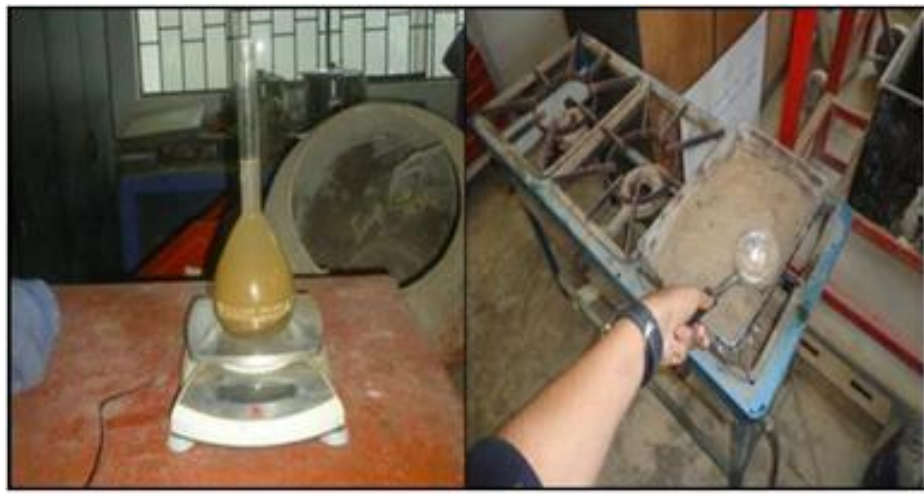
FOTO 12: GRAVEDAD ESPECÍFICA Y ABSORCIÓN DEL AGREGADO FINO
