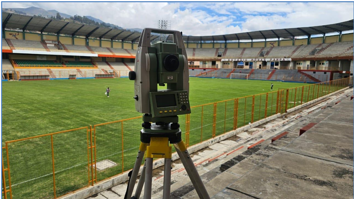
Figura 38 Levantamiento topográfico con Estación Total South N4
