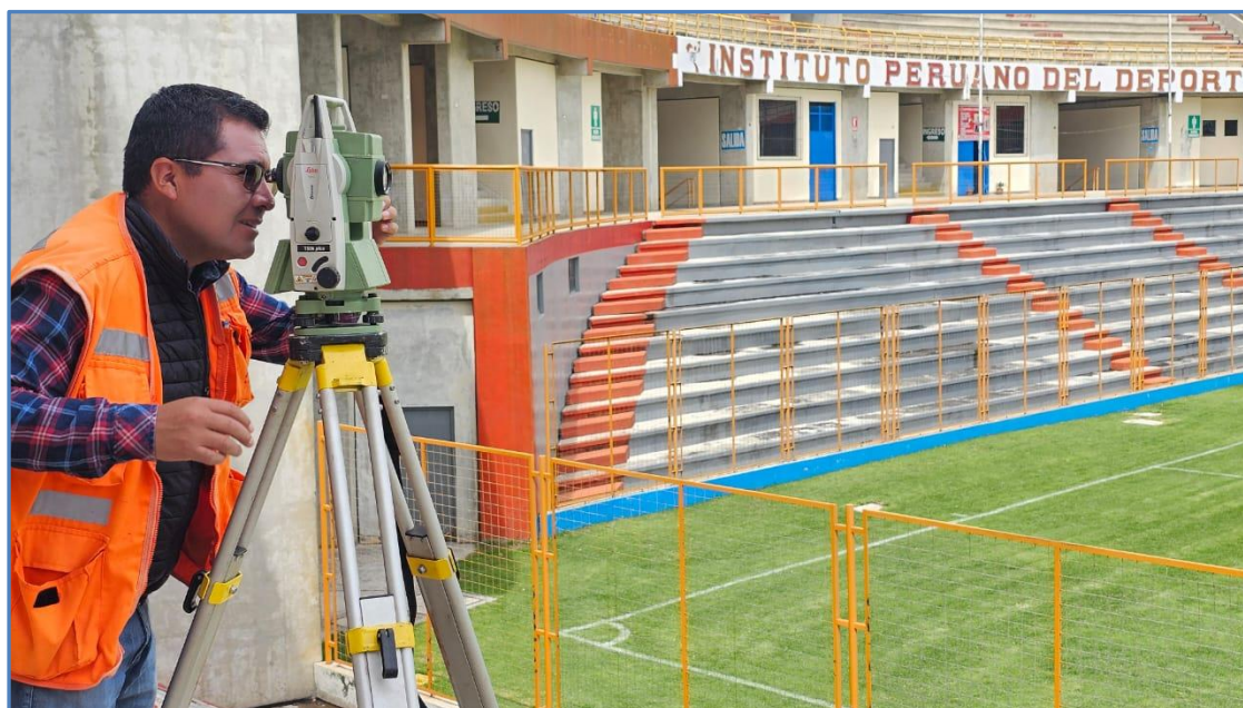
Figura 36 Levantamiento topográfico con Estación Total South N4
