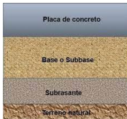
Figura 01. Elementos que conforman un pavimento
