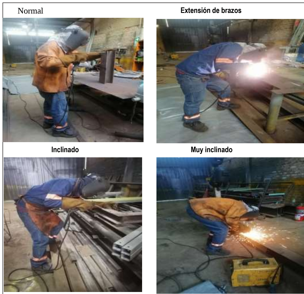
Figura 2. Posturas en el proceso de soldadura
