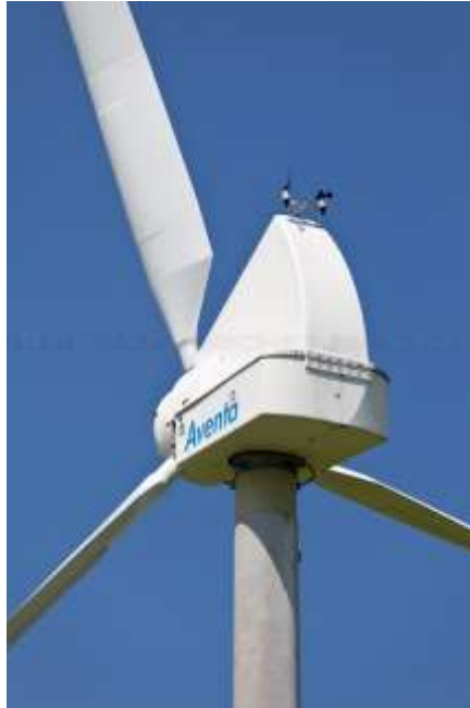
Figura 10: Aerogenerador AV - 7 Fuente: (Buaer, 2011)
