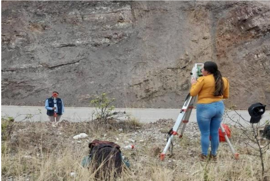
Figura 10. Levantamiento topográfico del talud.
