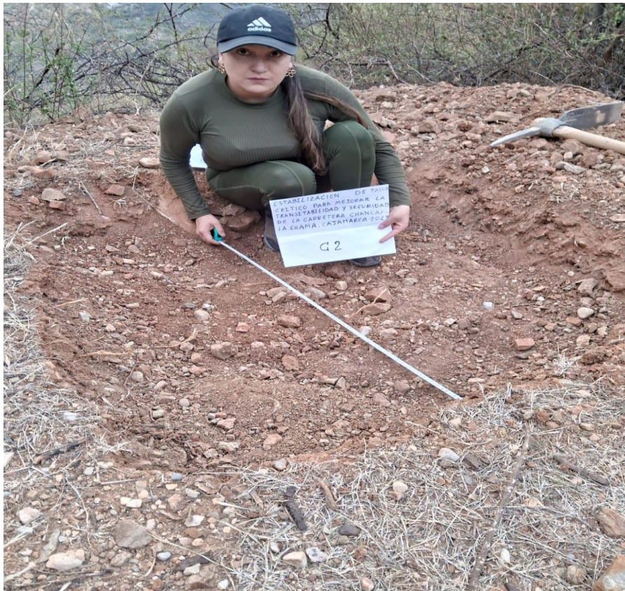
Figura 13. Ubicación de CALICATA N° 02 – Del Talud
