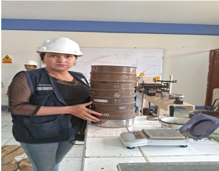
Figura 16. Ensayo de Mecánica de suelos - Granulometría por tamizado.
