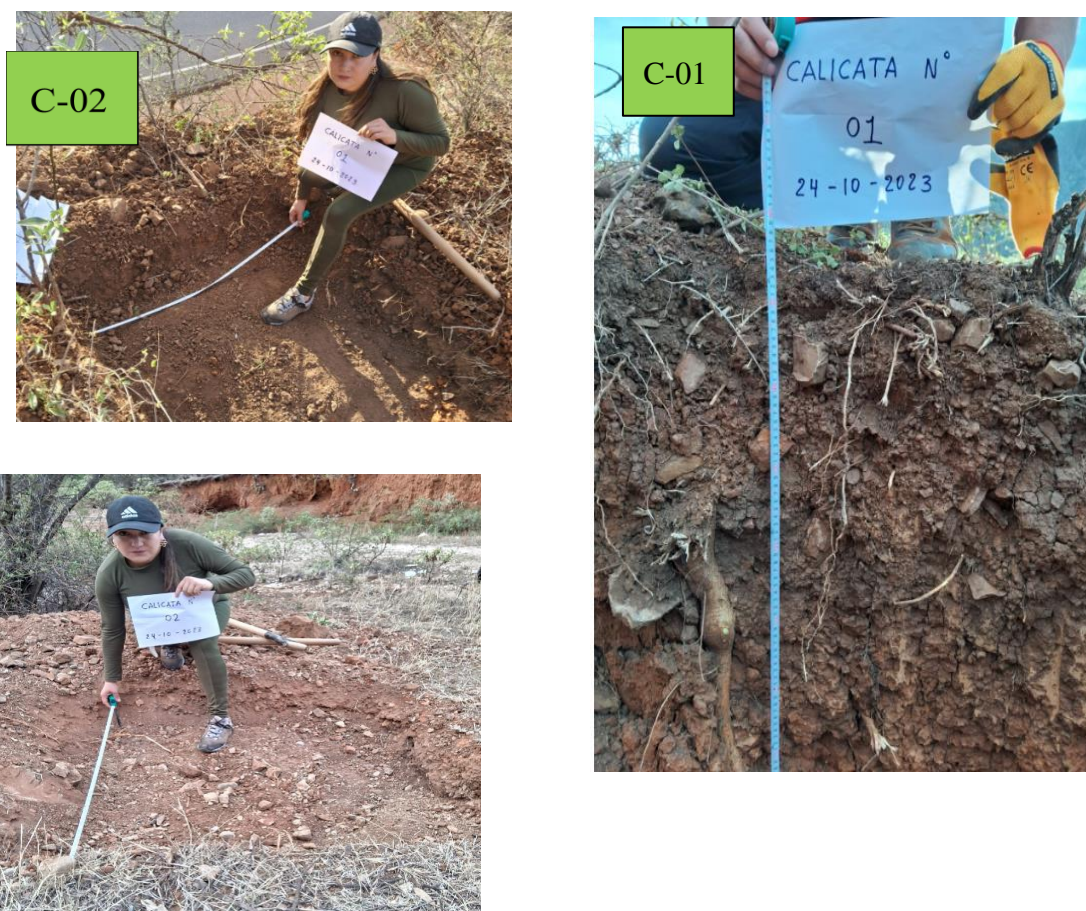
Figura 9. Calicatas C1 y C2 de 1.50 m. de profundidad.
