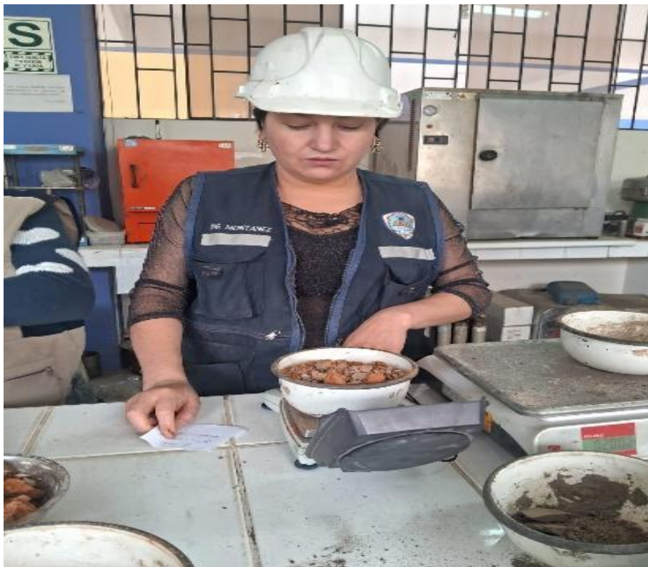
Figura 16. Ensayo de Mecánica de suelos - Granulometría por tamizado.
