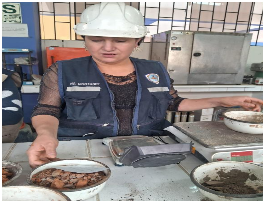
Figura 15. Ensayo de Mecánica de suelos - Contenido de humedad
