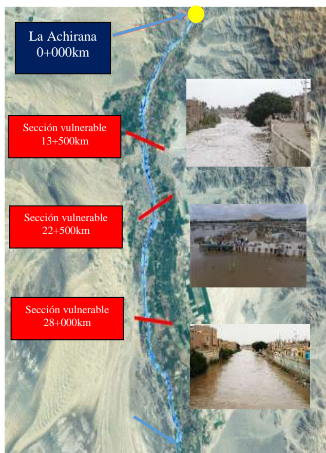
Figura N°14: Identificación de zonas inundables en el tramo del Río Ica
