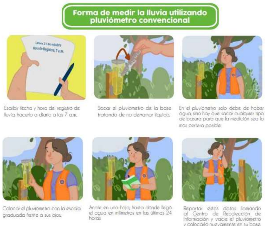
Figura N°21: Medición de lluvia mediante pluviómetro
