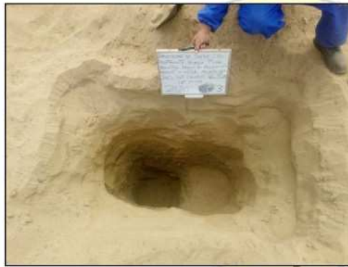
FOTO 05: SE OBSERVA LA EXCAVACIÓN CALICATA C-03.
