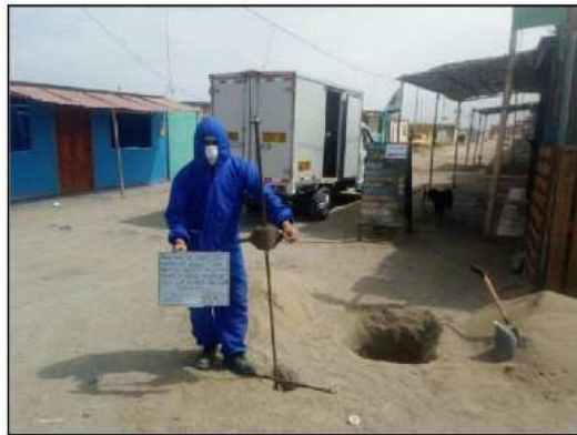
FOTO 08: SE OBSERVA LA AUSCULTACION DPL-02.
