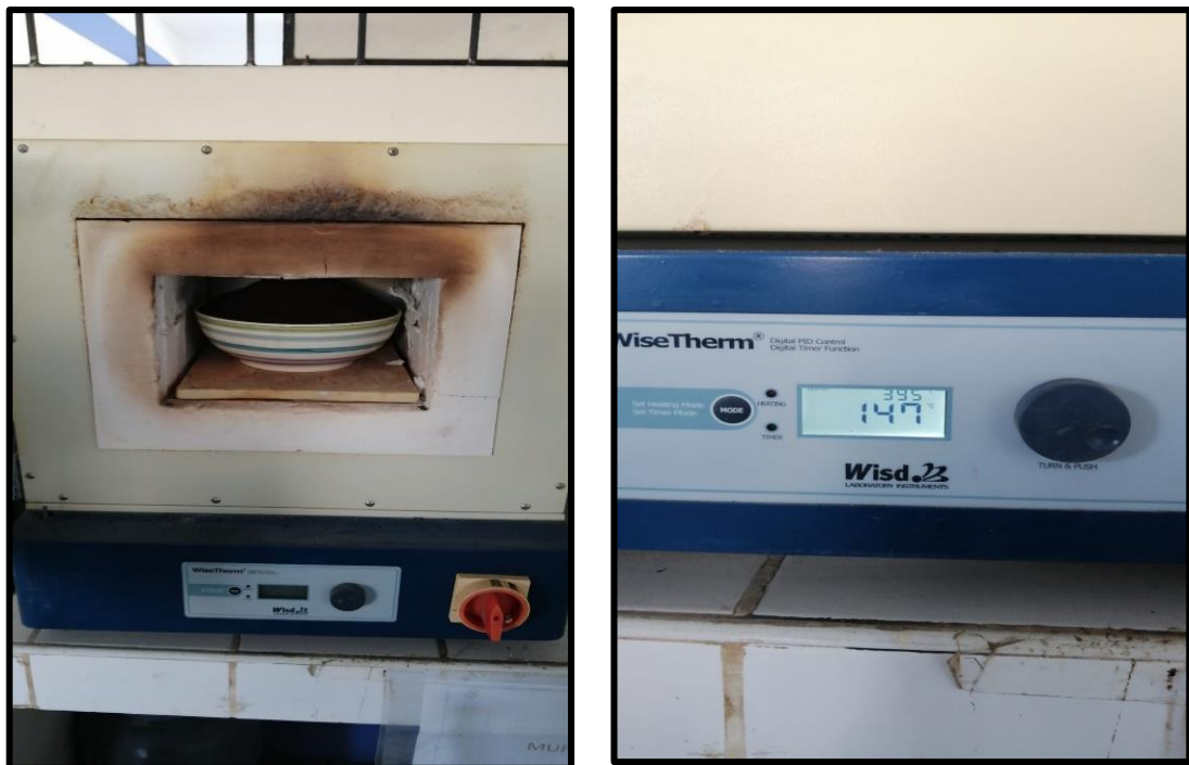
Figura 18. Activación de residuos de café en la mufla de la Universidad San Pedro (Durante 1 hora a 395°C)
