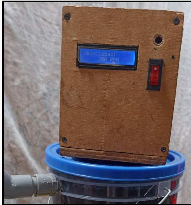
Figura 25. Se aprecia la caja acondicionada con un motor y pantalla led con una velocidad de 200 rpm
