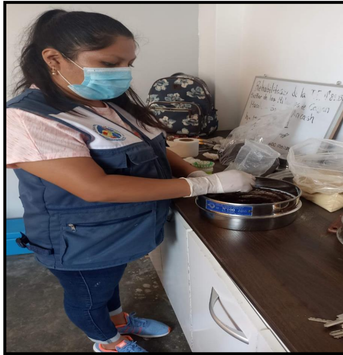
Figura 15. Tamizado de los residuos de café triturado (Tamiz N°100)
