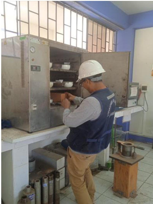
Figura 15. Ensayo de succión unidades albañilería
