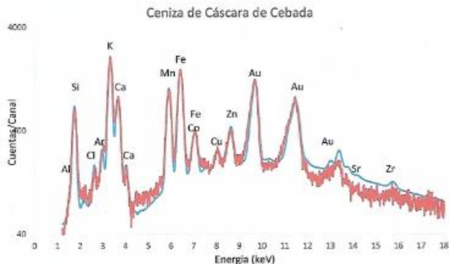
Figura 1. Espectro de FRXDE de la muestra de ceniza de cáscara de cebada en escala semilogarítmica. Incluye el pico de Ar del aire y los picos de rayos-X primarios de Au dispersados por la muestra. La curva en azul muestra el espectro simulado
