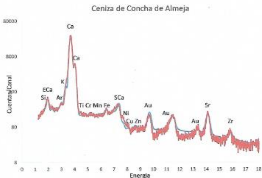
Figura 1. Espectro de FRXDE de ceniza de concha de almeja en escala semilogarítmica. Incluye el pico de Ar del aire y los picos de rayos-X primarios de Au dispersados por la muestra. También incluye los picos de escape y suma de Ca (ECa y SCa). La curva en azul muestra el espectro simulado
