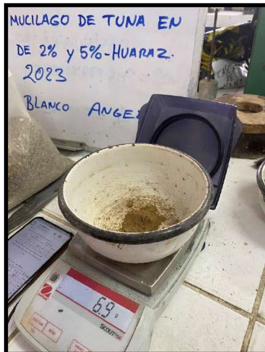
Figura 13. Pesos del agregado fino retenido en el fondo del tamiz.
