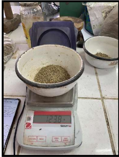
Figura 10. Pesos del agregado fino retenido en el tamiz 8 y 16.
