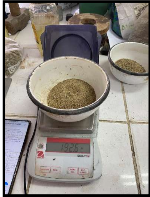
Figura 11. Pesos del agregado fino retenido en el tamiz 30 y 50.
