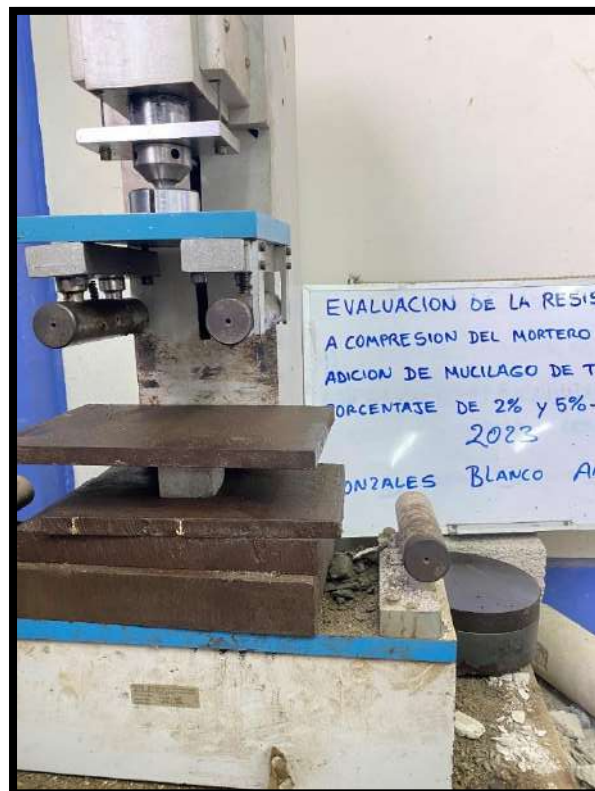
Figura 20. Ensayo de compresión de los morteros
