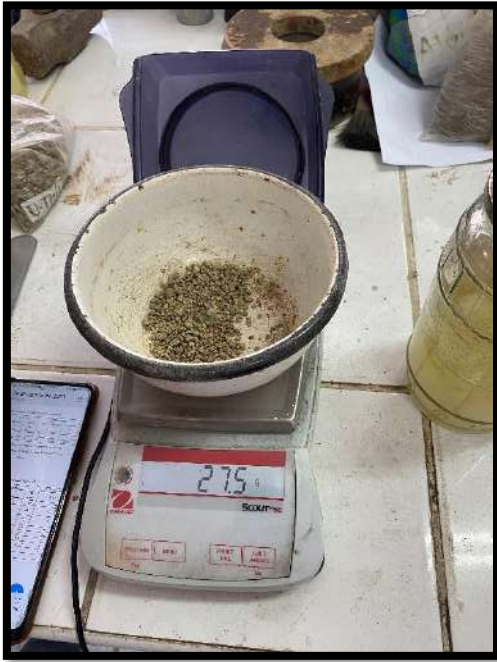
Figura 10. Pesos del agregado fino retenido en el tamiz 8 y 16.
