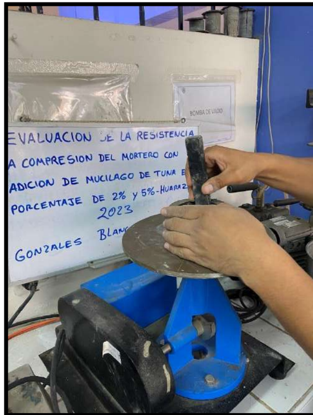
Figura 17. Realizando la prueba de fluidez de muestra patrón
