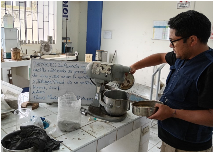
Figura 14. Proceso de elaboración de mortero de cemento portland en batidora de
