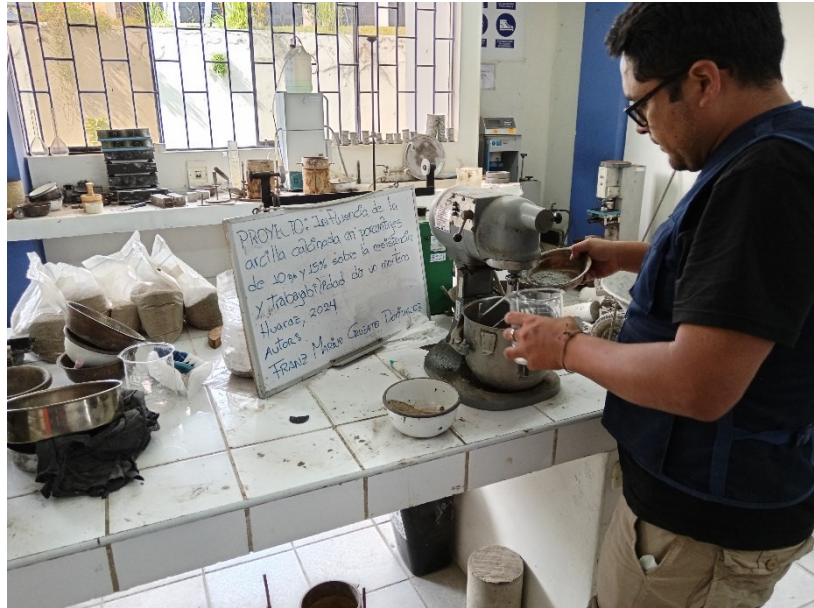
Figura 14. Incorporación de agua en la batidora
