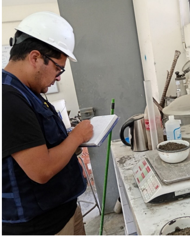
Figura 11. Toma de datos de gradación de la arena gruesa
