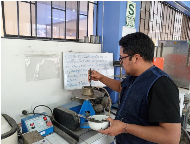
Figura 14. Incorporación de agua en la batidora
