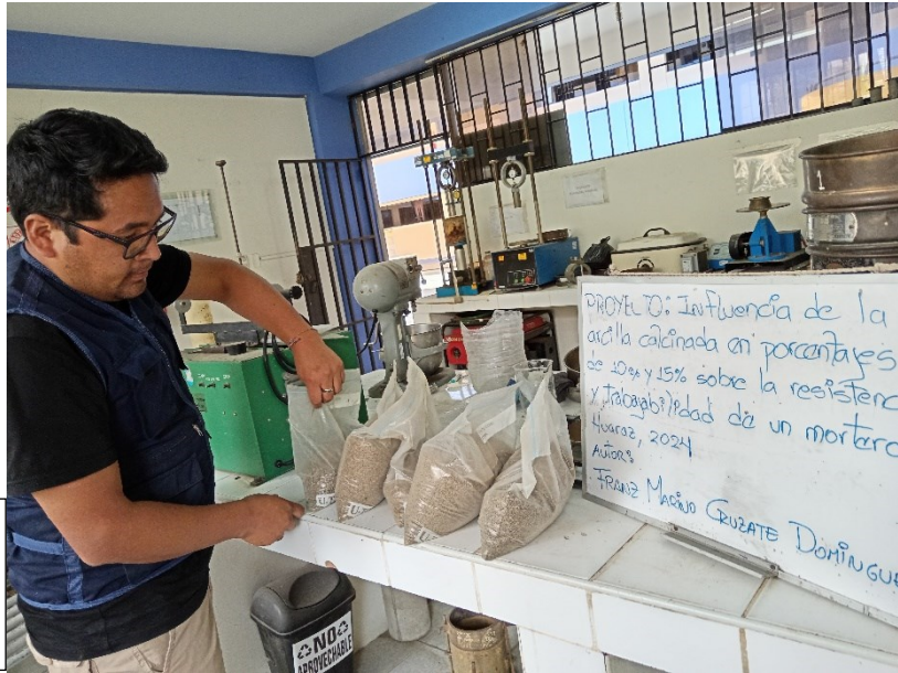
Figura 17. Arena gruesa gradada para elaboración de mortero
