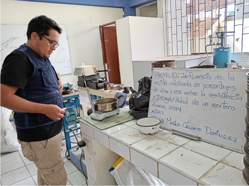
Figura 14. Pesando de arena según tamiz
