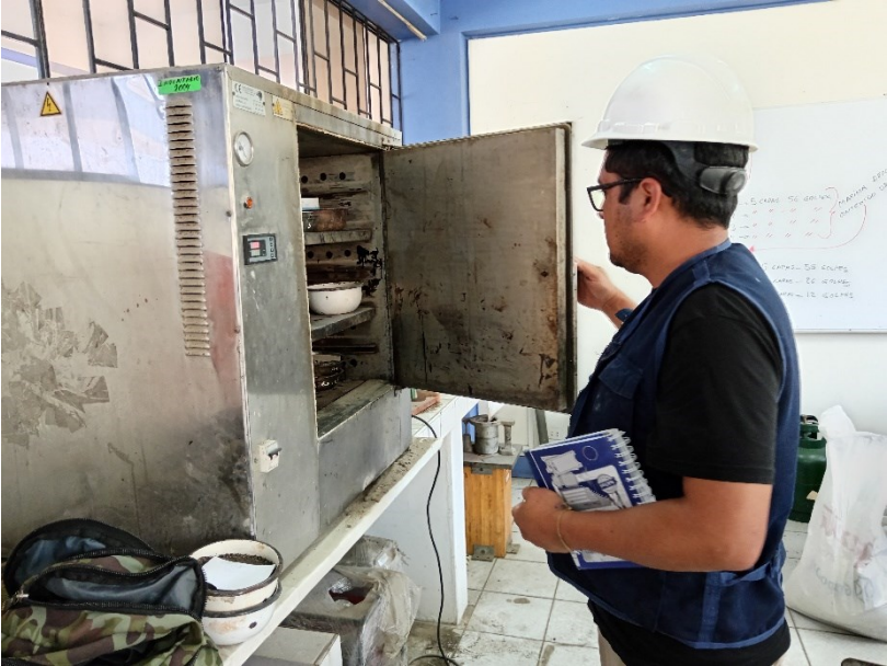
Figura 11. Ingreso de la arcilla al horno
