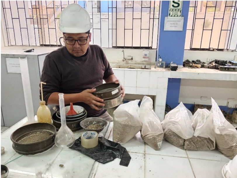
Figura 10. Gradación de arena gruesa en cada tamiz de dosificación
