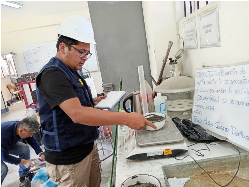
Figura 10. Proceso de pesado de la arena gruesa según tamiz
