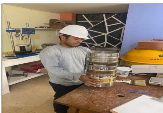
Realizando el ensayo de análisis granulométrico de suelos por tamizados con las mallas N°4,10,20,30,40,60,100,200.
