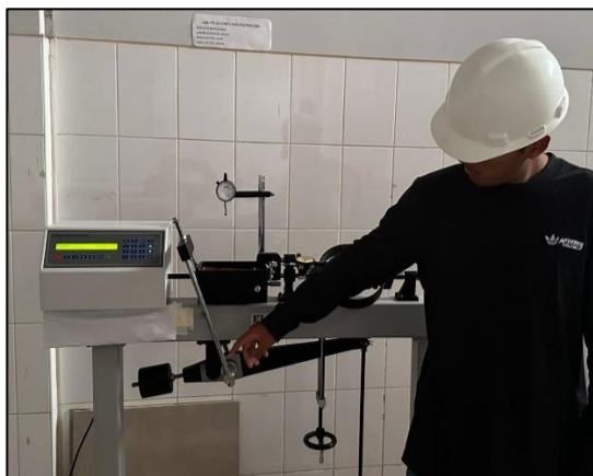
Tomando datos de la lectura de carga horizontal.
