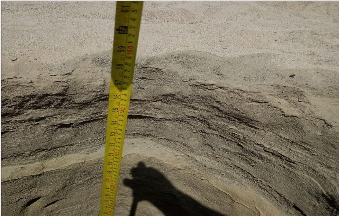
Anexo 15.5: “Se aprecia la medición de la profundidad -1.50 de la Calicata N°02.” Fuente: Elaboración propia.
