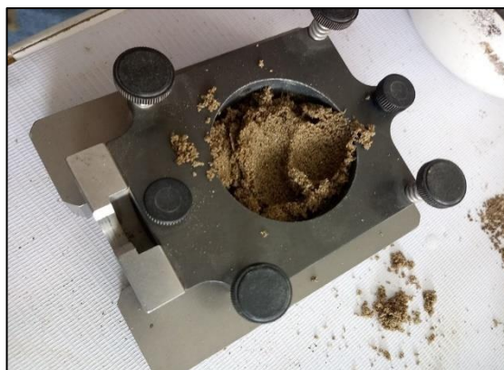
Tallando la muestra en la caja de corte circular de diámetro. 2''
