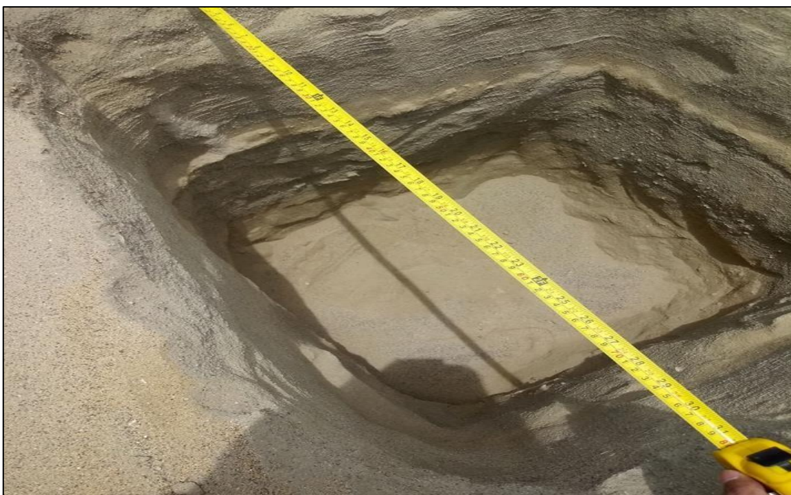
Anexo 15.7: “Se aprecia la medición del ancho de la Calicata N°03.”
