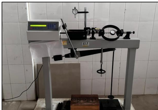
Equipo corte directo ASTM D-3080.
