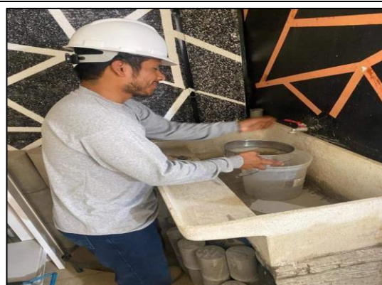
Aplicando el procedimiento del lavado de la muestra para remover las partículas y recolectar la muestra obtenida por la malla N°200.
