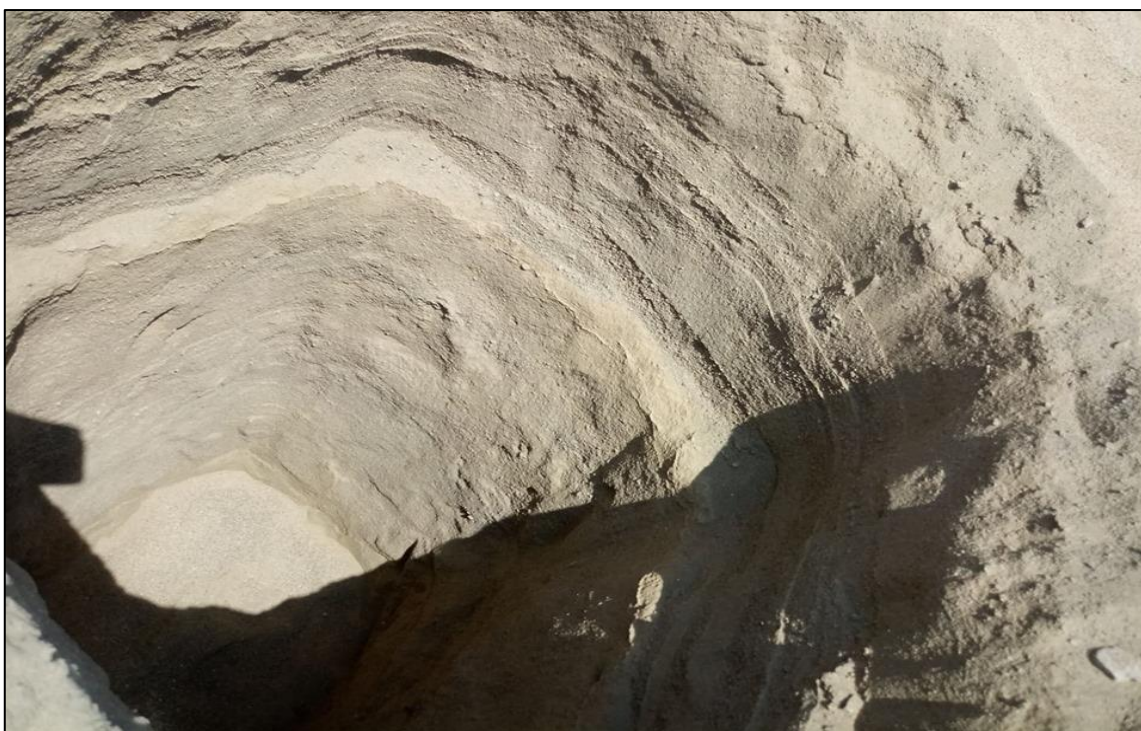
Anexo 15.3: “Se aprecia la Calicata N°01 terminado con la profundidad correcta de -1.50m.” Fuente: Elaboración propia.
