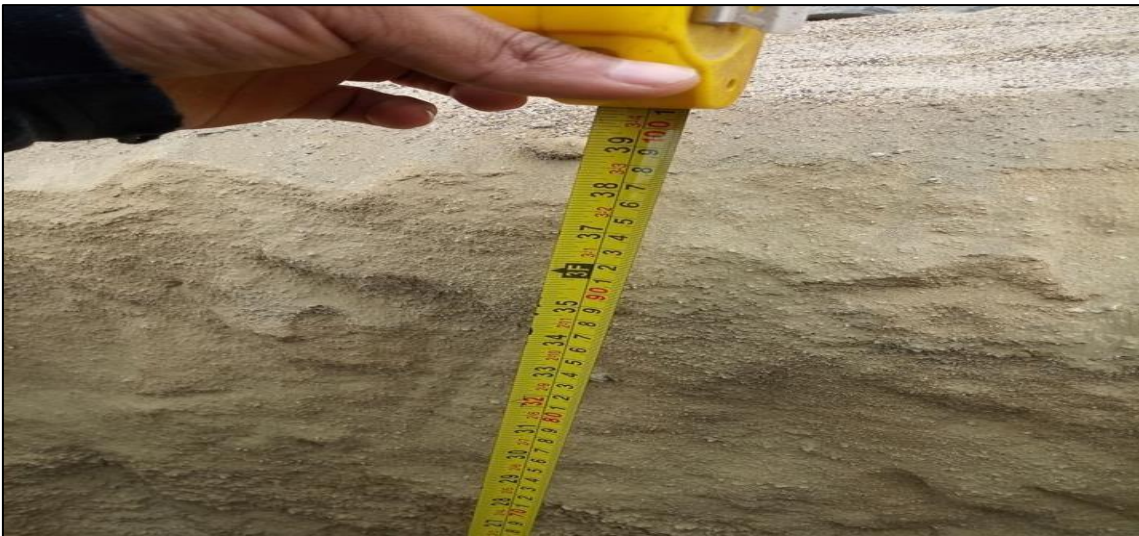
Anexo 15.10: “Se aprecia la medición previa a la profundidad para llegar a -1.50 de la Calicata N°04.”
