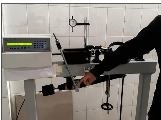
Procediendo a poner la muestra de ensayo con sumo cuidado se conecta el dispositivo de carga y se ajusta el dial.
