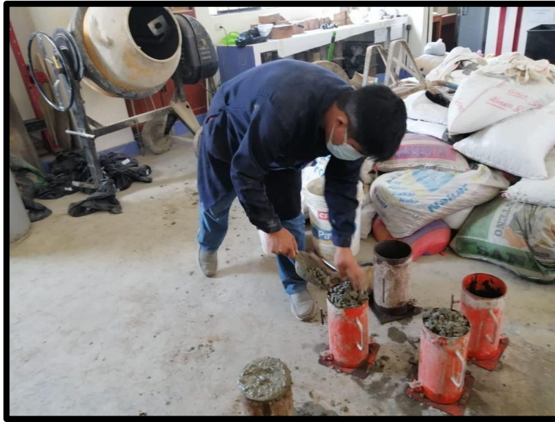
Figura 20. Vaciado de concreto a las probetas
