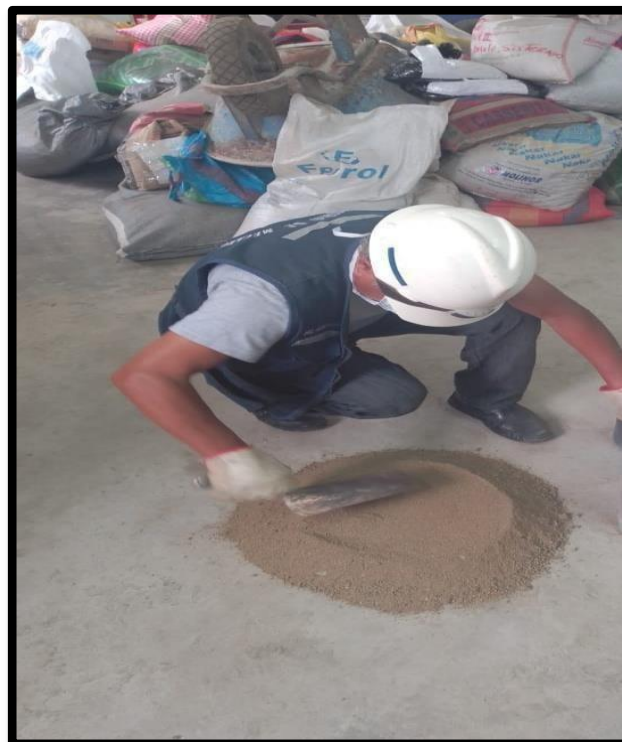
Figura 17. Cuarteo del agregado fino para hacer el ensayo de P.U. compactado y seco
