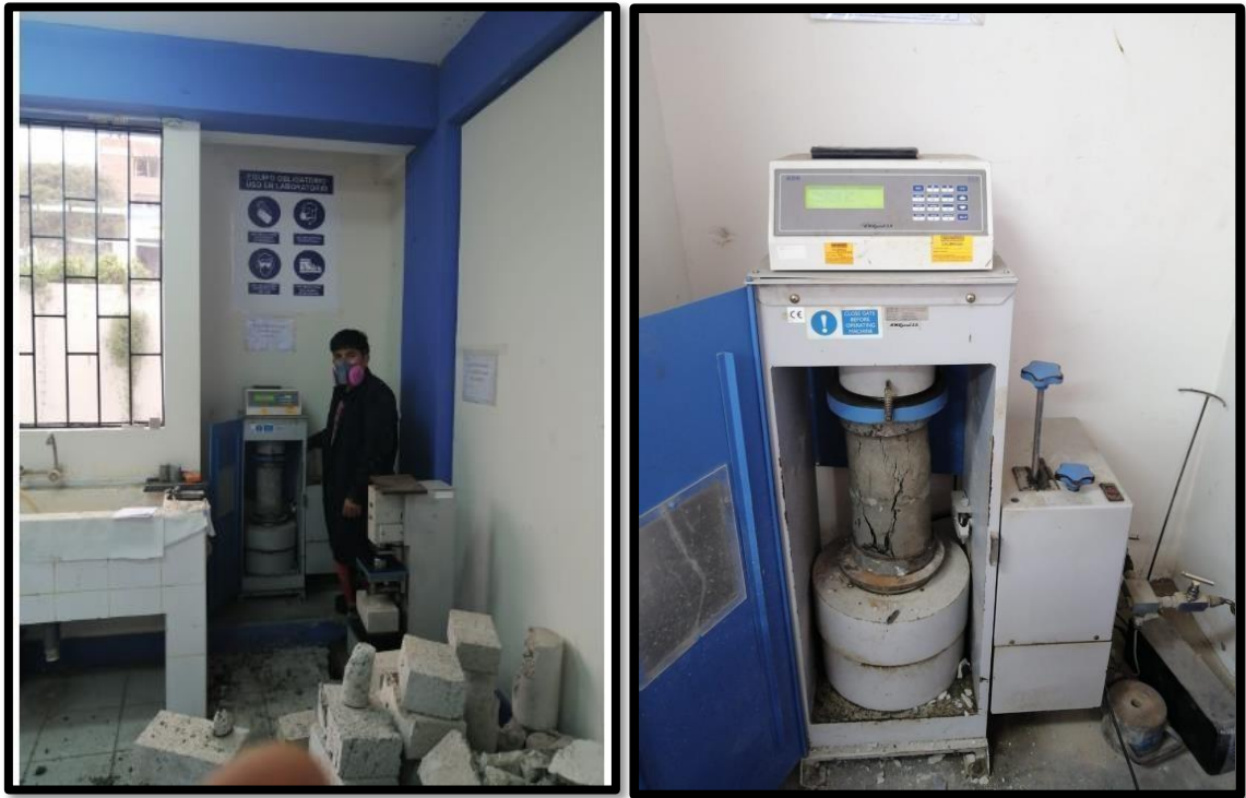
Figura 24. Rotura de testigo
