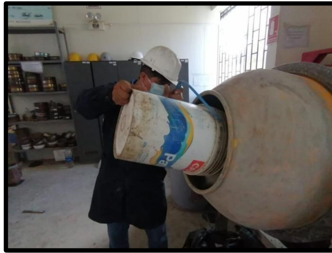
Figura 19. Vaciado del agregado fino al trompo
