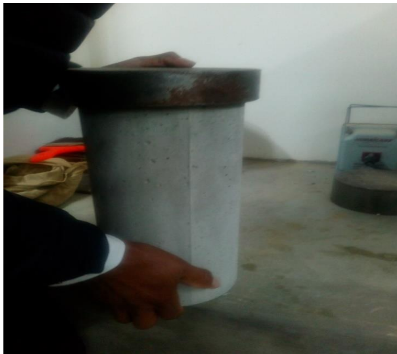
Imagen 40: ubicación de la forma correcta en máquina de rotura.
