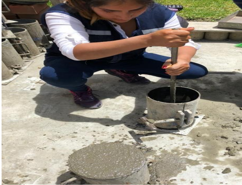
Imagen 19: Coloca en cada capa dando 25 golpes con la varilla de punta redonda y 15 golpes con el martillo de goma.
