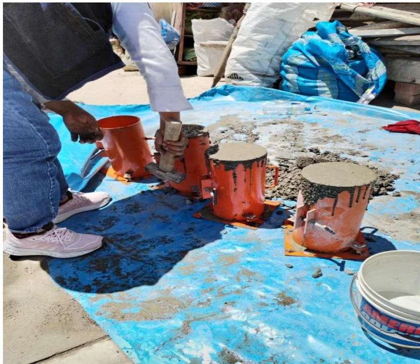
Imagen 32: Eliminación de aire incorporado en las probetas cilíndricas.
