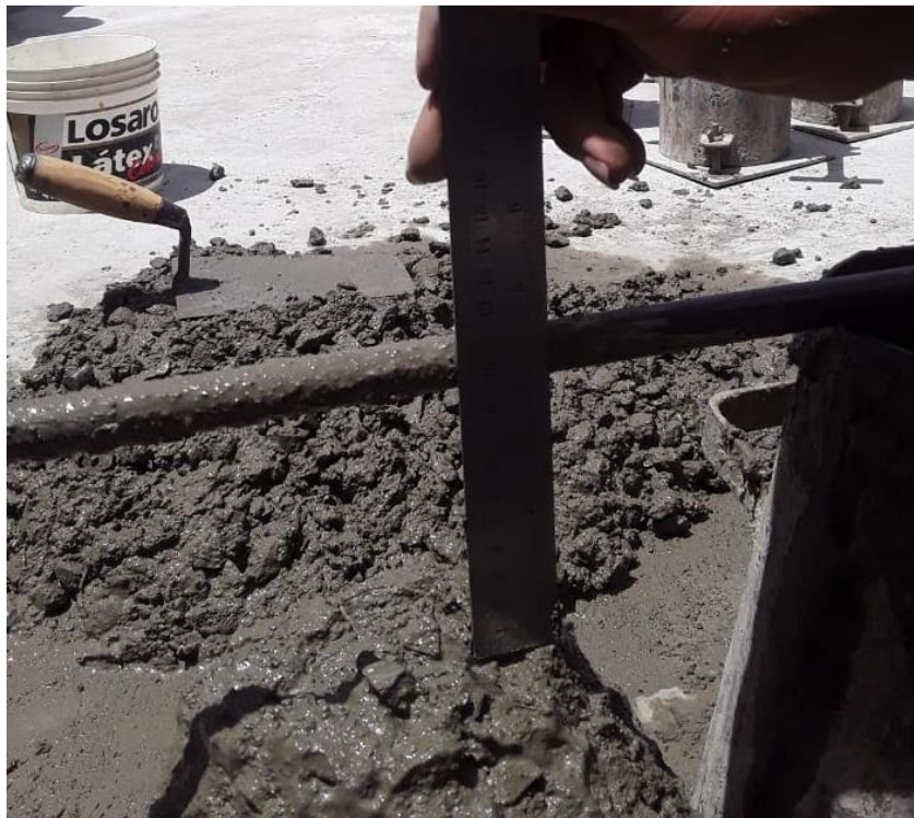
Imagen 16: Ensayo cumple con el asentamiento de 4.5”.
