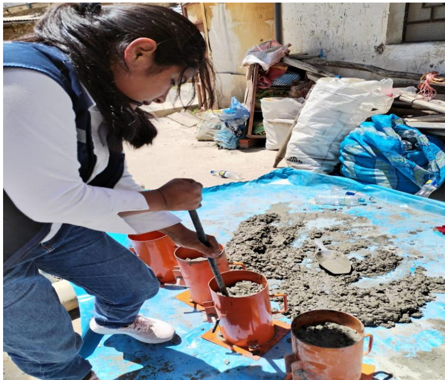
Imagen 30: Varillar cada 3 capas 25 goles para evitar cangrejas
