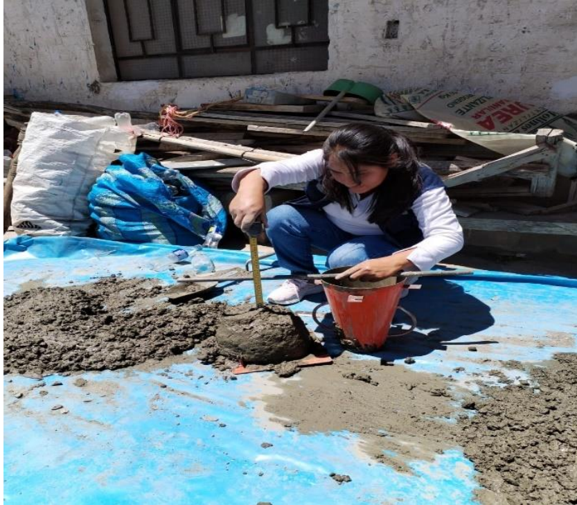
Imagen 27: Ensayo cumple con el asentamiento de 4.5”.
