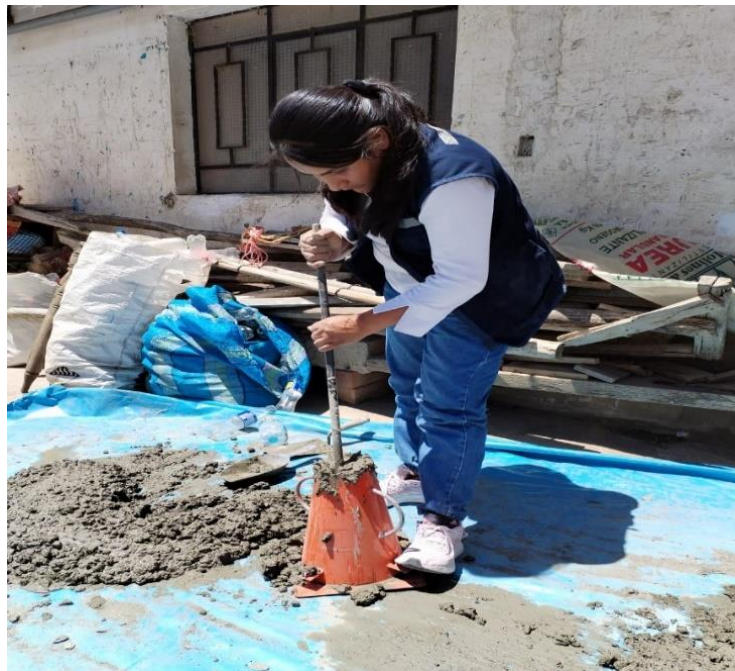
Imagen 34: Ensayo cumple con el asentamiento de 4.5”.
