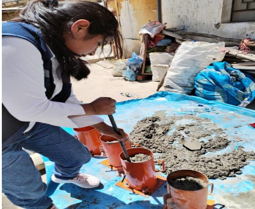
Imagen 31: Coloca en cada capa dando 25 golpes con la varilla de punta redonda y 15 golpes con el martillo de goma.
