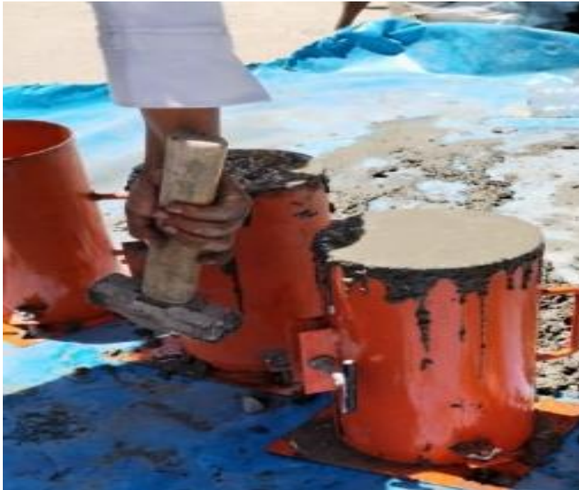
Imagen 36: Eliminación de aire incorporado en las probetas cilíndricas.
