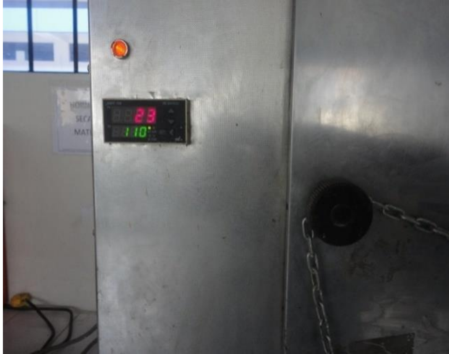
Imagen 7: Ensayo de contenido de humedad, las muestras en el horno 24 hrs.
