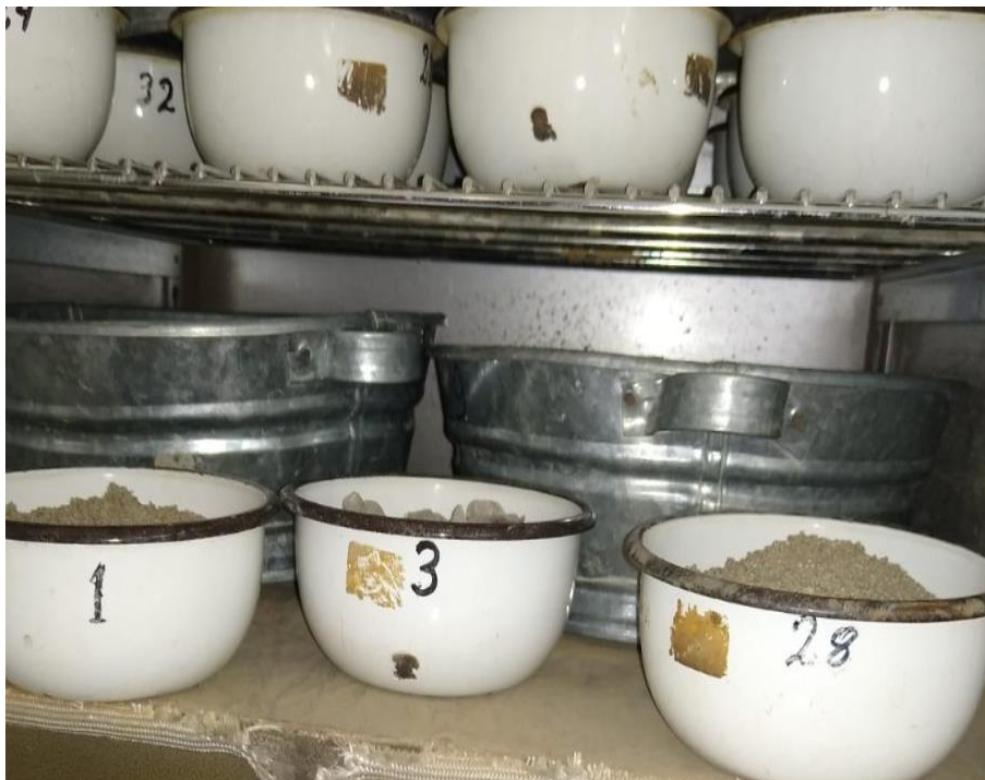
Imagen 8: Ensayo de contenido de humedad en del agregado grueso y agregado fino.
