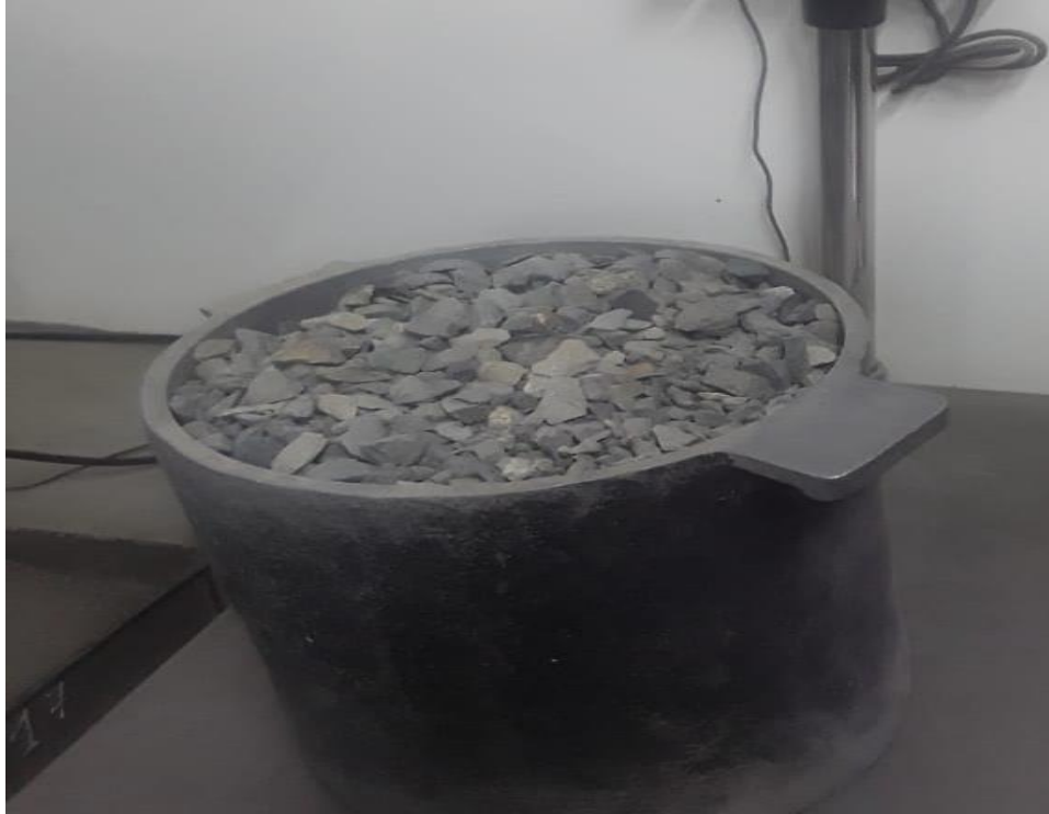
Imagen 11: Ensayo de Pesos Unitarios: Fino (Compactado)
