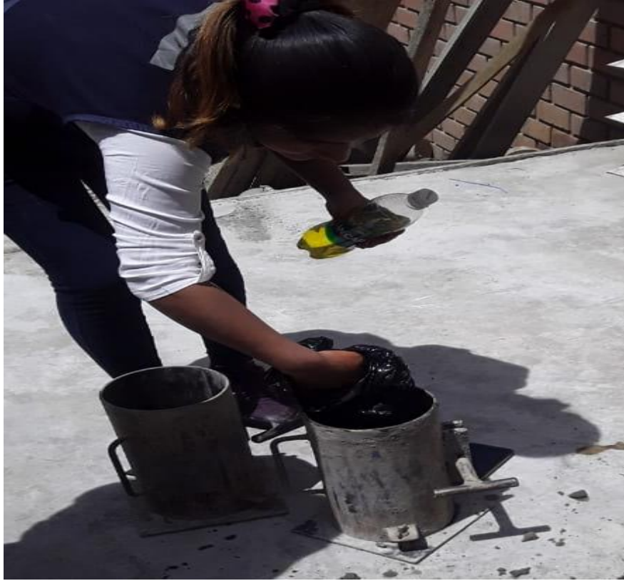
Imagen 17: limpieza de los moldes con petróleo
