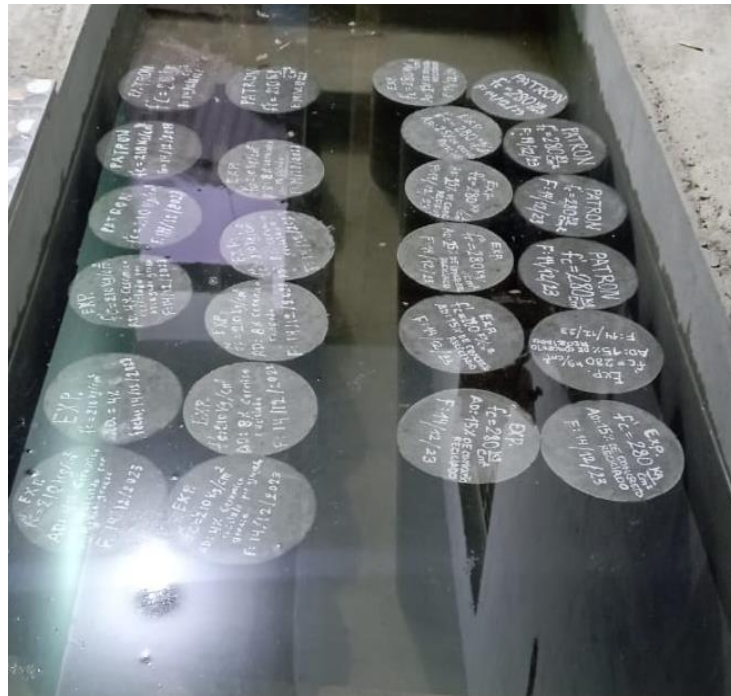
Imagen 38: Curado de las probetas hasta los 28 días
