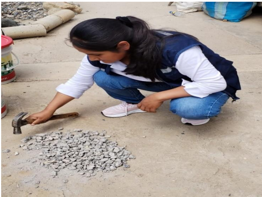
Imagen 6: Se golpea con martillo para que se asemeje al tamaño de las partículas del agregado grueso
