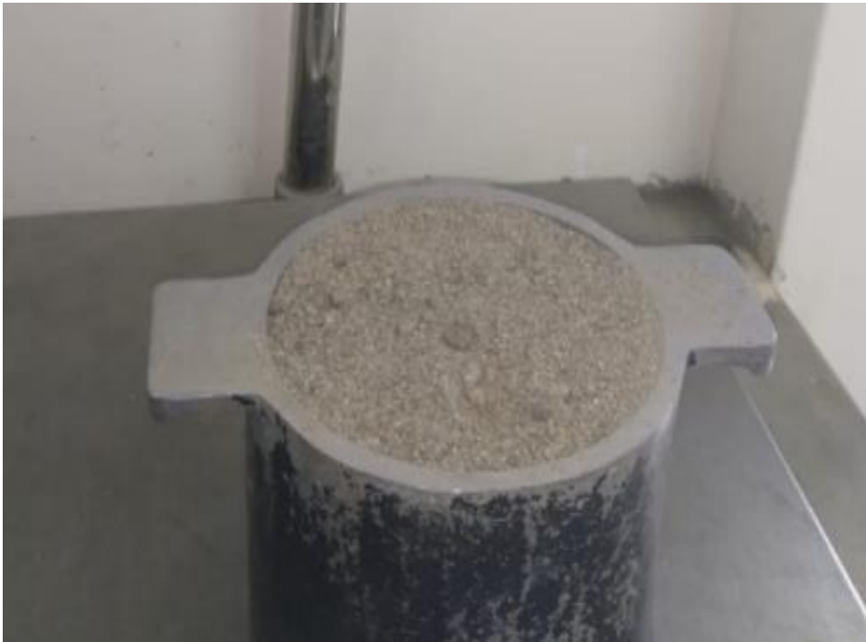
Imagen 12: Ensayo de Pesos Unitarios: Fino (Suelto)
