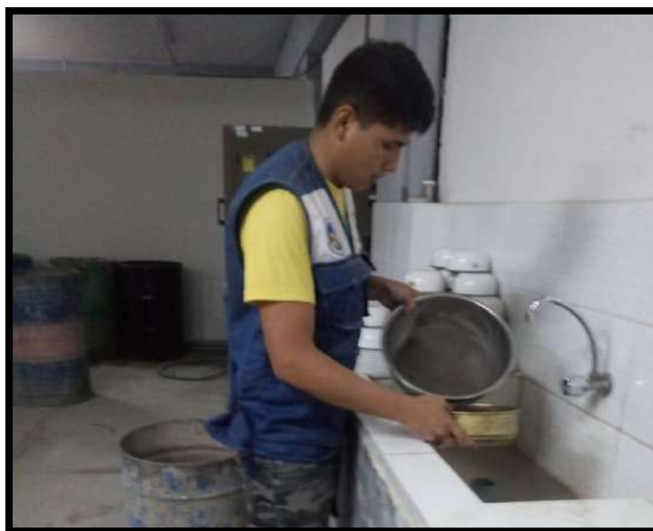
FOTOGRAFÍA N° 12: Se realiza el lavado del agregado fino para poder eliminar el exceso de material orgánico y polvo. Asimismo, determinar la cantidad del material arcilloso.
