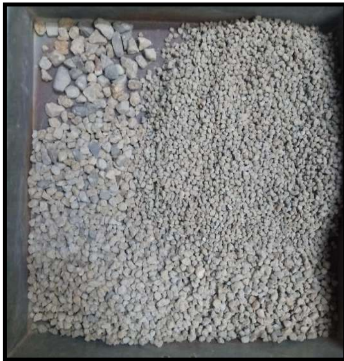
FOTOGRAFÍA N° 11: Se realiza el tamizado del agregado grueso
