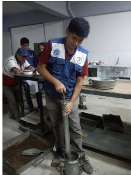
Imagen N° 13: Realización de compactación CBR
