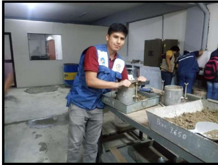
FOTOGRAFÍA N° 17: Se procede a enrazar el material excedente del molde CBR
