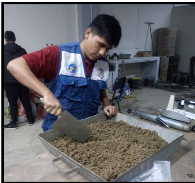
FOTOGRAFÍA N° 15: Luego de obtenidos los resultados de óptima humedad en el proctor estándar, preparamos la muestra del suelo para realizar los ensayos CBR.
