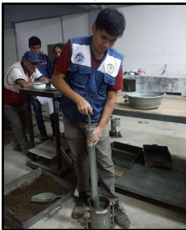
FOTOGRAFÍA N° 16: Se realiza la compactación del suelo en los moldes de CBR
