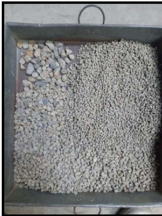
Imagen N° 10: Análisis granulométrico. Material grueso retenido por la malla Nro. 4
