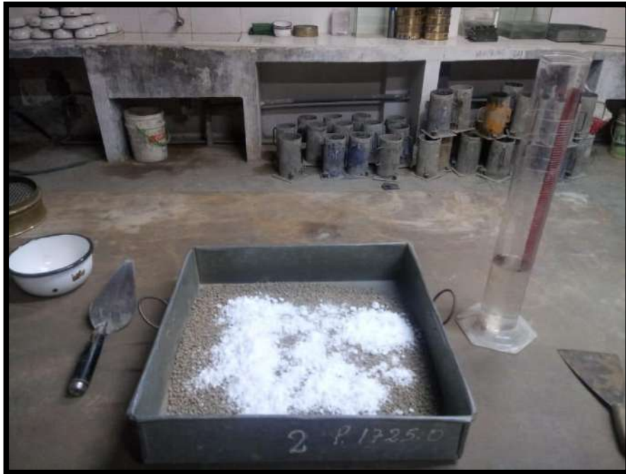
FOTOGRAFÍA N° 20: Se repiten los ensayos de laboratorio: proctor estandar y CBR, dosificando la muestra del suelo con cloruro de sodio en porcentajes de 10% y 20% de tal manera determinar sus nuevas propiedades físicas y mecánicas.
