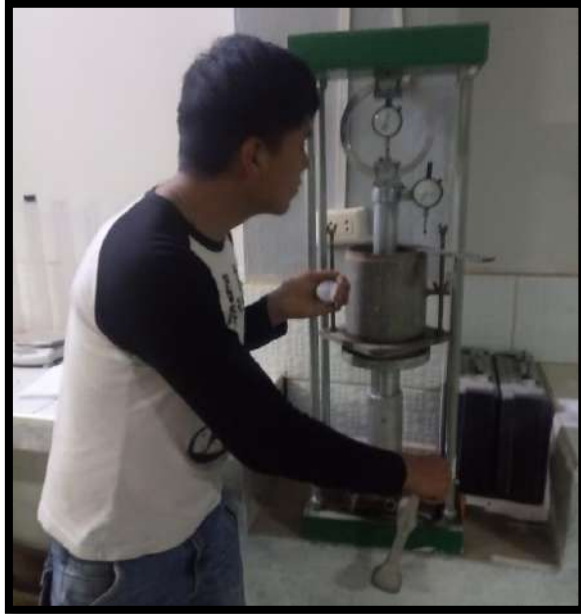
FOTOGRAFÍA N° 19: Se realiza el ensayo de penetración en la máquina compresora manual considerando 1 minuto por cada 0.05" de penetración
