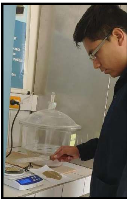
Imagen N° 09: Pesado de muestra representativa para ensayo de pH del suelo natural
