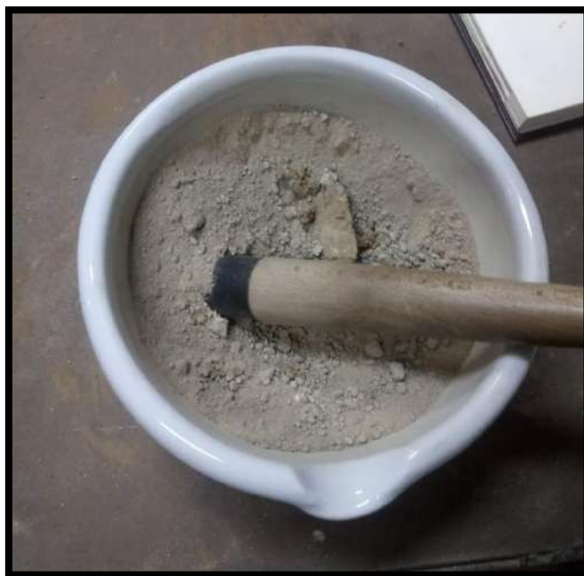
FOTOGRAFÍA N° 06: Se tritura la muestra seca compactada hasta obtener el suelo en sus partículas reales
