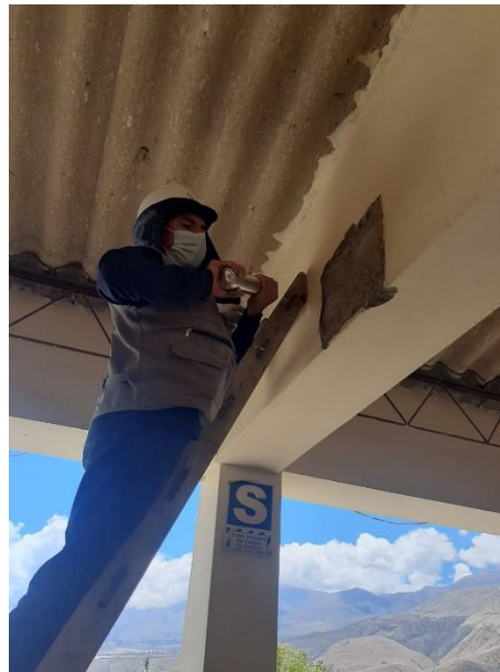
Figura 52. Efectuando los disparos en la viga del pabellon G
