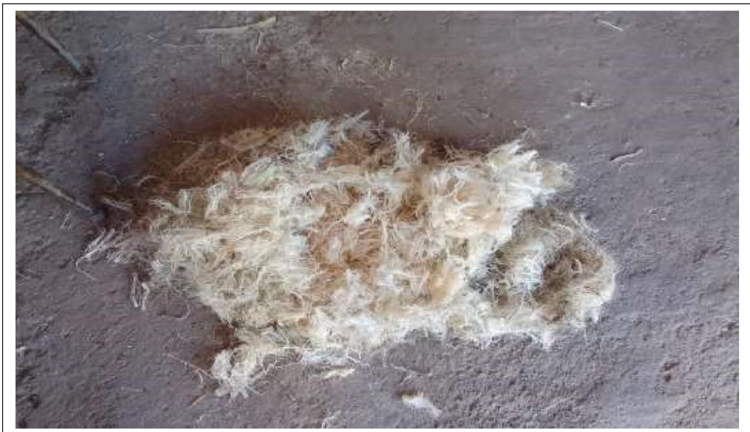
Fotografía N° 04. fibra de maguey cortada a 6– 7cm aprox. Después una semana de secado.
