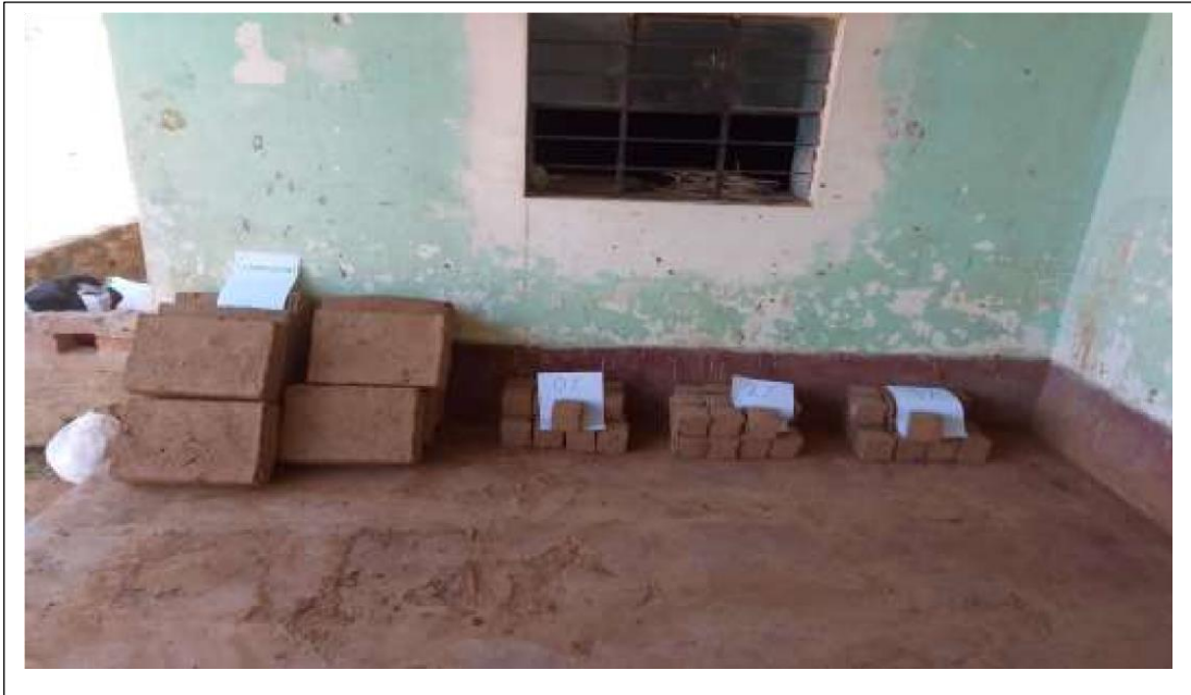
Fotografía N° 22. Remontada de los bloques de adobe par luego a ser ensayadas.
