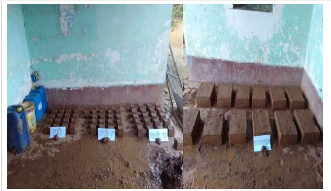
Fotografía N° 20.- Secado del adobe y protección del reflejo directo del sol, para evitar fisuras.
