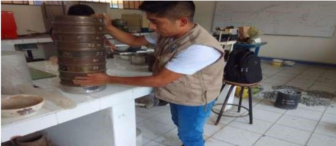
Figura 19. Realizando el ensayo de granulometría por tamizado.
