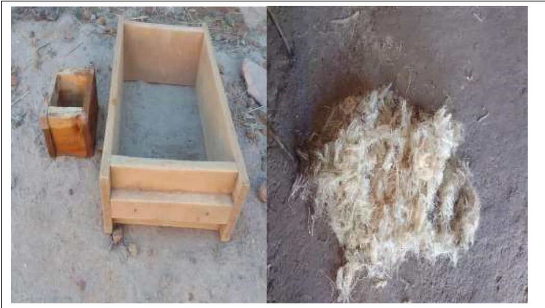
Fotografía N° 14. Imagen de la adobera y la fibra seca de maguey cortadas de 5 a 7 cm.
