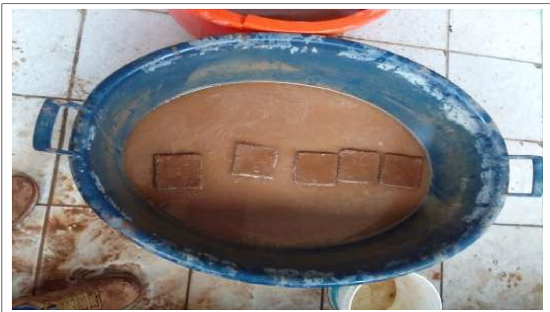
Fotografía N° 32. - Ensayo de resistencia a compresión con 2% de la fibra de maguey.
