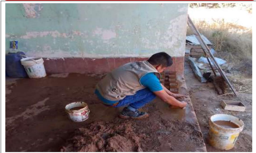
Fotografía N° 18. -Ensayo del puñado de barro hacer una esfera para dejarla caer a un metro del suelo.
