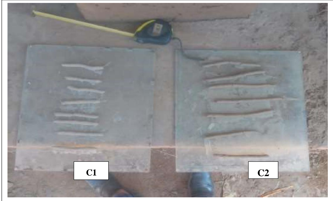
Fotografía N° 09. En la imagen vemos la prueba cinta de 48 horas de secado.
