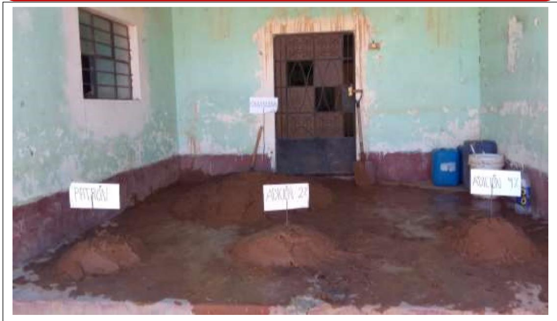
Fotografía N° 16. Mezcla homogénea de la fibra de maguey, suelo seco y agua para los cuatro respectivos tratamientos.
