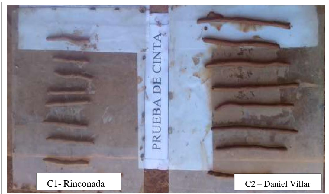
Fotografía N° 07. Prueba de la cinta para ambas canteras.
