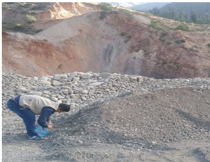
Figura 17: Extracción y selección del afirmado de muestra de cantera de Rio San Miguel para estudios en en Laboratorio de Mecanica de Suelos USP- Chimbote
