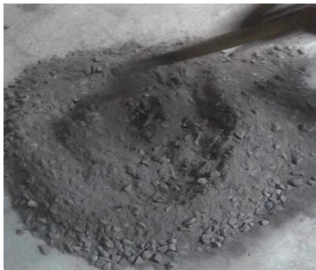
Figura 13: cuarteo de muestras en Laboratorio de Mecanica de Suelos USP- Chimbote
