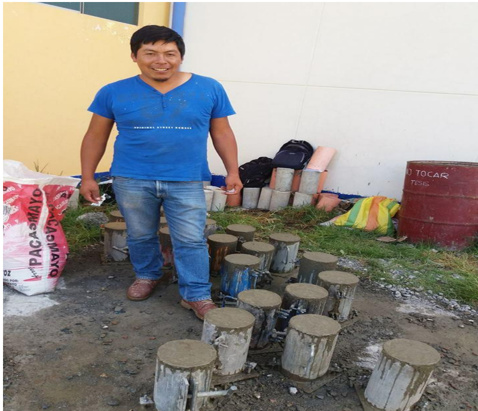
FOTOGRAFÍA N° 04. Llenado las probetas con concreto.
