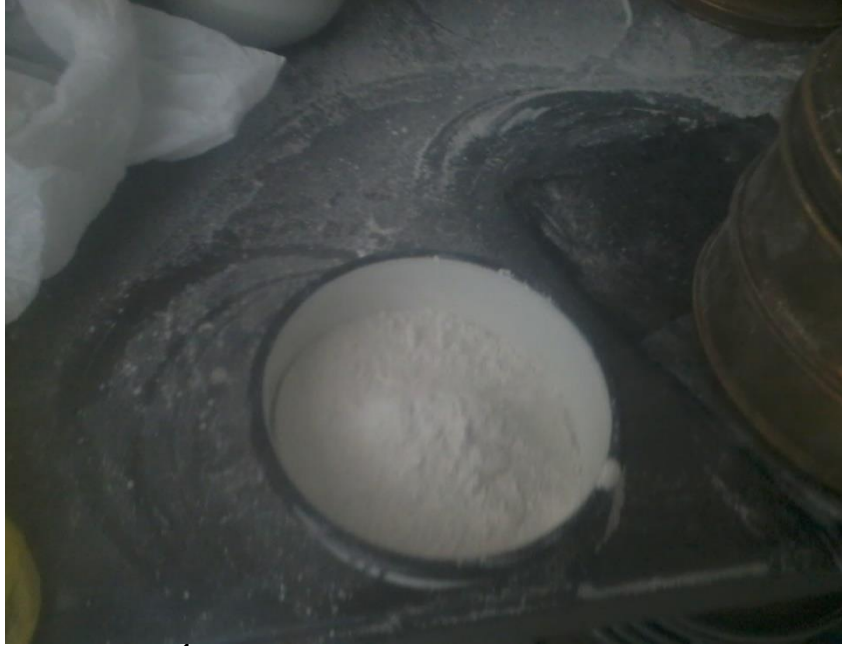
FOTOGRAFÍA N° 01. Lavado y secado para tamizar la el caolín
