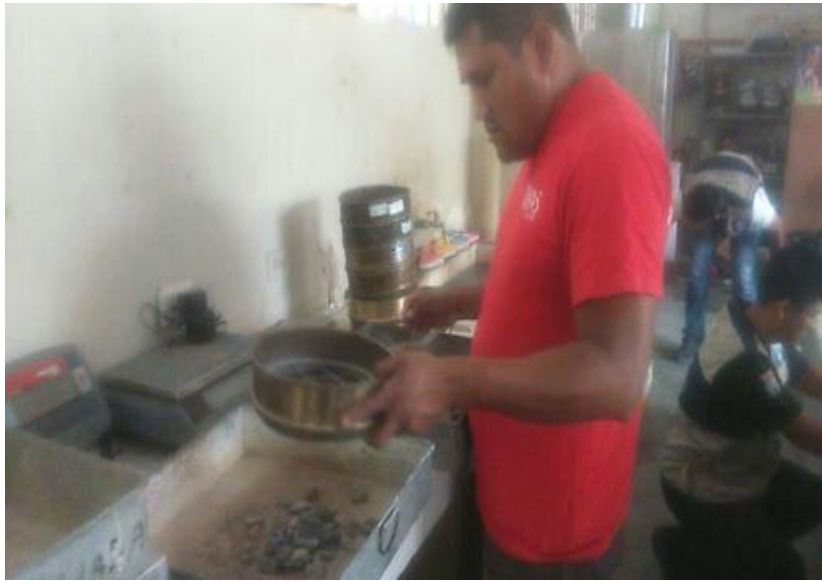
Foto n° 4: Trabajos en Laboratorio del agregado (ensayo de granulometría).
