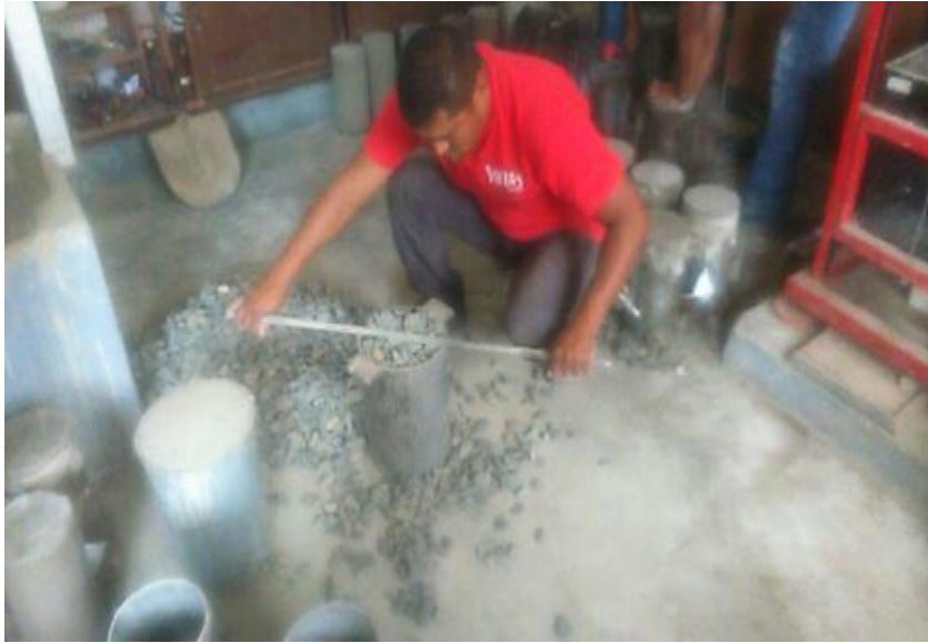
Foto n° 5: Trabajos en Laboratorio del agregado (ensayo de Peso Unitario Compactado).
