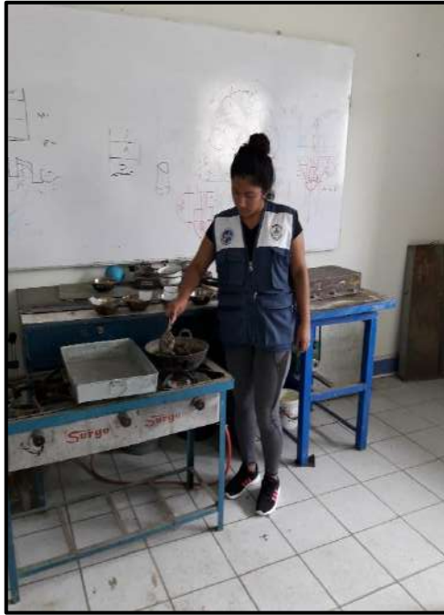
Figura 24. Secado de material en una cocina industrial.
