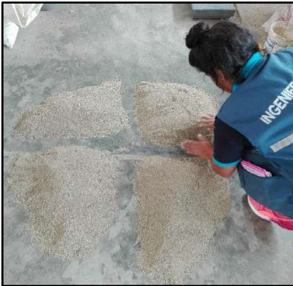
Figura 22. Cuarteo de agregado fino (arena).
