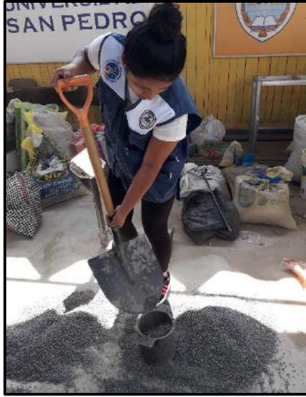
Figura 13. Llenando el molde con confitillo.
