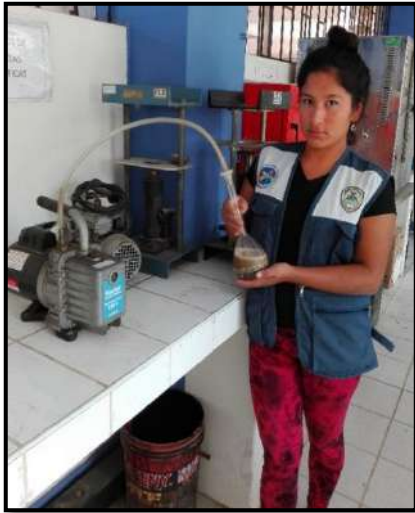
Figura 31. Picnómetro con fiola, arena y agua, para que observa los vacíos que hay en el fondo.
