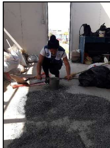
Figura 16. Enrasado, al término de las tres capas.
