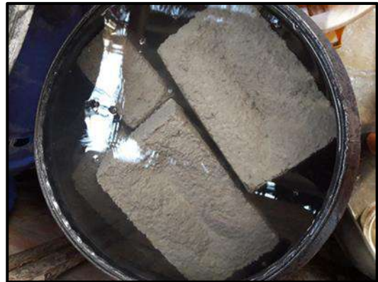
Figura 38. Ladrillos de concreto sumergido en un recipiente con agua para ser sumergido.
