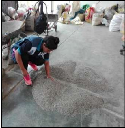
Figura 20. Cuarteo del material (confitillo)
