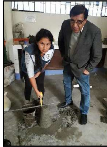
Figura 32. Ensayo de cono de abrams, supervisado por mi asesor.
