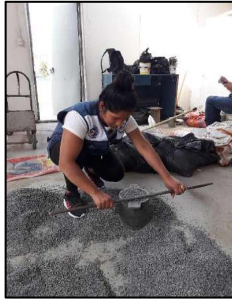
Figura 14. Enrasando el confitillo.
