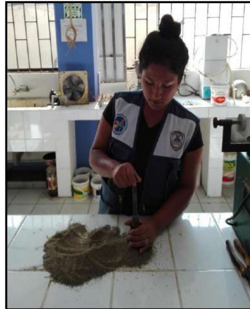
Figura 30. Prueba, para que este el material superficial seco.
