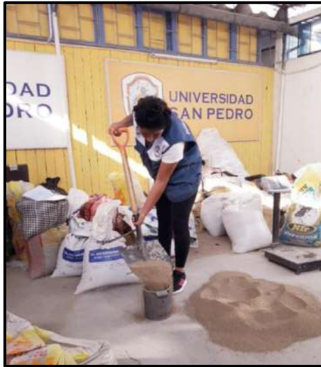
Figura 17. Llenando el molde con arena.
