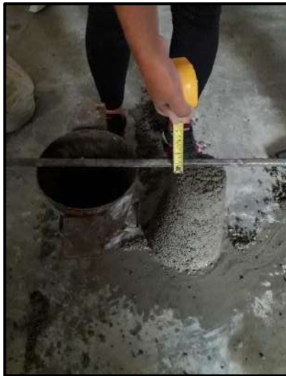
Figura 33. Medida con una wincha el asentamiento que obtuvo es 1".
