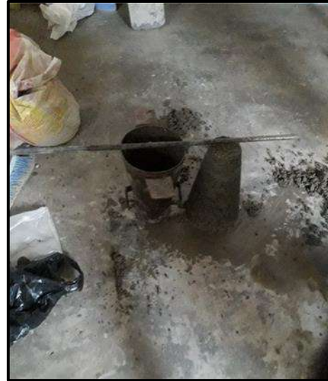
Figura 40. Cono de abrams con un asentamiento de 1”.
