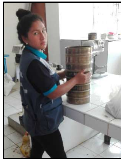
Figura 23. Tamizado de la arena.
