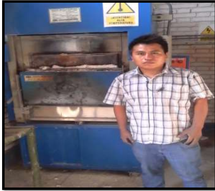
FOTO N° 13: Incineración en mufla a 450 °C por tres horas.
