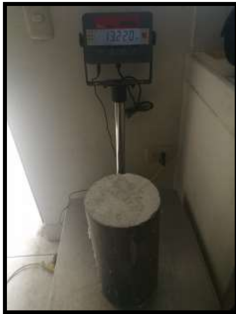
FOTO N° 40: Peso Probetas Patrón, para ser ensayadas a Compresión (7días de curado)
