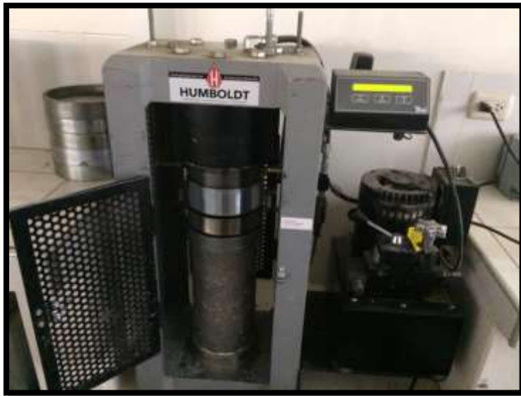
FOTO N° 43: Rotura de probeta patrón (28 días de curado)
