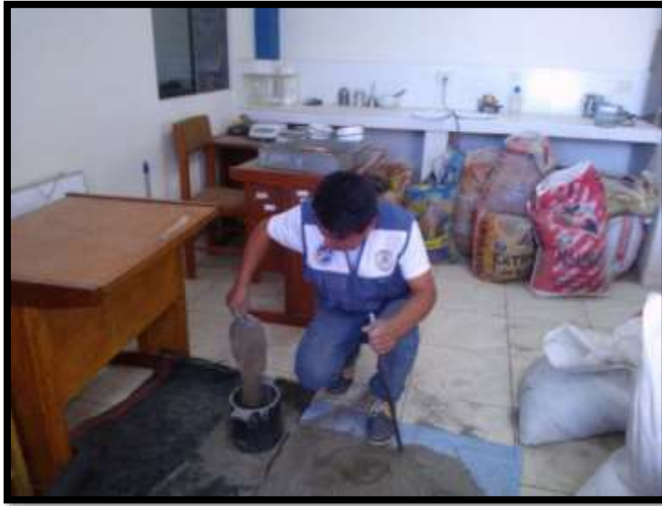
FOTO N° 25: Ensayo de Peso Unitario de los agregados
