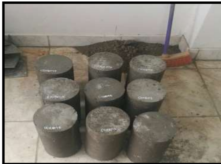
FOTO N° 46: Desencofrado de las Probetas Experimentales (3% sustitución del cemento)
