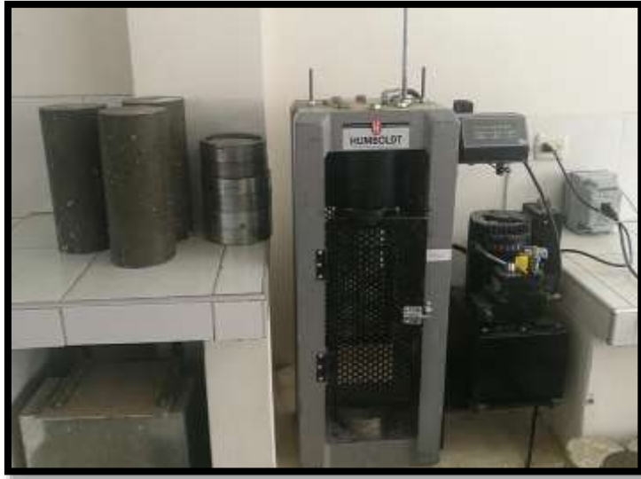
FOTO N° 39: Probetas Patrón secando, para ser ensayadas a Compresión (7días de curado)
