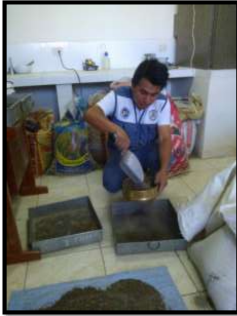
FOTO N° 23: Tamizado del agregado fino por la malla N° 4
