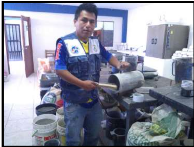
FOTO N° 28: Limpieza de moldes de especímenes de concreto con Cepillo de fierro.
