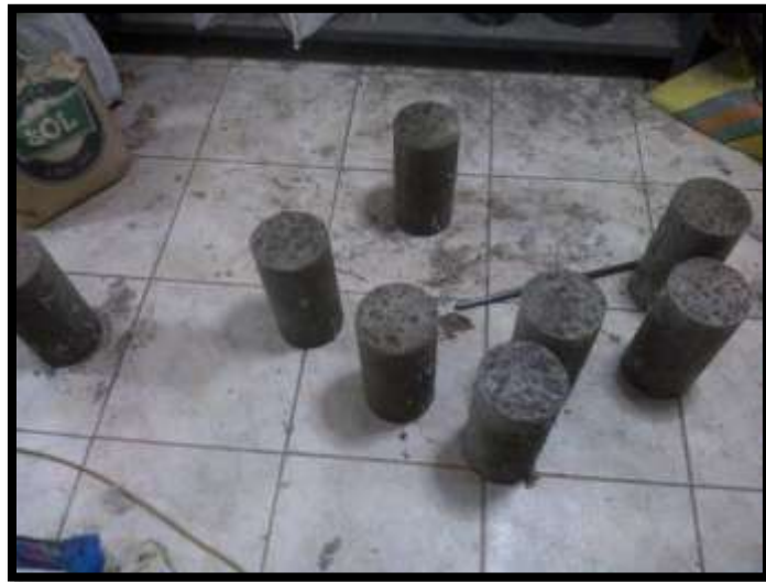
FOTO N° 36: Desencofrado de especímenes de concreto después de 18 horas.
