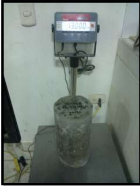
FOTO N° 37: Pesado después de desencofrar los especímenes de concreto.
