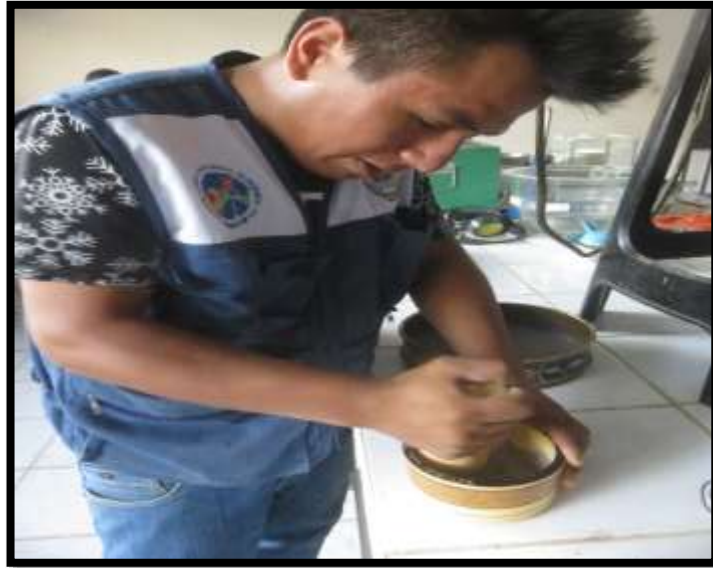
FOTO N° 17: Activación mecánica de la ceniza de hoja de pino (Pinus Radiata).
