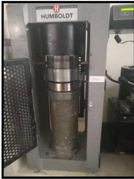
FOTO N° 41: Rotura de probeta patrón (7 días de curado)
