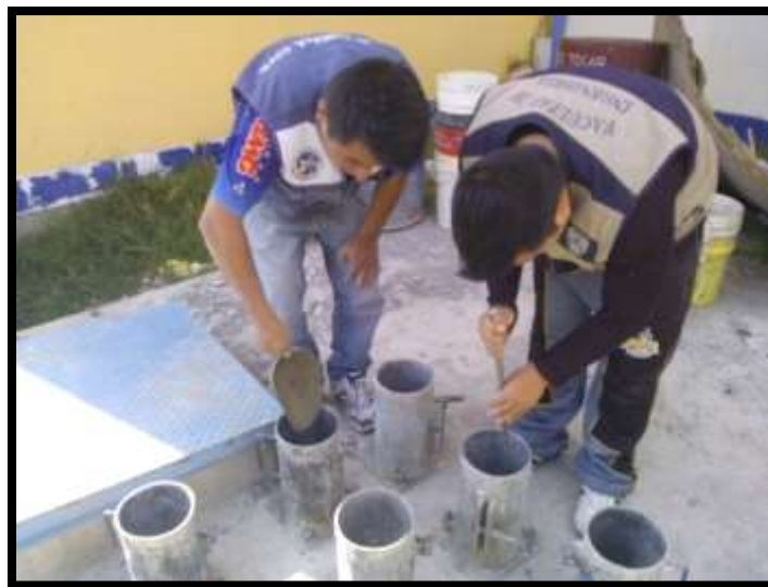
FOTO N° 34: Llenado de especímenes de concreto, en tres capas con 25 varillados de compactación por cada capa y 10 golpes con el martillo de goma por cada capa.
