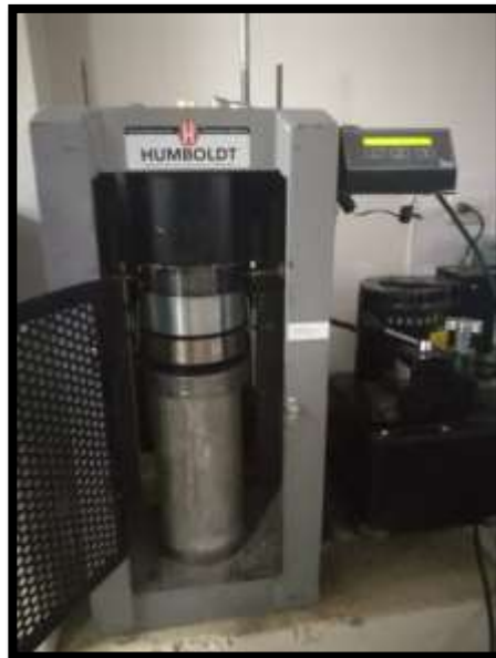
FOTO N° 48: Ensayo a compresión de Probetas Experimentales (3% sustitución del cemento)
