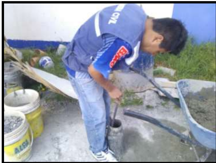
FOTO N° 32: Prueba de asentamiento del concreto (Slump).
