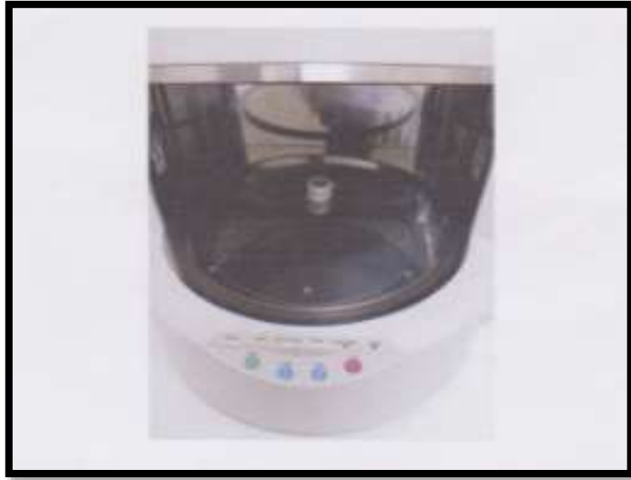
FOTO N° 21: Muestra en el espectrómetro de Fluorescencia de Rayos X.
