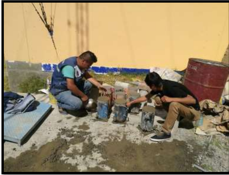
FOTO N° 45: Elaboración de las Probetas Experimentales (3% sustitución del cemento)
