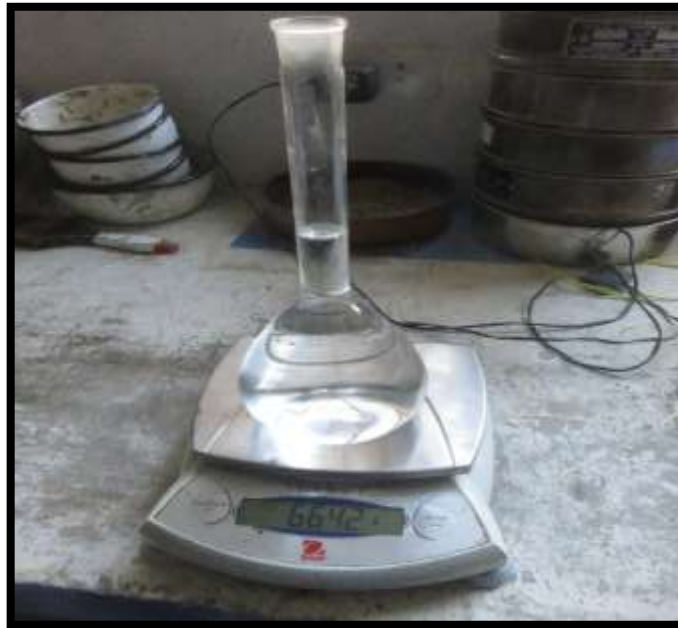
FOTO N° 26: Ensayo de Gravedad Especifica y absorción de los agregados
