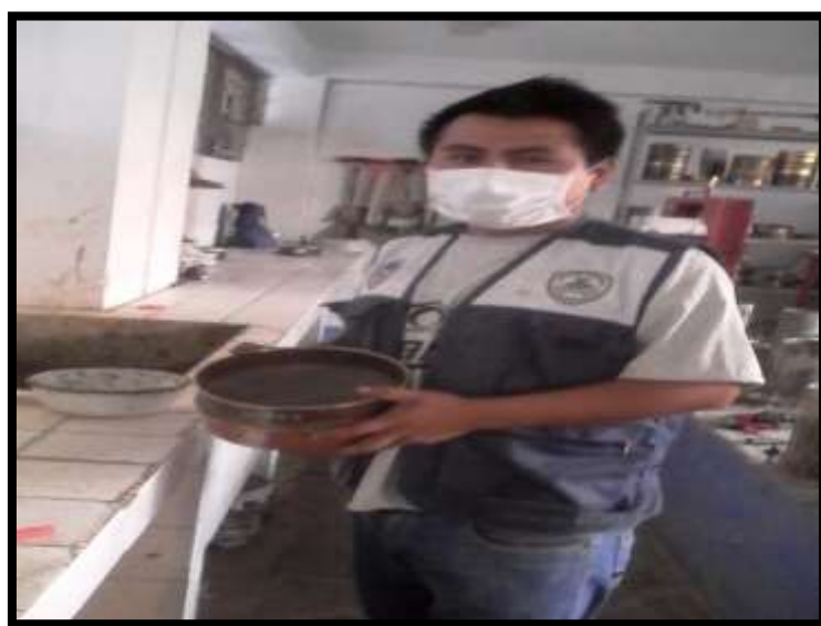
FOTO N° 16: Tamizado de la ceniza calcinada de hoja de Pino, por la malla # 200, para la obtención de su máxima finura (75 \mu\text{m} ).
