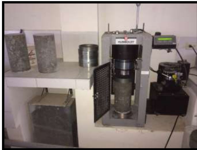
FOTO N° 42: Rotura de probeta patrón (14 días de curado)
