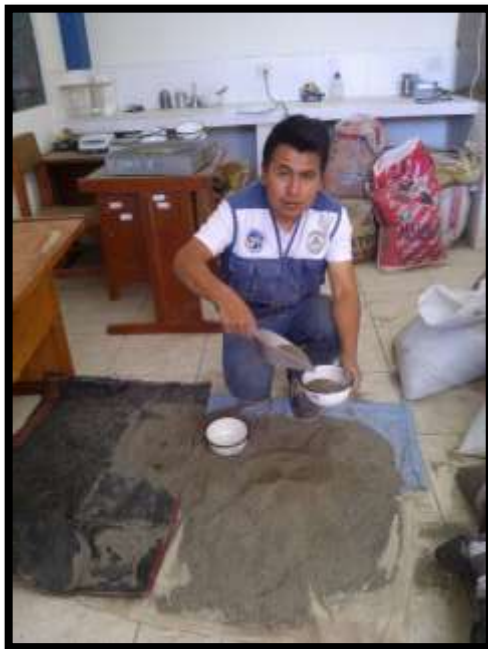
FOTO N° 24: Ensayo de Contenido de Humedad de los agregados.
