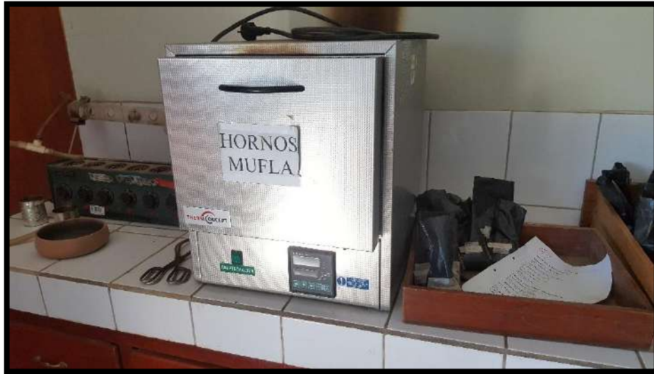
Foto 3: Quemado de la hoja de eucalipto – Horno Mufla a 750° por 1 hora Fuente: Elaboración propia
