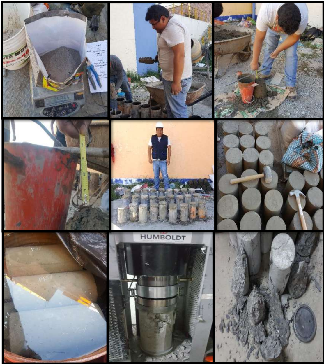
Figura 26: Paso a Paso Elaboración de Concreto f'c=210\text{kg/cm}^2 Fuente: Elaboración Propia
