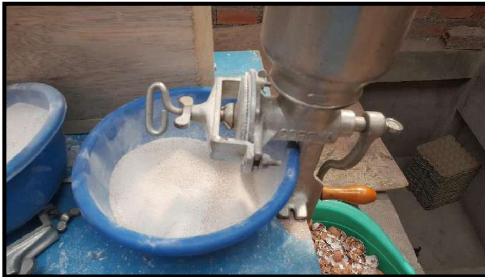
Foto 4: Molido de Cáscara de huevo Fuente: Elaboración propia
