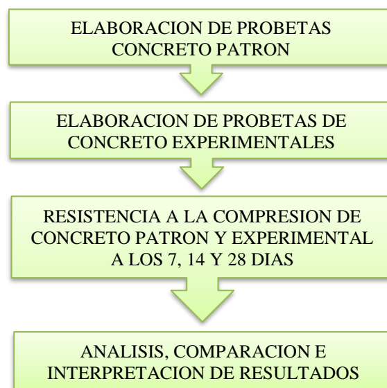
Figura 23: Esquema para elaboración de concreto Fuente: Elaboración Propia
