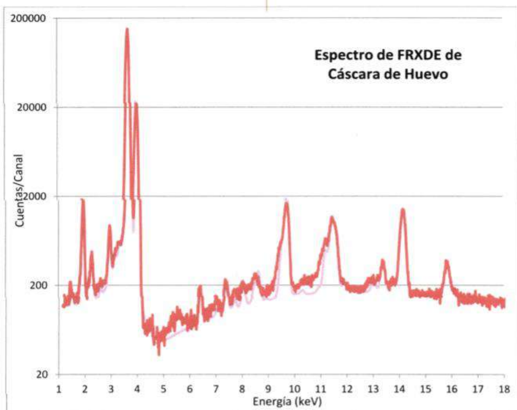
Figura 11: Espectro de FRXDE de Cáscara de Huevo molido Fuente: Informe N°113-LAQ/2018- Análisis FRXDE_ Fac. Ciencias Físicas- UNMSM
