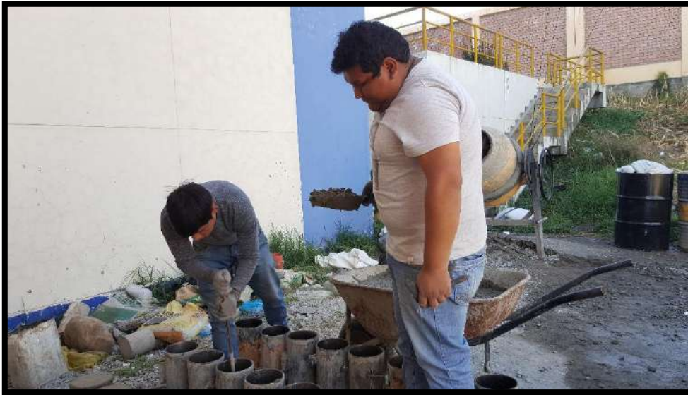
Foto 9: Elaboración de probetas de concreto f'c=210\text{kc/cm}^2 Fuente: Elaboración propia
