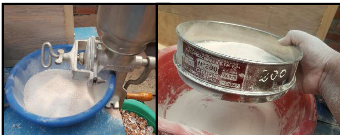
Figura 10: Molido y Tamizaje de Cáscara de huevo Fuente: Elaboración Propia
