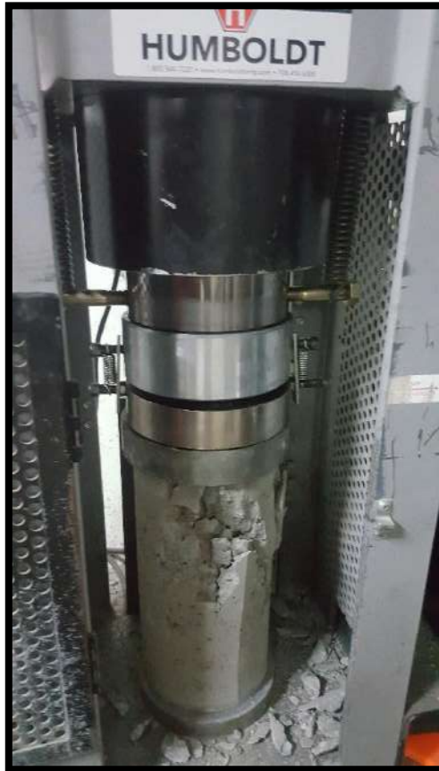
Foto 14: Prueba de probetas a compresión Fuente: Elaboración propia
