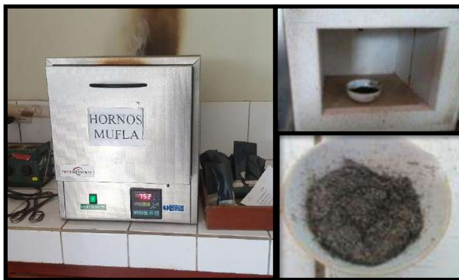
Figura 17: Proceso de quemado de la hoja de eucalipto Fuente: Elaboración propia
