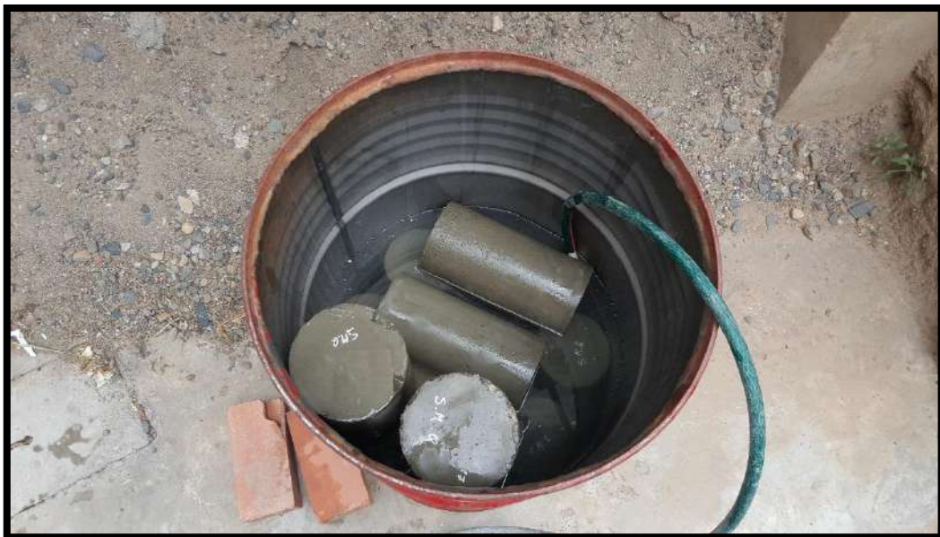
Foto 14: Probetas en etapa de curado Fuente: Elaboración propia
