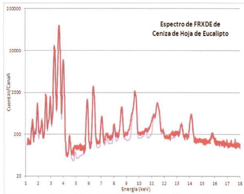
Figura 1. Espectro de FRXDE de ceniza de hoja de eucalipto en escala semi-logarítmica. Incluye el pico de Ar del aire y los picos de rayos-X de Au dispersados por la muestra. La curva en azul muestra el espectro simulado
