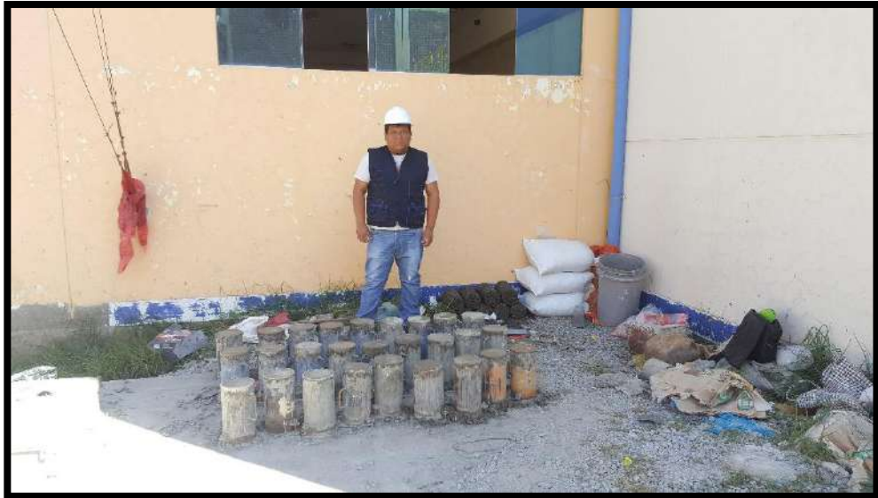
Foto 12: Desencofrado de Probetas Fuente: Elaboración propia
