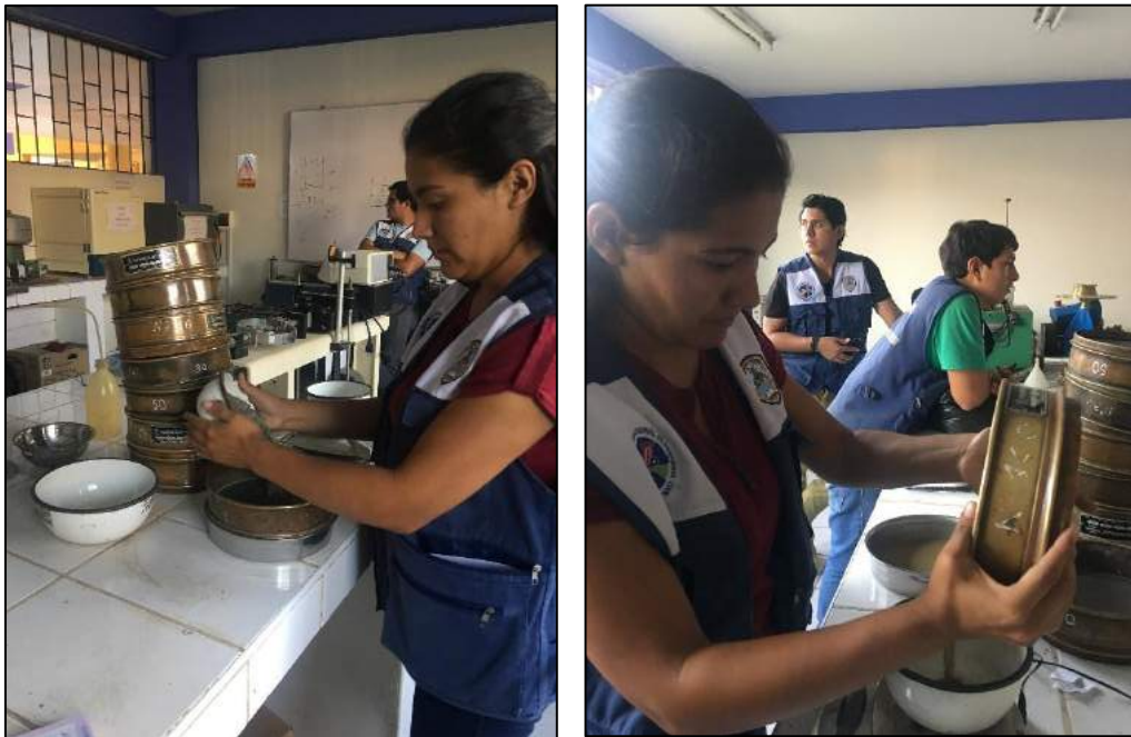
FIGURA N° 12 y 13: Ensayo de Granulometría de la Arena y el Confitillo Fuente: Propia
