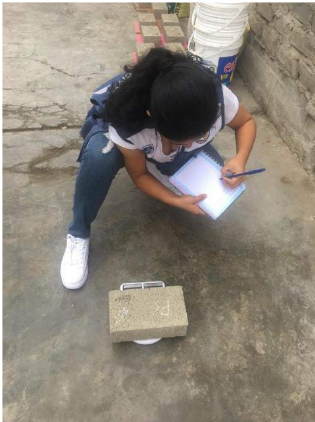
FIGURA N a 73: Medición y peso de los ladrillos experimentales Fuente: Propia
