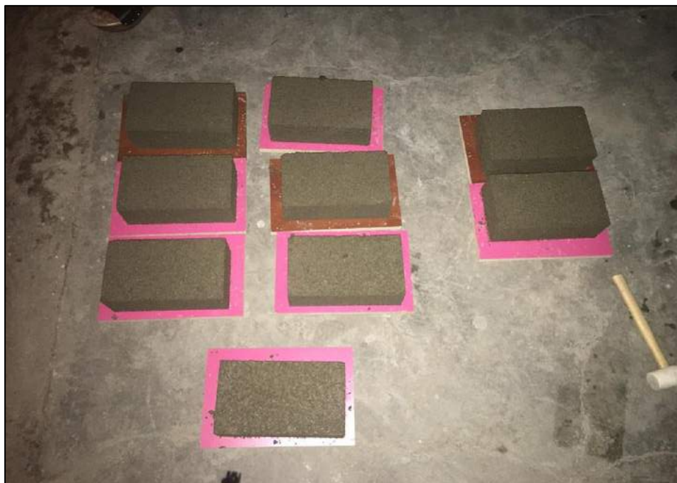
FIGURA N° 54, 55 y 56: Desmolde de los ladrillos, finalmente obteniéndose los 9 ladrillos patrón. Fuente: Propia
