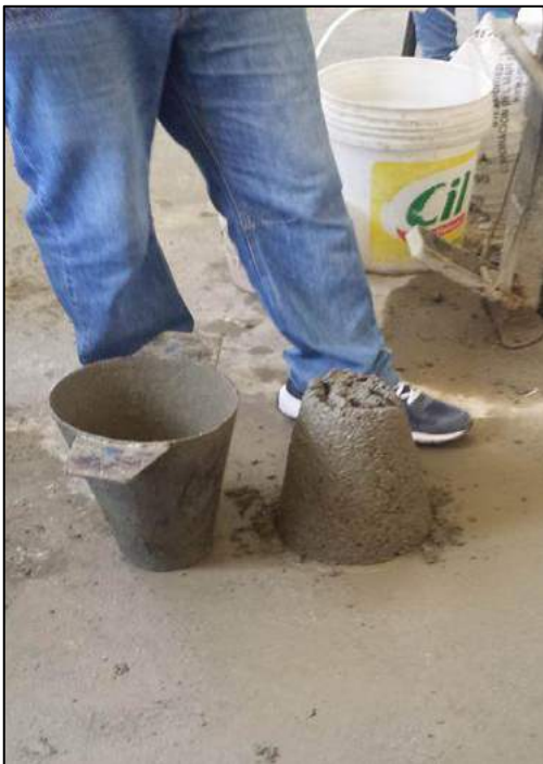
FIGURA N° 35: Prueba de Slump de la Mezcla Patrón Fuente: Propia
