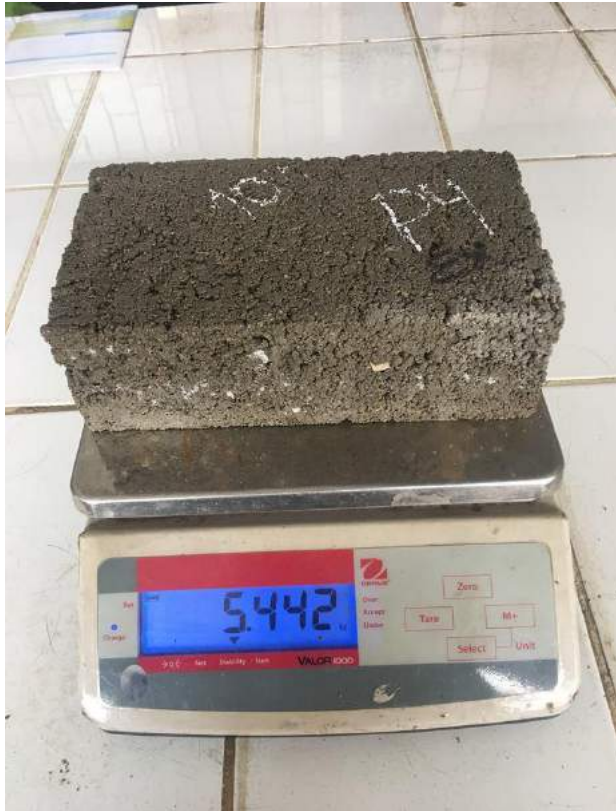
FIGURA N° 78: Ladrillo experimental L-4 con sustitución del 10% Fuente: Propia
