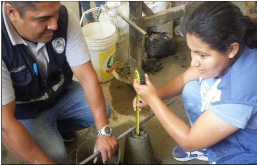
FIGURA N° 37: Se observa la medida del asentamiento, el cual resulto 1.50, cumpliendo así con el rango esperado. Fuente: Propia
