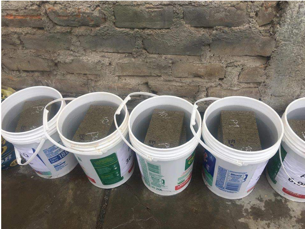
FIGURA N o 76: Curado de los ladrillos experimentales Fuente: Propia
