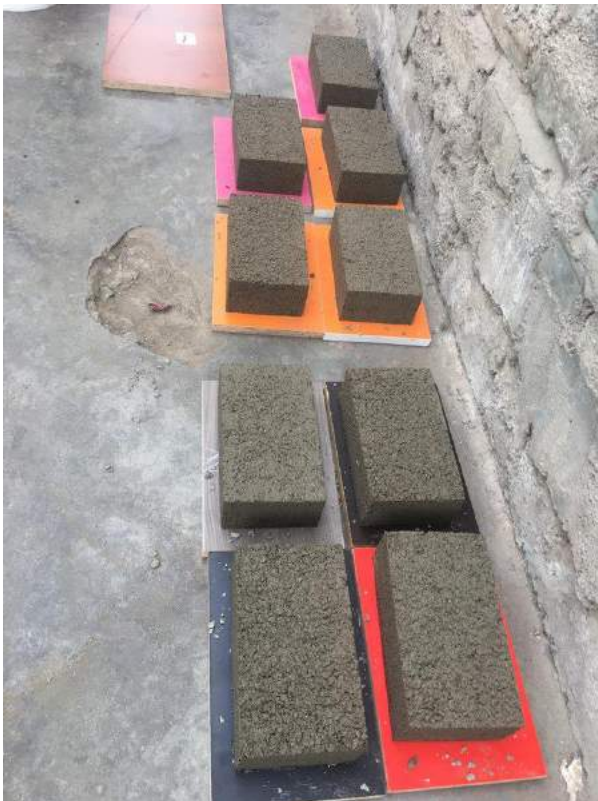
FIGURA N° 71: Ladrillos experimentales al 10% de sustitución de roca zeolita Fuente: Propia
