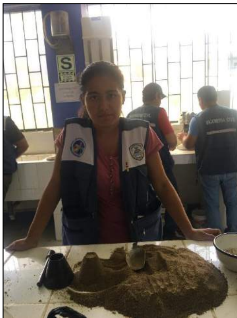
FIGURA N° 27: Arena superficialmente seca Fuente: Propia
