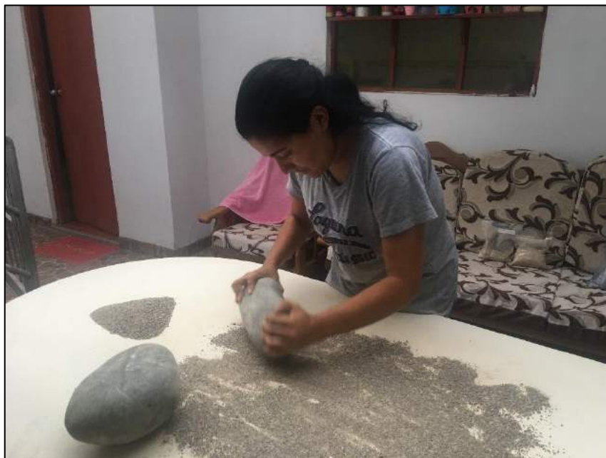
FIGURA N° 43: Trituración de las rocas zeolitas con la ayuda de un batan Fuente: Propia
