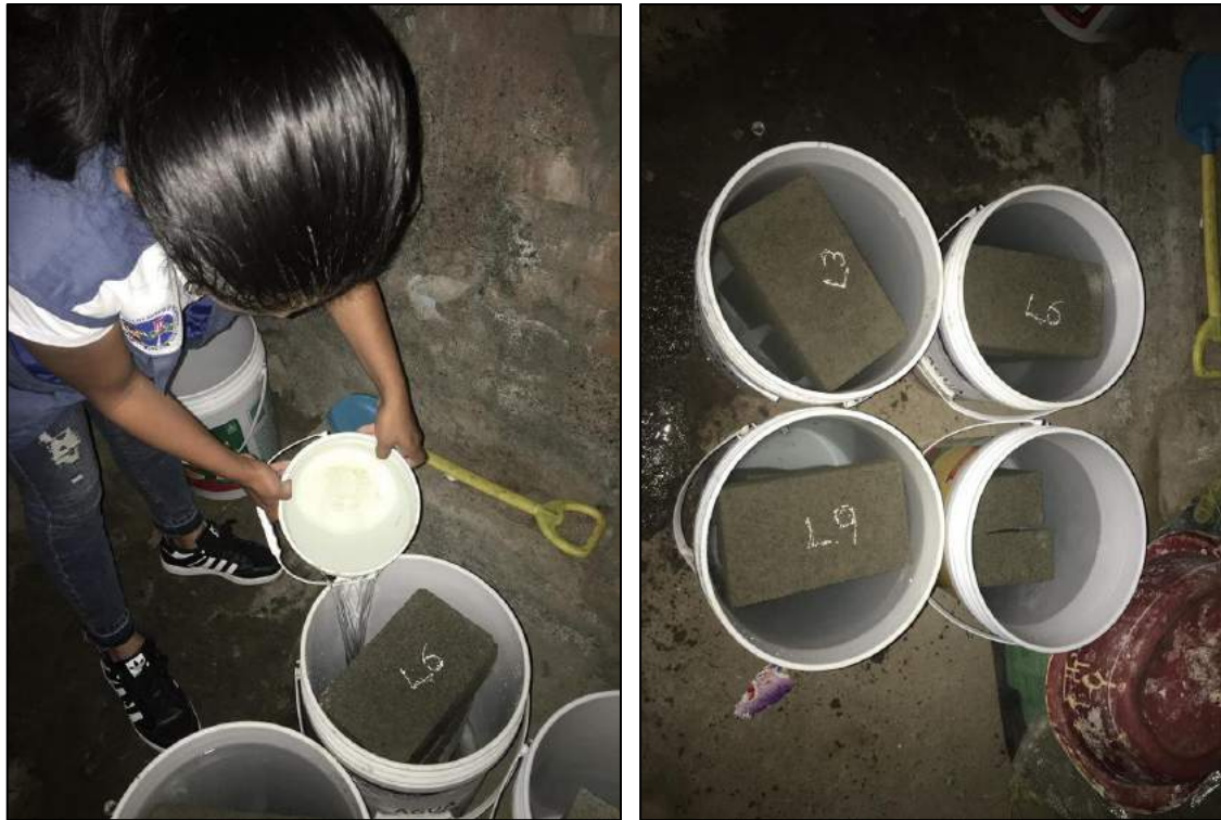
FIGURA N° 61 y 62: Curado de los ladrillos de concreto. Fuente: Propia
