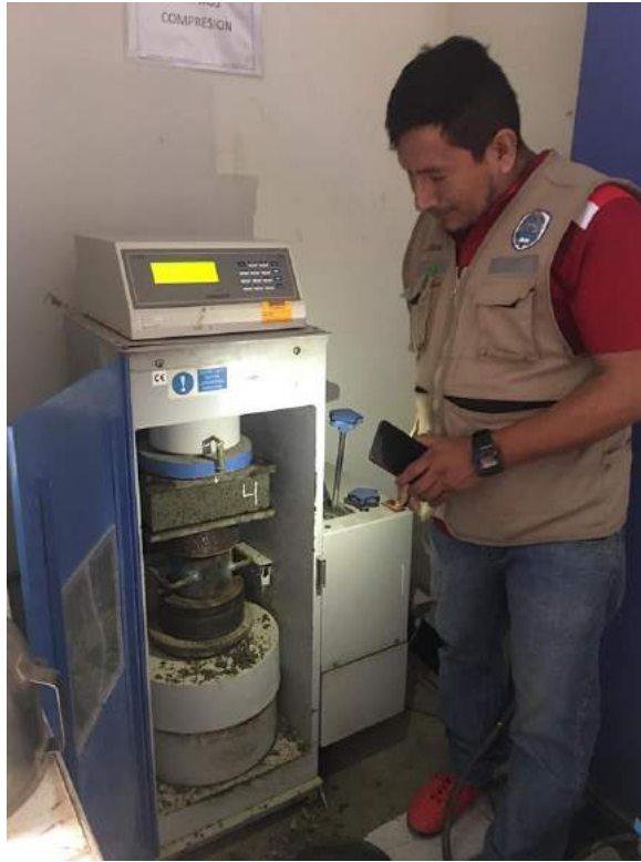
Figura 66: Se observa al Técnico Johan supervisando el ensayo a compresión de los ladrillos de concreto patrón. Fuente: Propia
