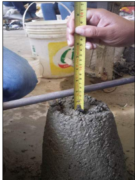
FIGURA N° 36: Medida del Asentamiento Fuente: Propia
