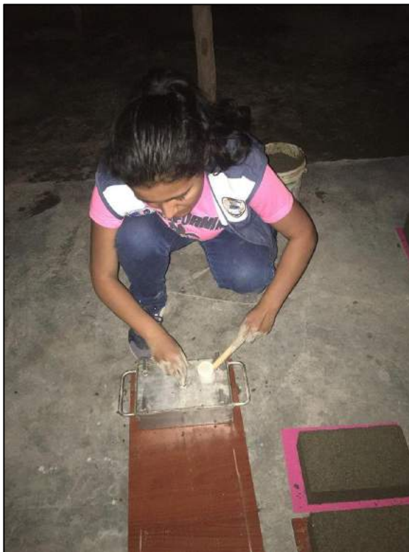
FIGURA N° 51, 52 y 53: Elaboración de los 9 ladrillos patrón. Fuente: Propia
