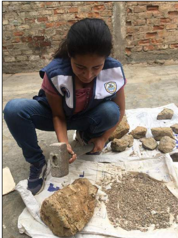
FIGURA N° 42: Trituración de las rocas zeolitas con la ayuda de la comba Fuente: Propia
