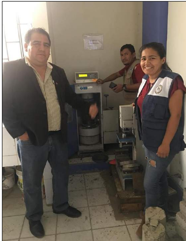
Figura 65: Se observa al Ing. Rubén López Carranza supervisando el inicio del ensayo a compresión de los ladrillos de concreto patrón a los 7, 14 y 28 días.
