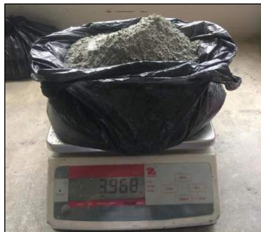
FIGURA N° 32: Peso del cemento Portland tipo I Fuente: Propia
