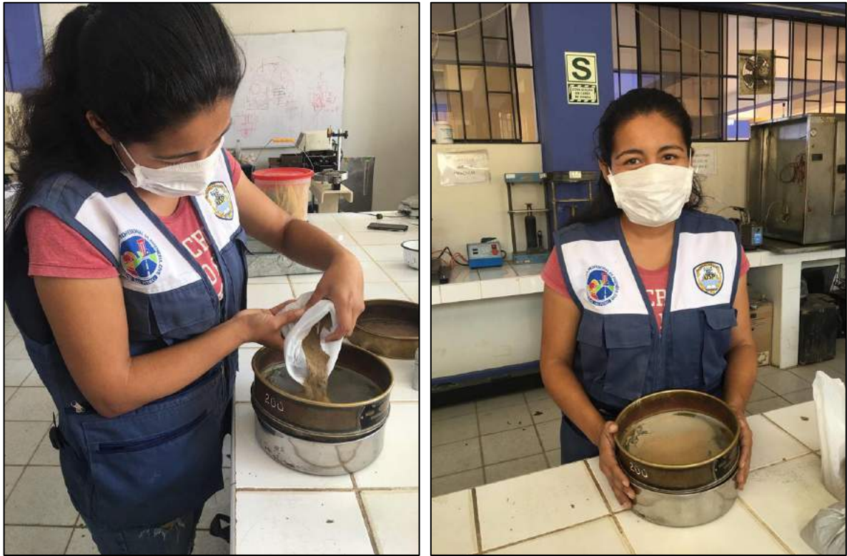
FIGURA N° 44 y 45: Tamizando por la malla N° 200 el polvo de la roca zeolita Fuente: Propia
