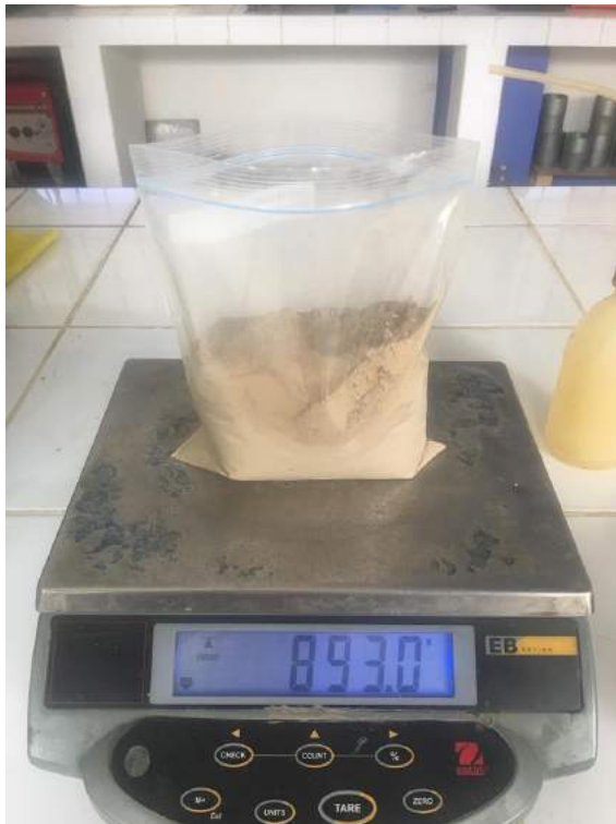
FIGURA Nª 67: Polvo de Roca Zeolita para la sustitución del 10% Fuente: Propia
