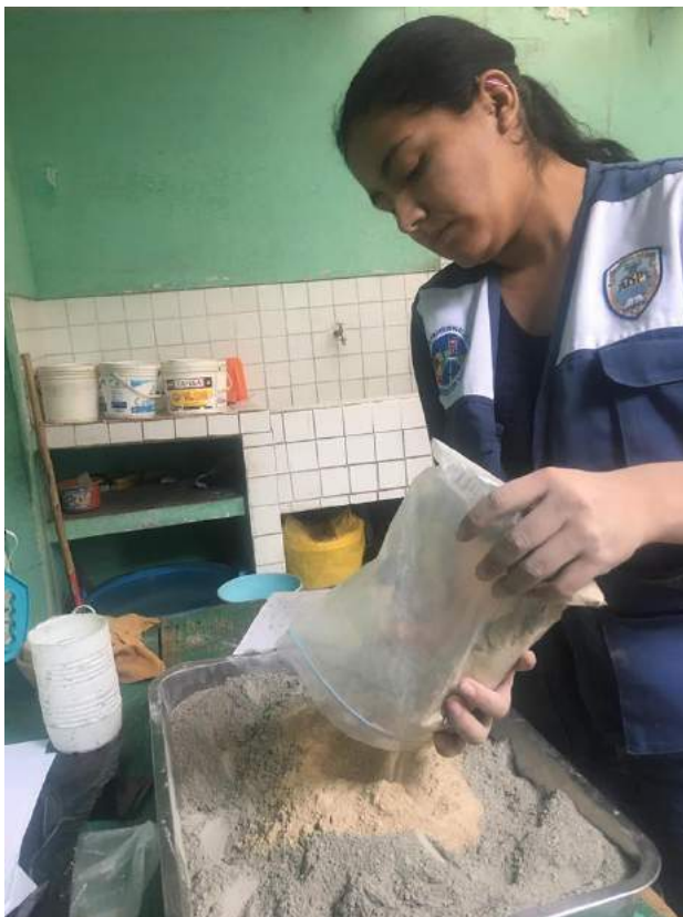
FIGURA N° 69: Colocando en un recipiente el cemento y el polvo de la roca zeolita Fuente: Propia
