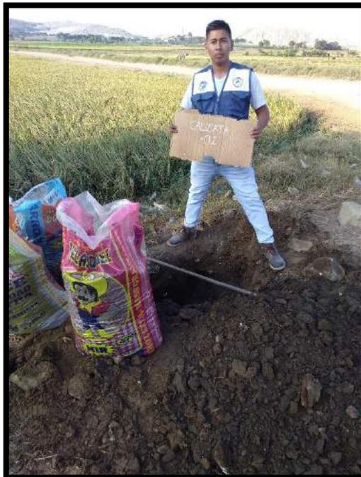
**FIGURA N°2:** Extracción de mezcla de suelo de la calicata N°02 de la Vía cascajal km15 a km 16.
