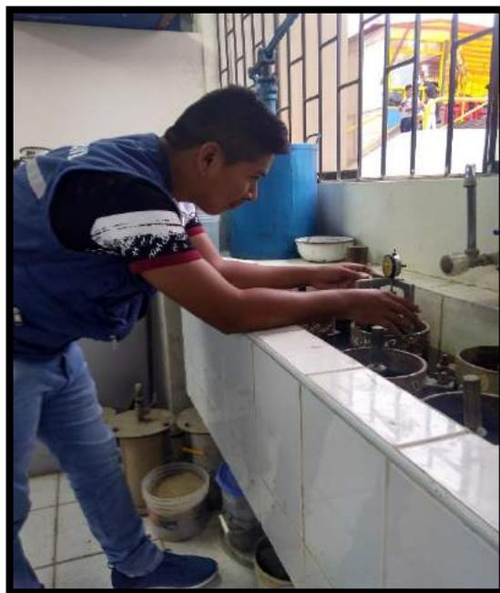
*FIGURA N°10:* Saturación de los moldes de CBR.
