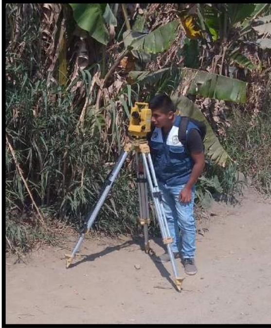
*FIGURA N°7:* Levantamiento Topográfico con Teodolito.
