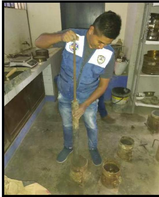
*FIGURA N°9:* Compactación de los moldes de Proctor Modificado.
