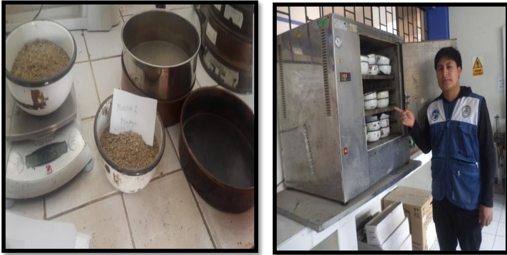
Figuras N° 26: hallando la Absorción y contenido de humedad de los agregados fino y grueso según Norma ASTM C-556 / NTP 339.185.
