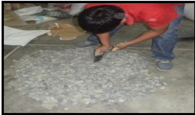
Figuras N° 25: Determinando la granulometría de los agregados finos y gruesos según la norma ASTM C 136; NPT 400.012.
