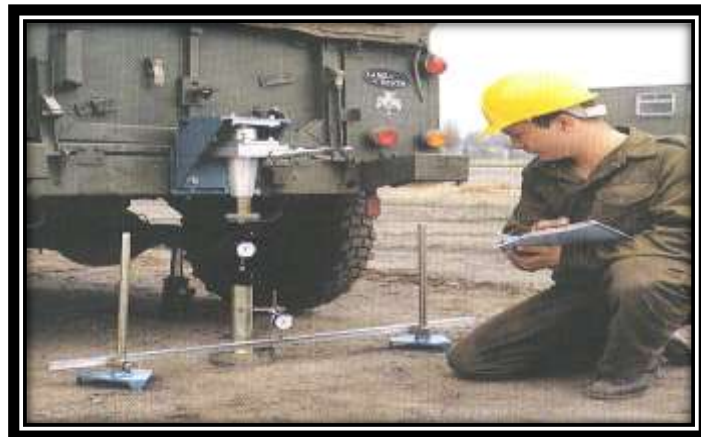
Figura 3. Ensayo in situ CBR (Jose Copado Beltrán, 2011)
