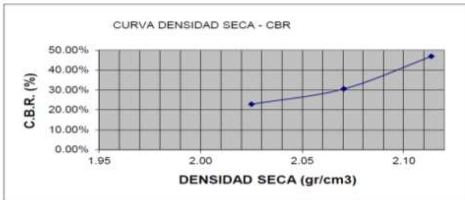
Figura 13: Curva Densidad Seca-CBR Fuente: Datos del Laboratorio (UPS)
