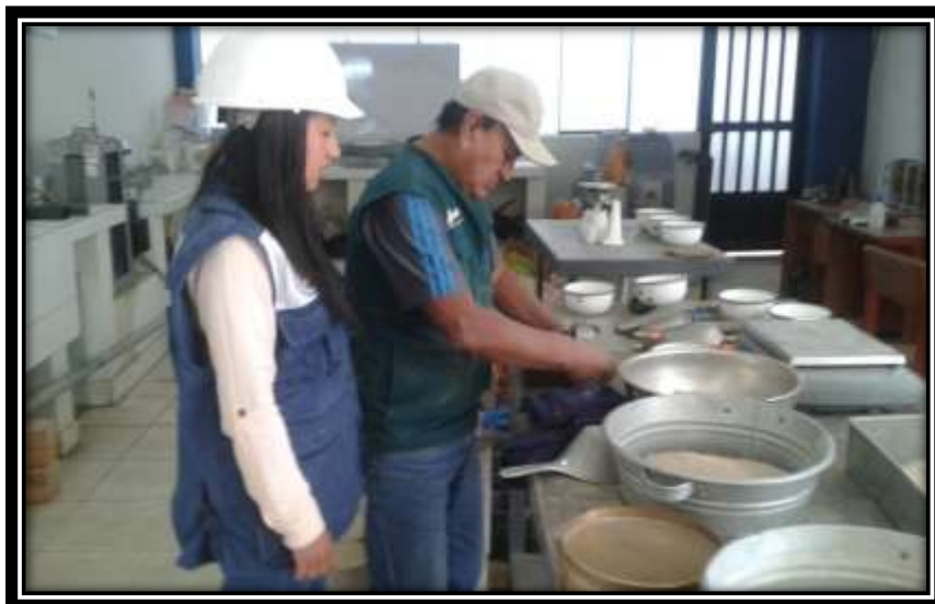
Foto 9: 25 golpes para determinar el límite de plasticidad.
