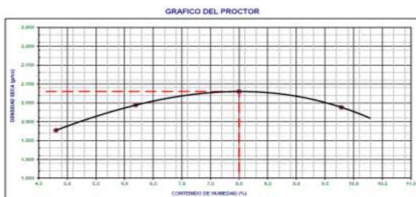
Figura 11. Proctor Estándar con adición del CBCA Fuente: Datos del Laboratorio (UPS)
