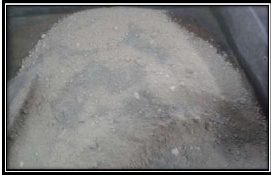
Foto 16: Adicionando al suelo natural porcentajes de cemento.
