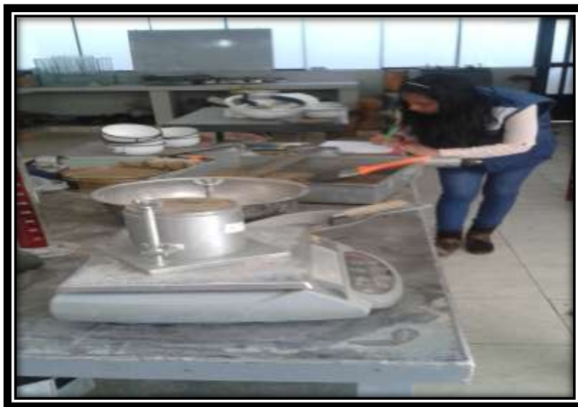
Foto 13: peso del molde + muestra
