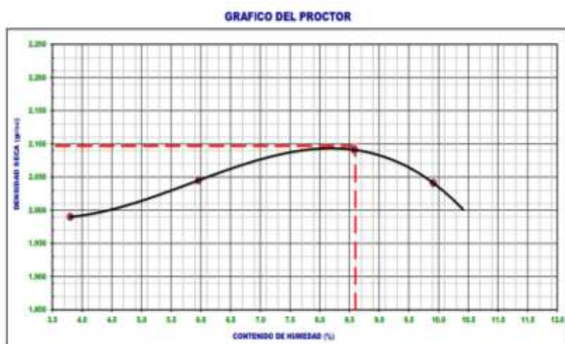
Figura 5. Proctor Standard del Suelo Natural Fuente: Datos del laboratorio (USP)
