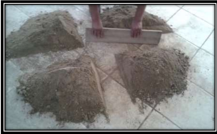
Foto 6: Cuarteo de la muestra para la granulometría.
