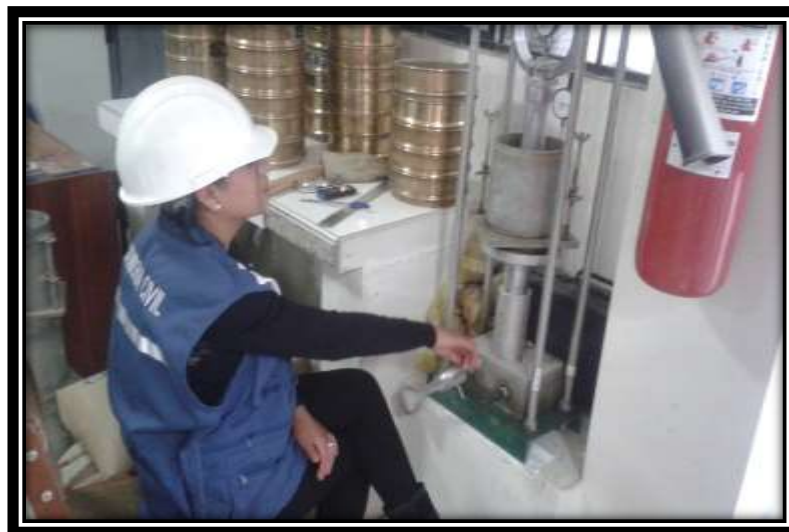
Foto 19: Ensayo de penetración.
