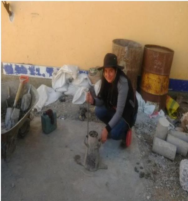
Figura 21: Determinación del Slump
