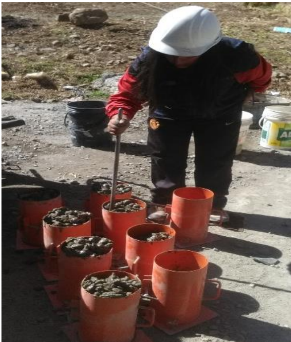
Figura 25: Preparación de probetas para 15 % de vacíos
