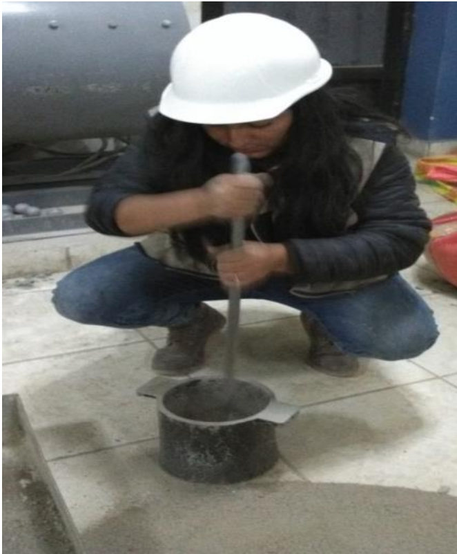
Figura 21: Determinación del Slump
