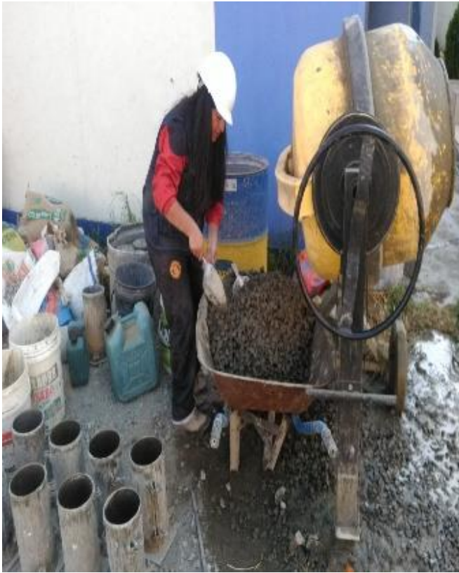
Figura 25: Preparación de probetas para 15 % de vacíos
