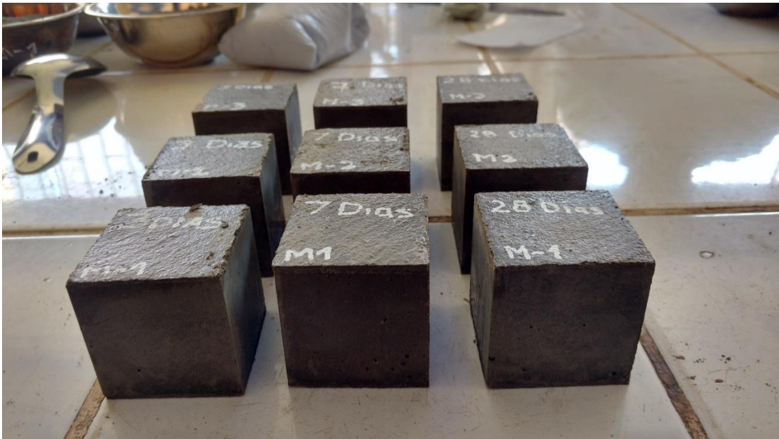
FOTOGRAFIA N° 19. DESENCOFRADO DE MUESTRAS
